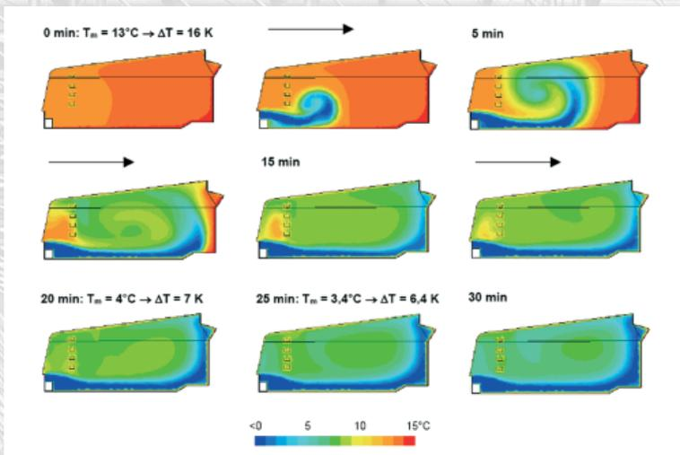
Energieforum Berlin, Simulationsuntersuchung der Belüftungssituation im Winter, Nachstellung der Versuchsdurchführung
