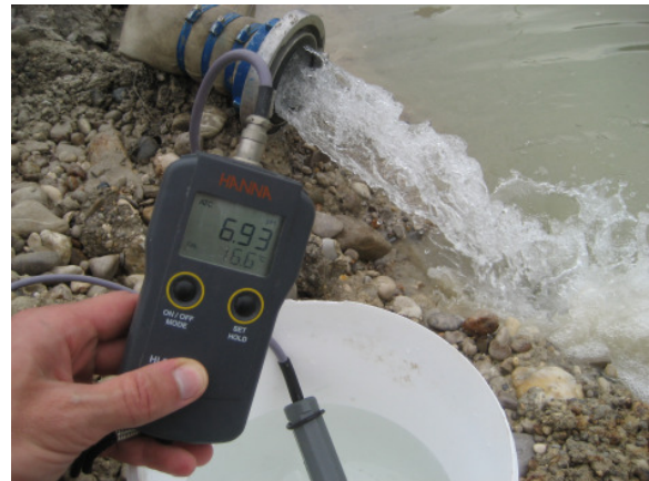
Abbildung D.56: Bestimmung des pH-Werts am geförderten Wasser
