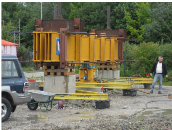
Abbildung D.49: Belastungseinrichtung und Messbrücken für Wegaufnehmer
