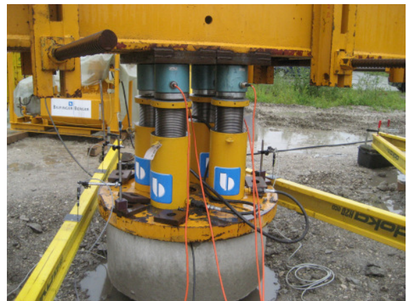
Abbildung D.50: Pressen und Messeinrichtungen am Druckpfahl
