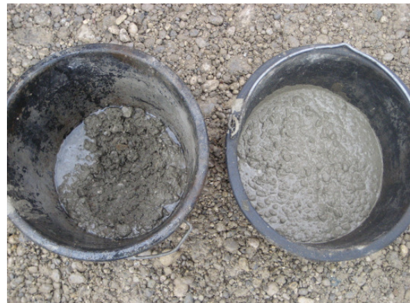
Abbildung D.40: Frischbeton vermischt mit PAA 6 g / l (links) und wie geliefert (rechts)
