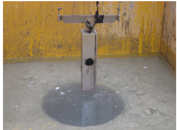
Abbildung D.30: Einfahren der Ultraschallsonde (KODEN-Messgerät)
