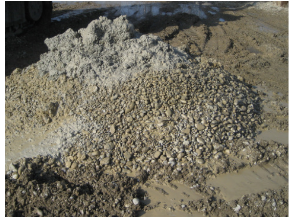
Abbildung D.28: Bohrgut (mit Rollkies)
