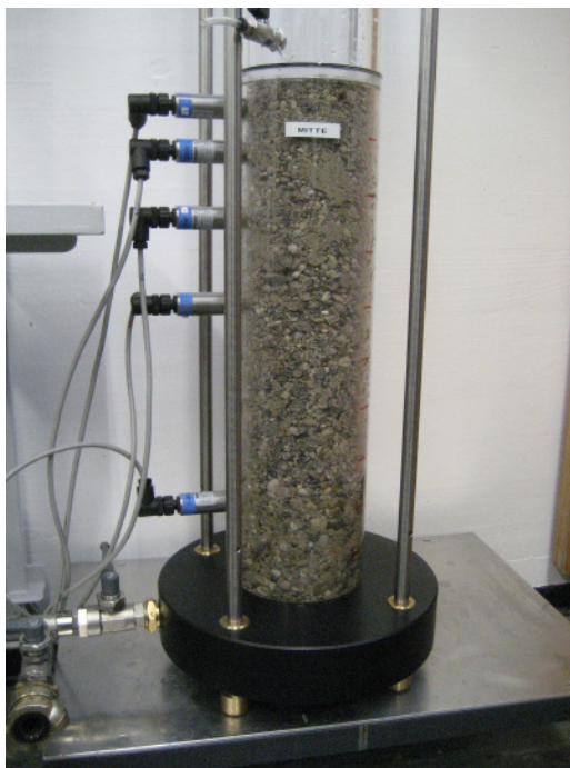
Abbildung D.3: 1D-Strömungsversuche mit Material aus Baugrunderkundung
