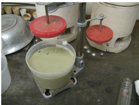
Abbildung D.45: Bestimmung der Fließgrenze der Bentonitsuspension mit Kugelharfe
