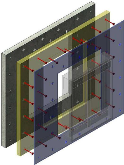
Innovative Klebe-Verbindungstechnik für filigrane Fassadenplatten aus Hochleistungsbeton
