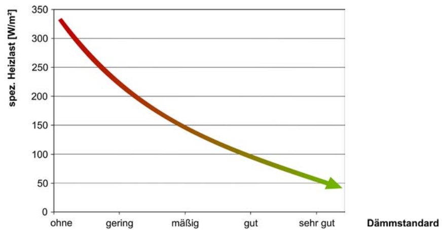
Abb. E56: Spezifische Heizleistung in Bezug auf die Qualität der wärmegeprägten Gebäudehülle für Gewerbebauten [1]
