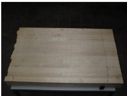
Bild 42 Fichtenholz-Probekörper (F262), Abmessungen L = 111\text{ cm} , R = 70\text{ cm} , T = 12\text{ cm}
