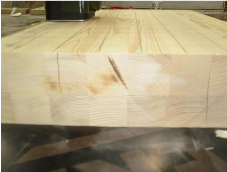
Bild 65 Risse in dem Probekörper Fichte235 parallel zur R-Richtung
