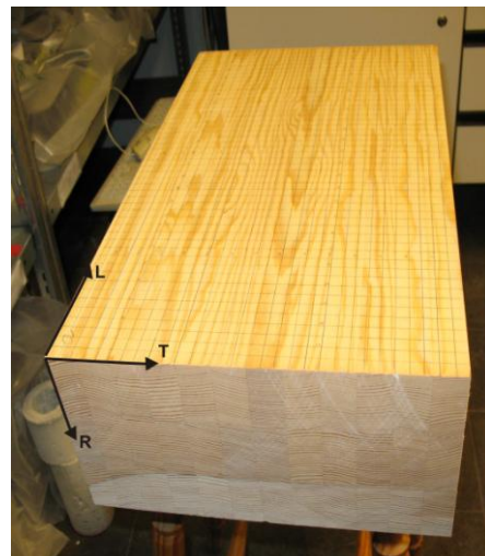
Bild 34 Großer Kiefernholz-Probekörper (x1124)
