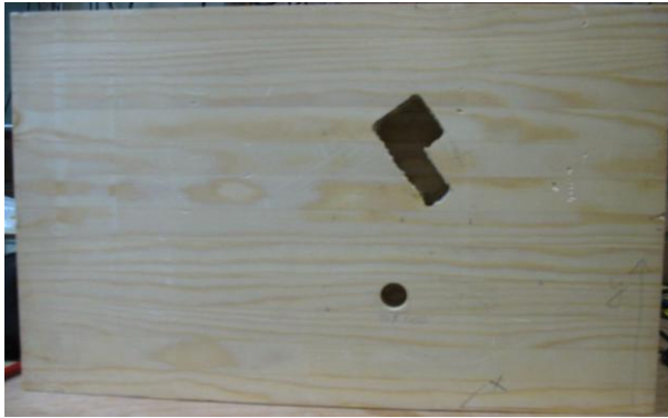
Bild 40 Kieferholzprobekörper x1124 mit eingefügten Fehlstellen auf der Rückseite
