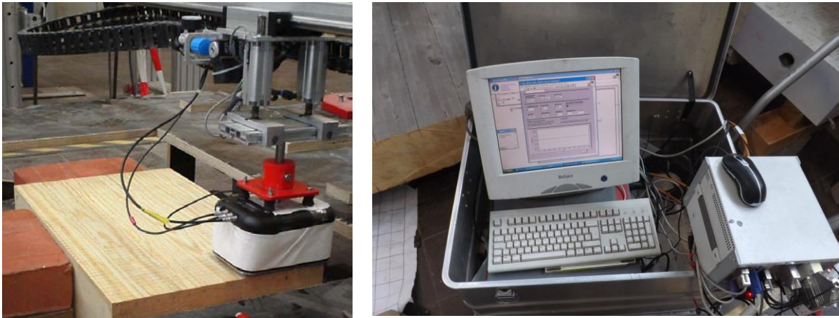
Bild 5 Das scannende System mit einem Transversalwellen-Prüfkopf. Rechts: PXI-System zur Steuerung der Scaneinheit
