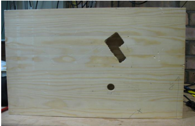
Bild 53 Großer Kiefernholz-Probekörper (Pk x1124) mit L-förmiger Fehlstelle (Rückseite)
