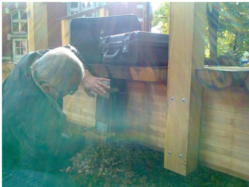
Bild 107 Fußgängerbrücke Fabeckstraße: Messung mit linearem Array an Messfeld Ost3
