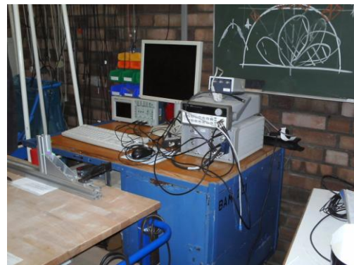
Bild 4 Laufzeitapparatur 2 für die Messung mit Einzelprüfköpfen
