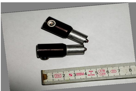
Bild 3 Einzelne Prüfköpfe für Longitudinalwellen bzw. Transversalwellen
