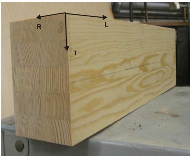
Bild 33 Kiefernholz-Probekörper (Kiefer Serie 2, K219.1-.8)
