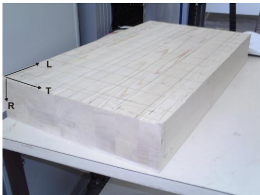
Bild 37 Fichtenholz-Probekörper (F235), Abmessungen L = 70 cm, T = 40 cm, R = 10 cm
