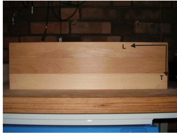
Bild 36 Buchenholz-Probekörper (Buche1), Seitenansicht
