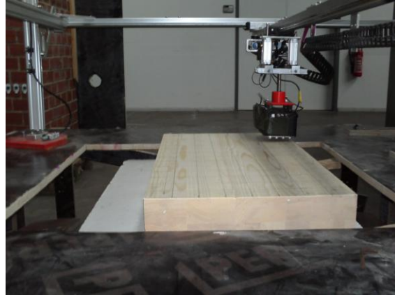
Bild 62 Scannende Messung des Probekörpers Fichte235, Echo in R-Richtung, Polarisation in T-Richtung (Prüfkopf 12+12+)
