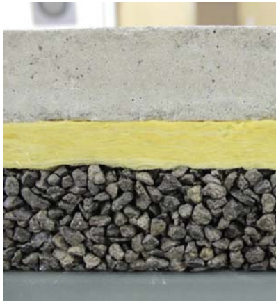
Bild 3: Beispiel für eine der untersuchten Schüttungen (seitliche Ansicht der Deckenauflage). Von oben nach unter: Zementestrich (Dicke 43 mm), Trittschall-Dämmplatte aus Glaswolle (Dicke 25 mm), Schüttung aus Basaltsplitt mit der Korngröße 5 - 8 mm (Dicke ca. 60 mm).
