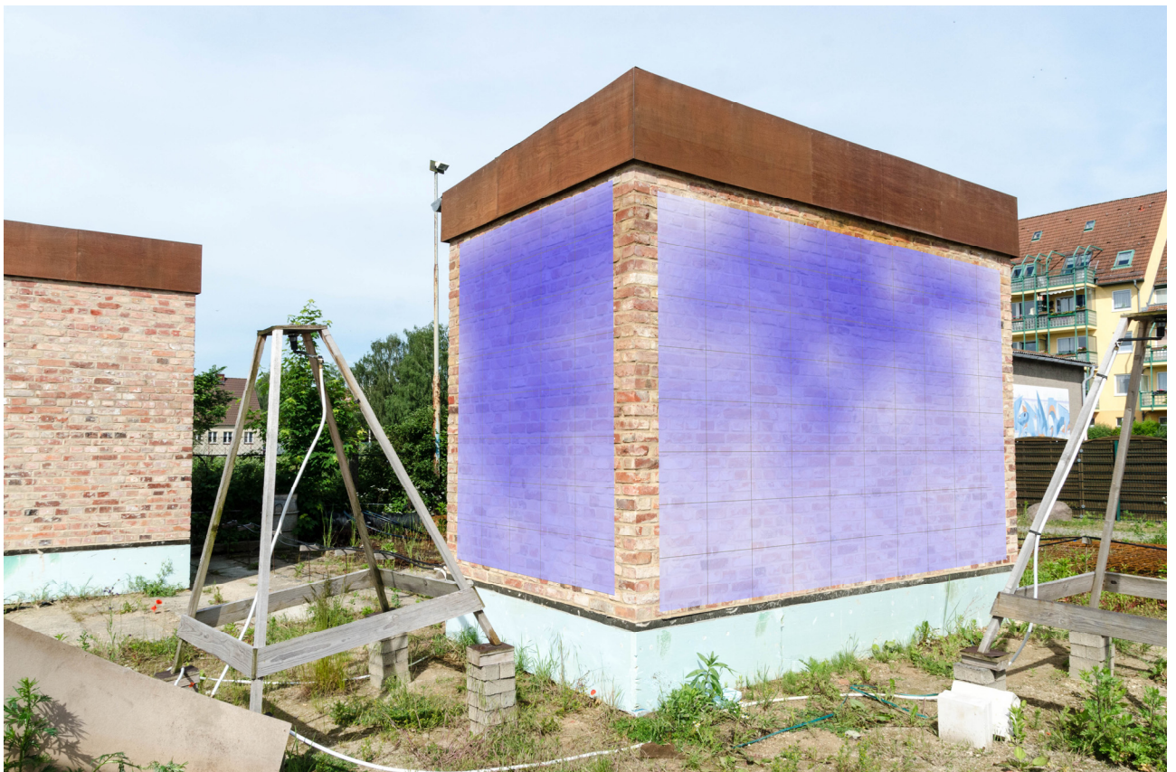
Versuchsgebäude 5 Ostseite, Mikrowellenmessung Messkopf PM 07.06.2017
