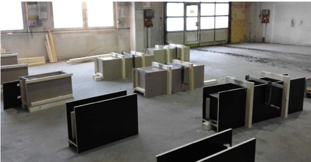
Betonierte Bauteile für Versuchsphase III und IV bei der Fa. Benno Drössler, Siegen
