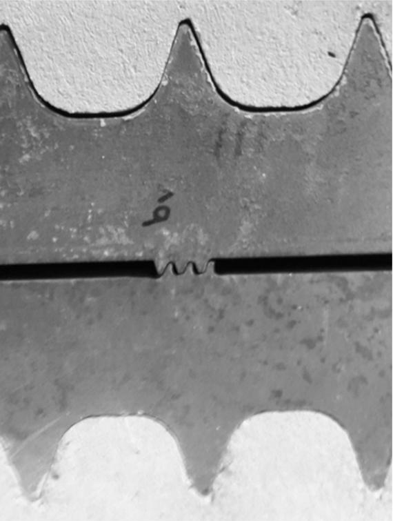
Verformte Zähne Rückseite
