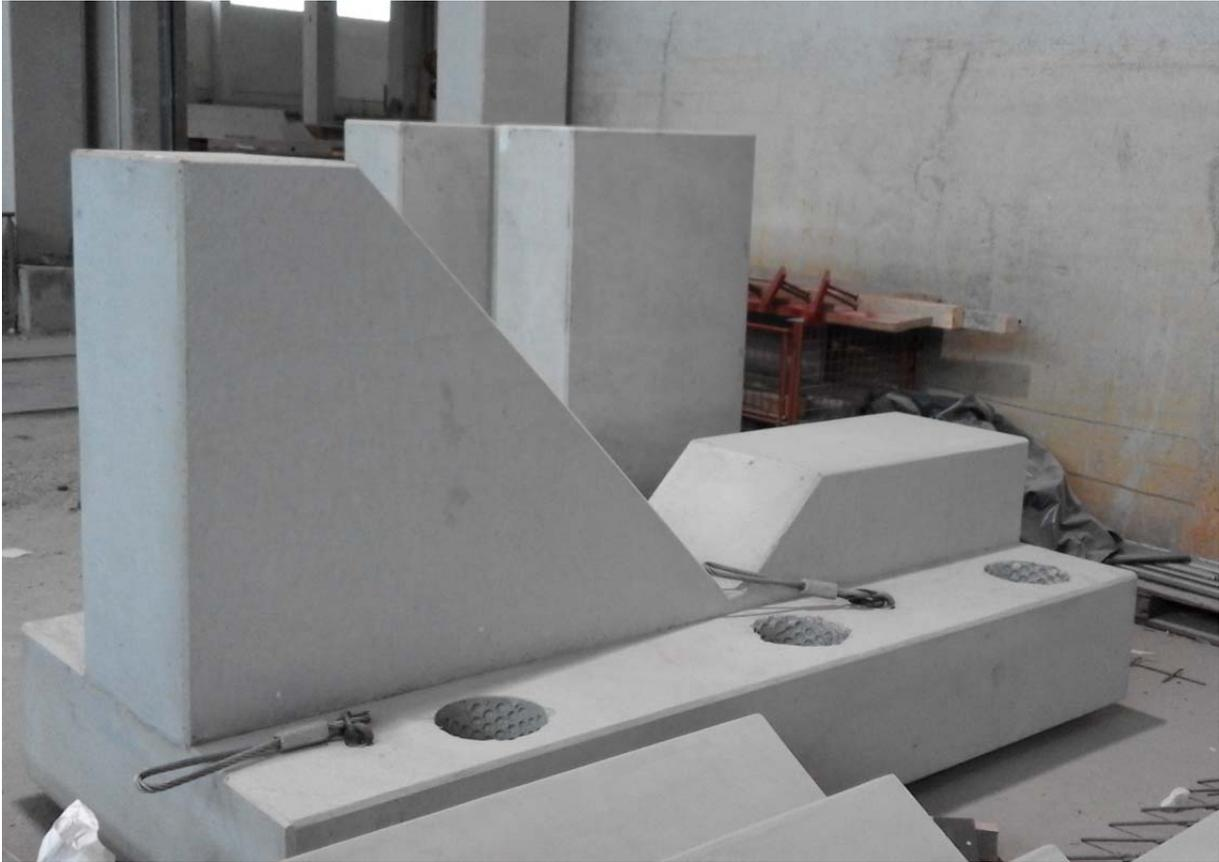
Widerlager im Fertigteilwerk der Fa. Angermüller in Untersiemau
