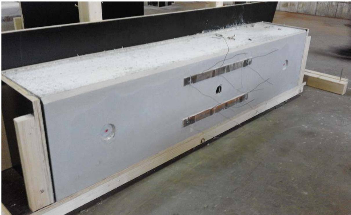
Ausgeschaltete Stütze für Versuchsphase III
