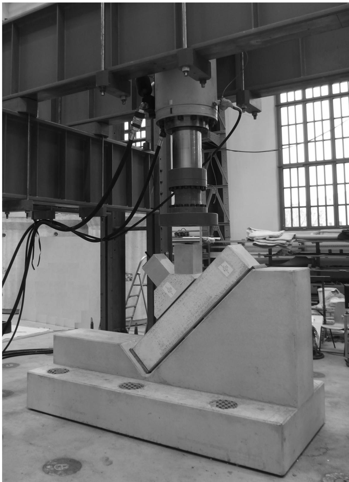
*Abb.VB4.1: Versuchsaufbau Knotenpunkt*
