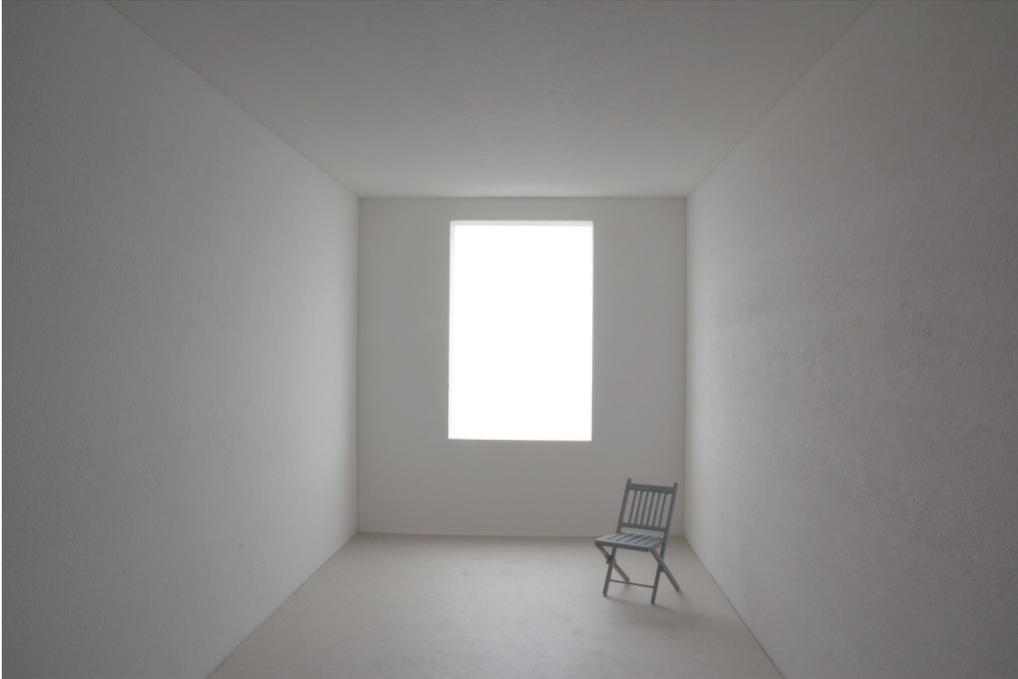
„Base Case“ mit einem Fensterflächenanteil nach „Daylight Factor“ von  $2,6\text{m}^2$  und einer Laibungstiefe von 40cm
