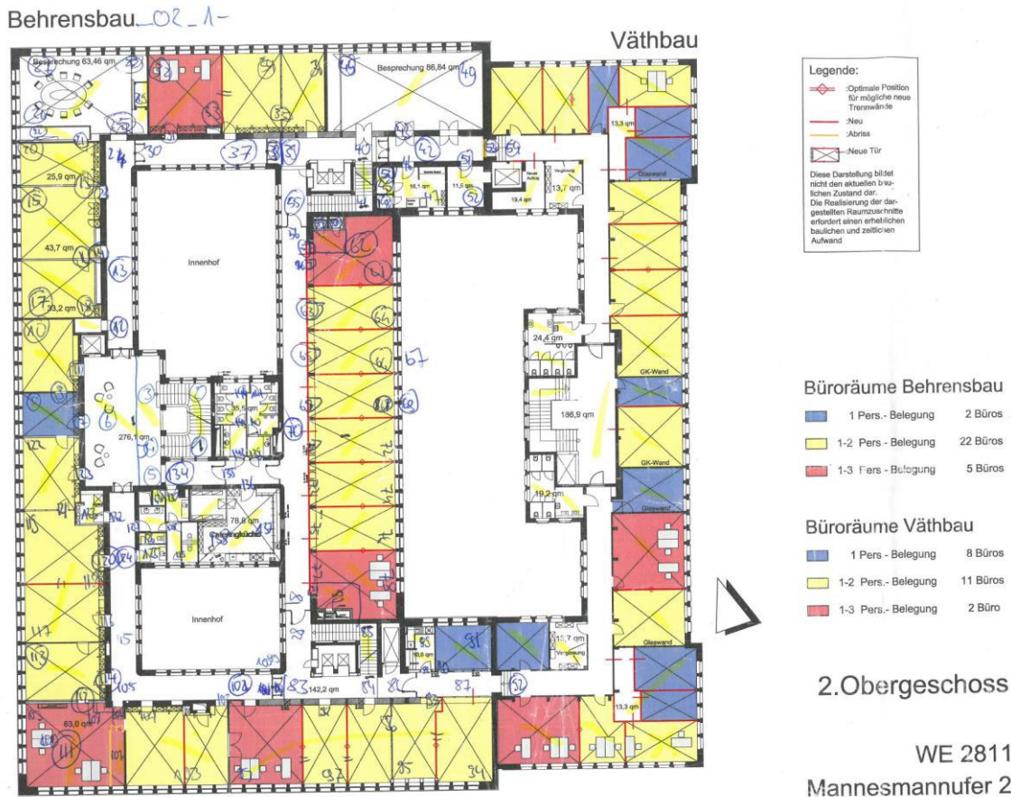
Abb. 9: Grundrissplan mit vermerkten Scannerpositionen und -nummern 53
