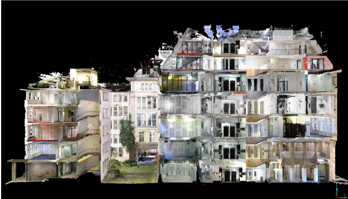
Abb. 24: Erstellung eines Schnitts mithilfe der Clipping Box 70
