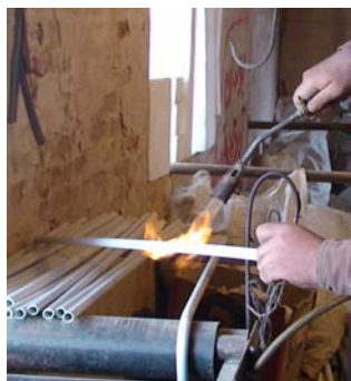
خم کاری لوله‌ها با استفاده از فنر و شابلن خم
