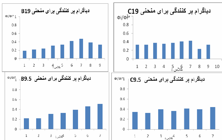
شکل ۲- نمودار پرکنندگی برای منحنی دانه بندی B, C با حداکثر اندازه سنگدانه ۹,۵ و ۱۹ میلی‌متر
