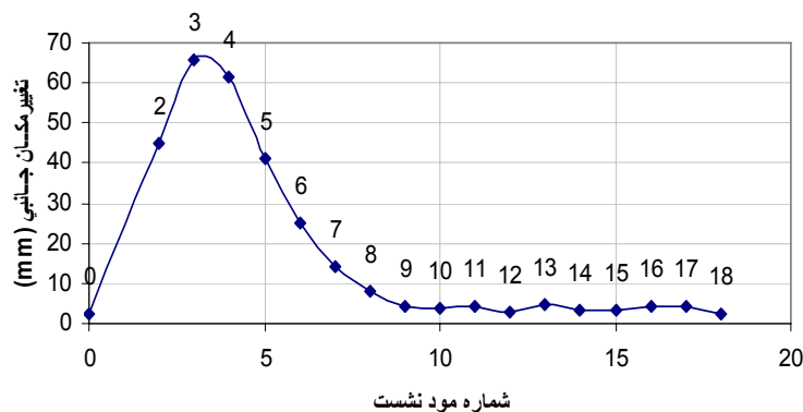
شکل ۱۱- ماکزیمم تغییر مکان جانبی بوجود آمده در پوسته
