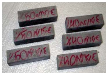
شکل ۲- نمونه‌های منشوری برای تعیین مقاومت فشاری ملات سیمان
