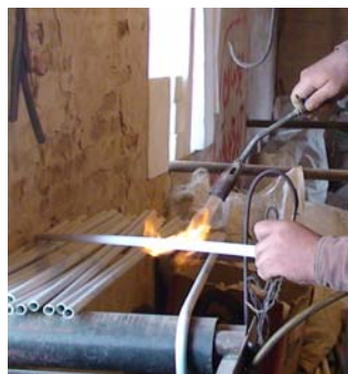
خم کاری لوله‌ها با استفاده از فنر و شابلن خم
