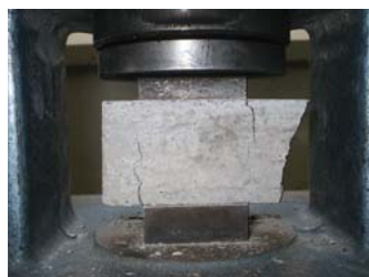
شکل ۲- نمونه‌های منشوری برای تعیین مقاومت فشاری ملات سیمان
