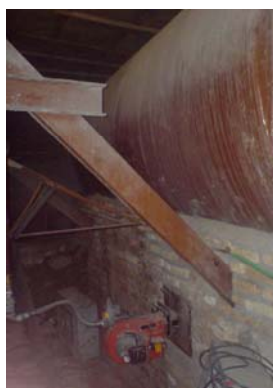
مشعل گرمایشی جهت حرارت به قسمت پایین تانکر آب بچینگ
