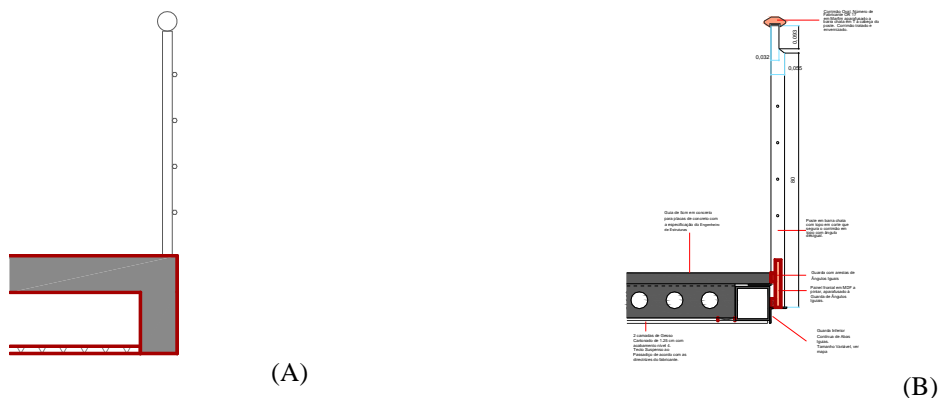
Figura 2: Nível de detalhamento de laje/ corrimão: (A) representação em 3D e (B) em 2D
