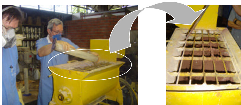
Figure 1 Horizontal axis mixer (Souza Filho, 2005).
