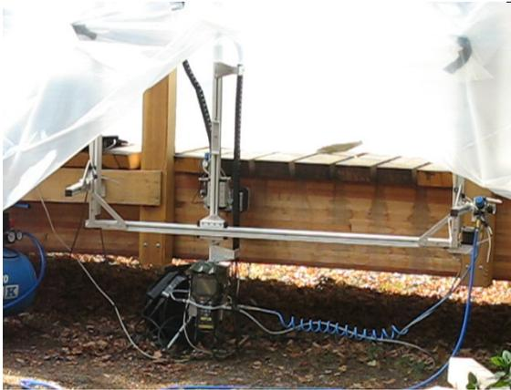
**Bild 9** Automatisiertes scannendes System mit einem kommerziell erhältlichen A1220-Interface
