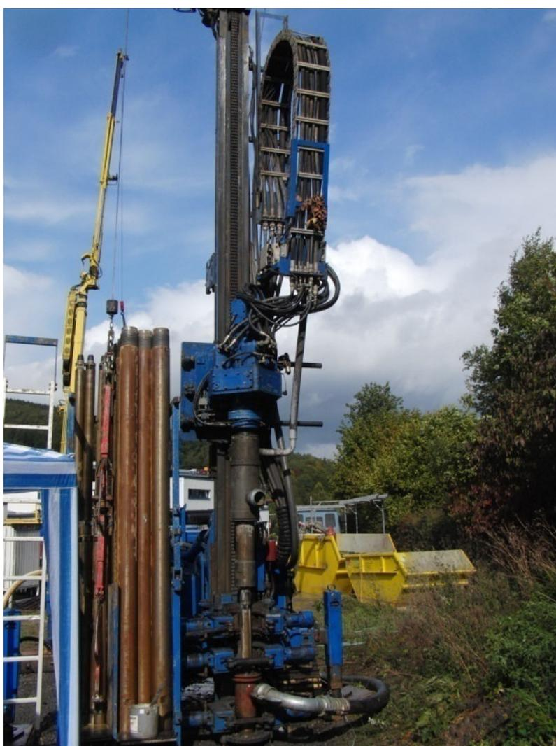
Abbildung 7.14: Bohrgerät mit angebautem Gestängemagazin
