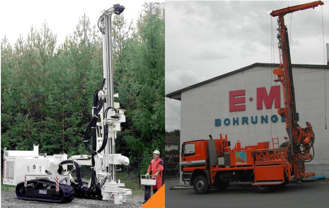
Abbildung 2.2: Hydraulische Bohrgeräte, links [21] und rechts [24]
