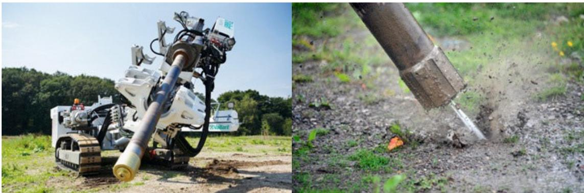
Abbildung 2.8: Links: Geojetting Bohrgerät; Rechts: Bohrung mit Wasserdruck [27]
