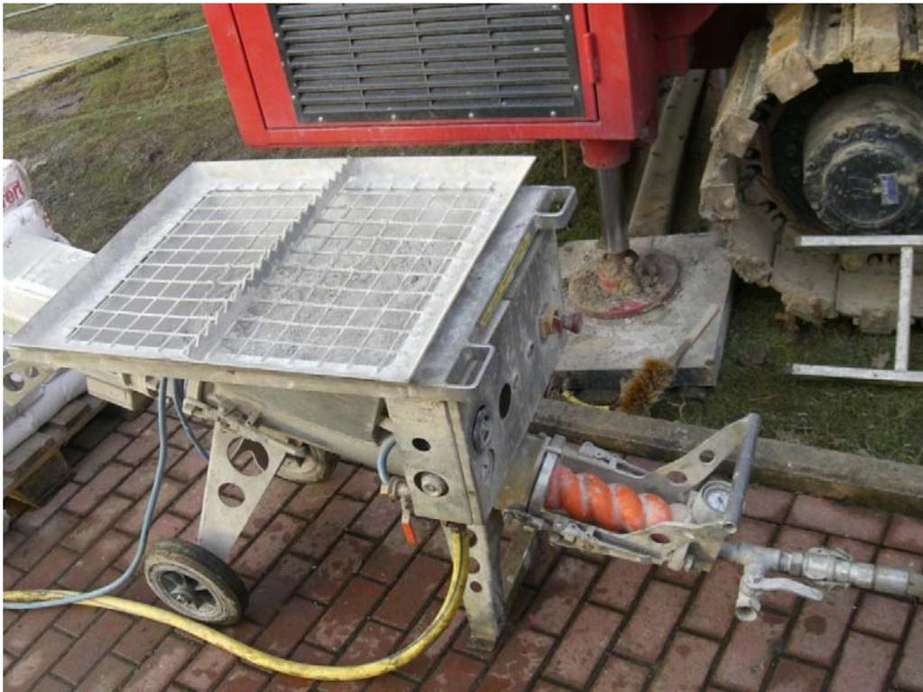
**Abbildung 7.19: Durchlaufmischer für die Herstellung der Verfüllsuspension**
