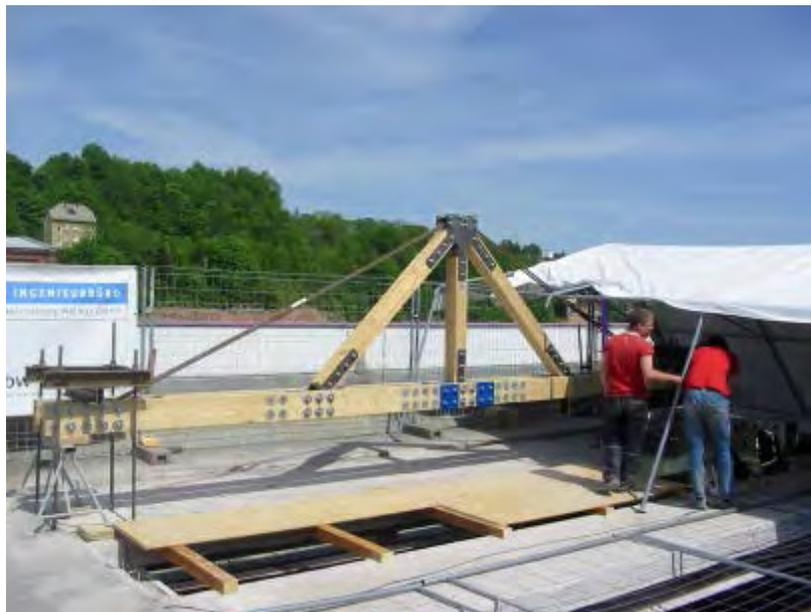
**Abb. 5.7.:** Aufbau des Belastungsrahmens über der zu untersuchenden Spannbetonhohlplatte
