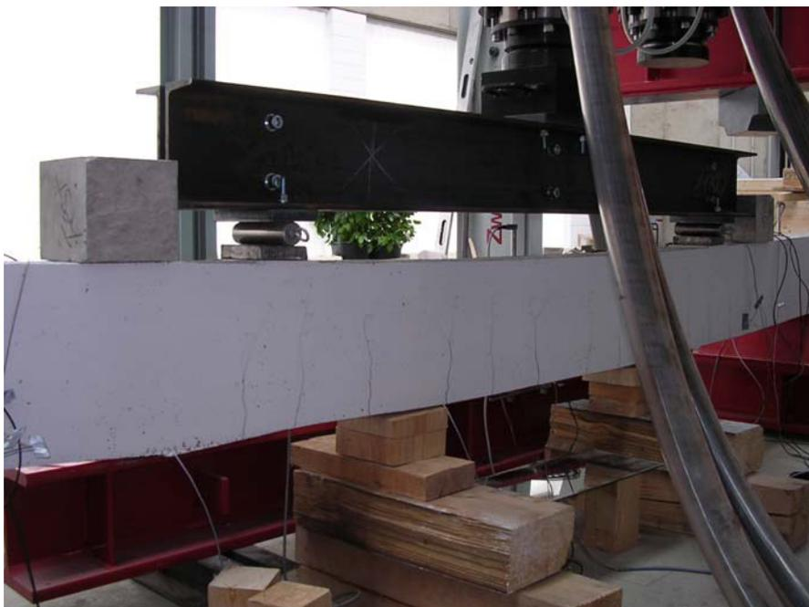
Abb. 9.7: Rissbild des Balkens 1 unter Maximalbelastung
