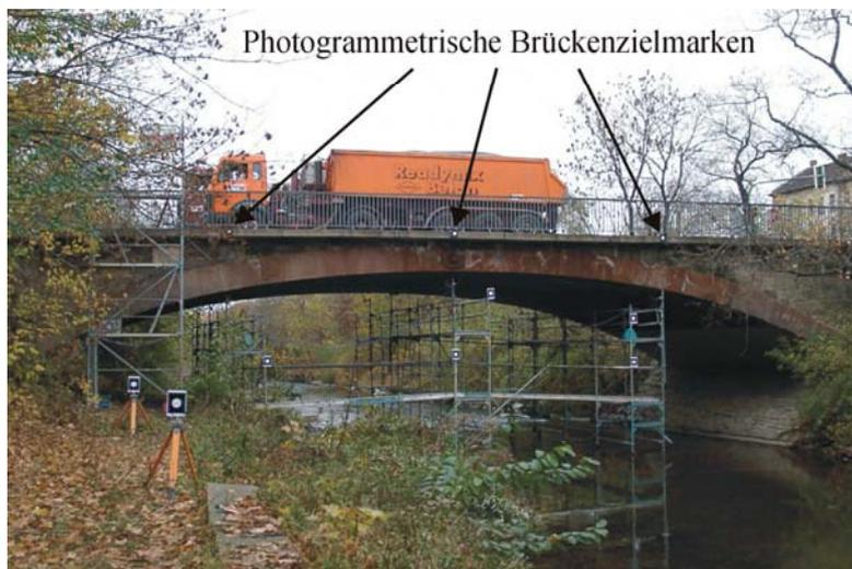
Abb. 6.3: Brücken-Deformationsmessung [2]
