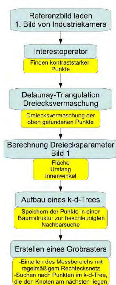
**Abb. 3.8.:** Flussdiagramm mit dem 1. Teil des Algorithmus
