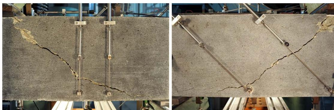
Abb. 7.15: Bruchbilder Versuch B1F1
