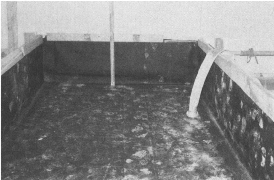
Abb. 3.6: Belastung von Decken mit Wasserlasten [8]
