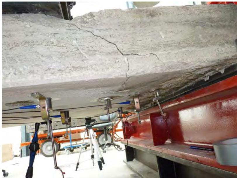
Abb. 4.16.: Bruch der Platte durch Ausbildung eines schrägen Risses
