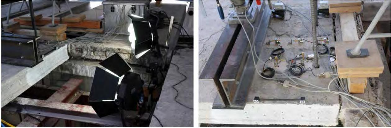
**Abb. 5.4.:** Darstellung der photogrammetrischen (links) und herkömmlichen Messtechnik (rechts)
