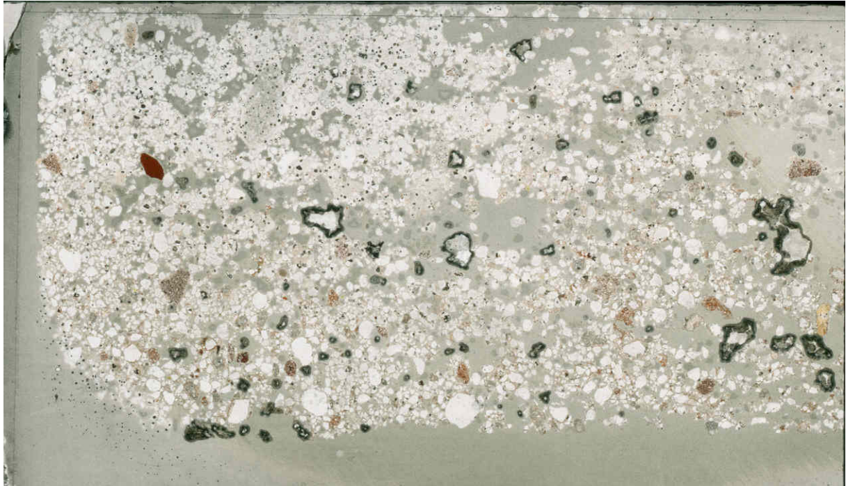
Bild M-L18: Scan des Dünnschliffs der Probe aus Serie 83 (Bildbreite 4,0 cm)
