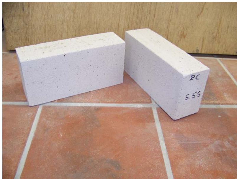
Bild 45: Prüfkörper der Serie 55 - Zugabe von 50 M.-% Beton-Recycling-Material der feinen Fraktion 0/2 mm
