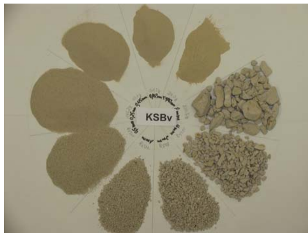
Bild 16: Fraktionen des Kalksandstein-Recycling-Materials - mit Verunreinigungen (KSBv)
