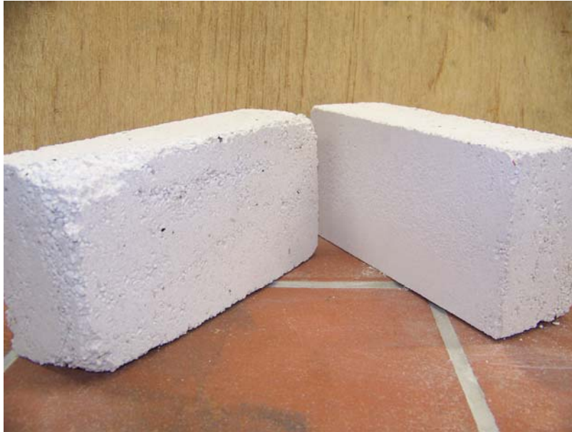
Bild 33: Prüfkörper der Serie 15: - Zugabe von 50 M.-% sortenreinem Kalksandstein-Recycling-Material der groben Fraktion 2/4 mm - Reduzierung des Pressdrucks - deutlicher Aufraueffekt
