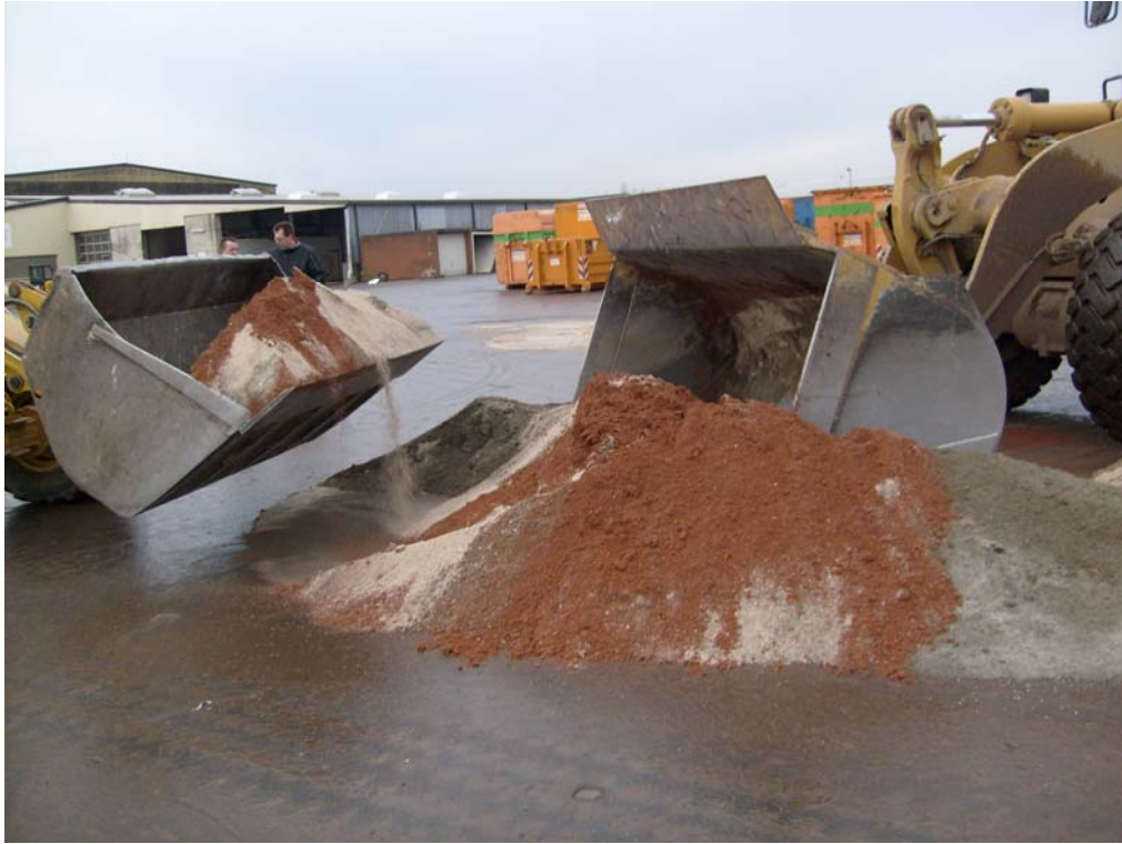
Bild N9: Vermischung der 3 Mauerwerk-Recycling-Splitte, Brockmann Recycling GmbH, Nützen, Foto: TerraTextura GmbH, Soest
