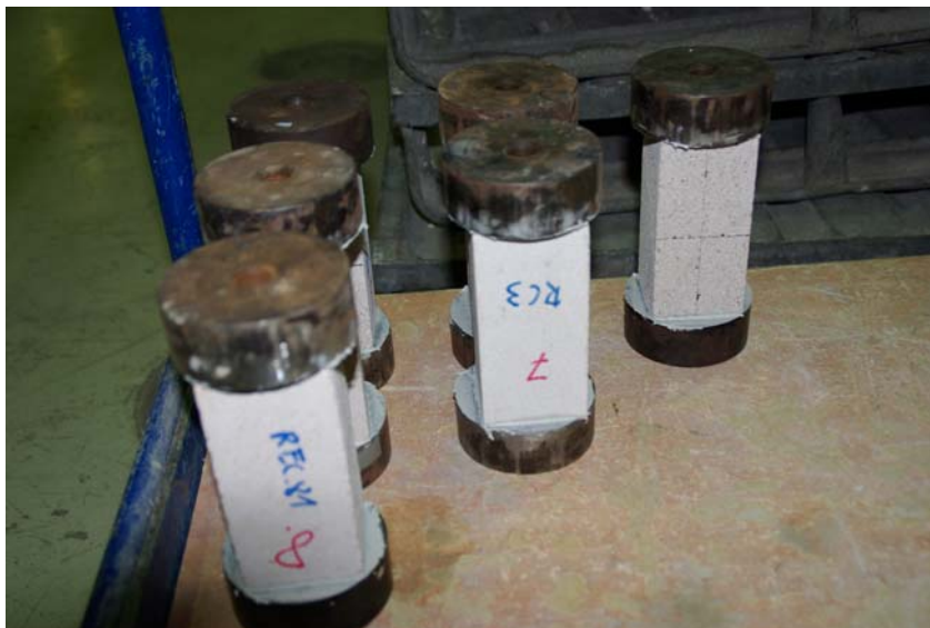
Bild 3: Proben mit geklebter Lasteinleitung zur Zugfestigkeitsprüfung
