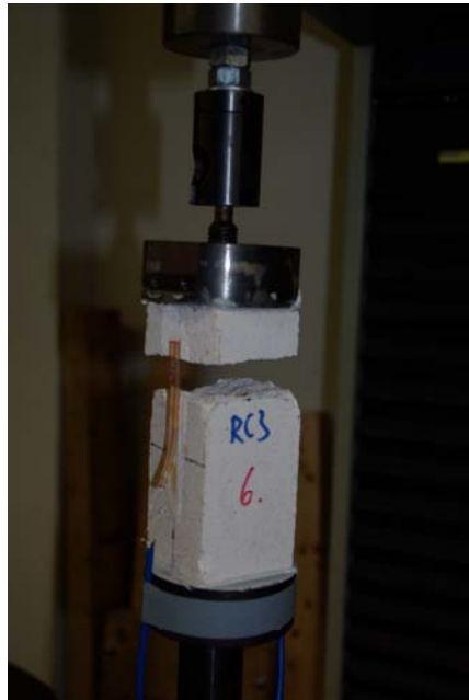
Bild 5: Prüfung des Zugelastizitätsmoduls
