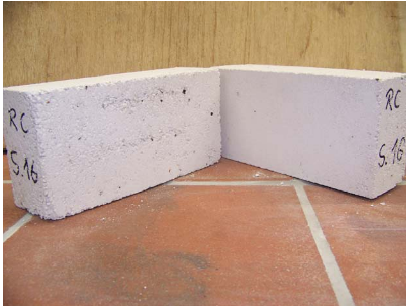
Bild 34: Prüfkörper der Serie 16: - Zugabe von 50 M.-% sortenreinem Kalksandstein-Recycling-Material der groben Fraktion 2/4 mm - Aufraueffekt
