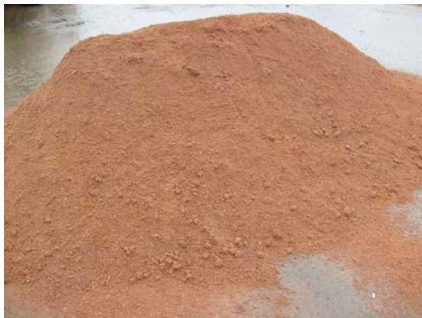
Bild N7: Ziegel-Bruchmaterial 0/5 mm, Brockmann Recycling GmbH, Nützen, Foto: TerraTextura GmbH, Soest
