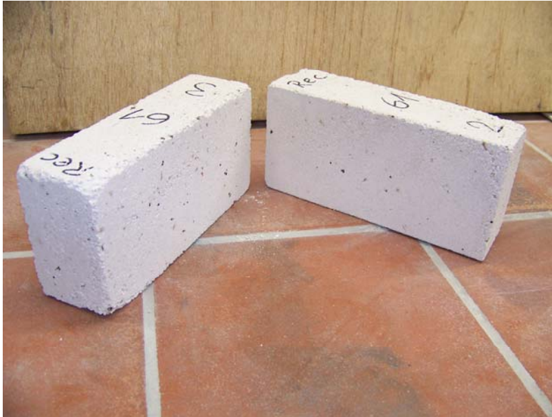
Bild 46: Prüfkörper der Serie 61 - Zugabe von 50 M.-% Beton-Recycling-Material der groben Fraktion 2/4 mm
