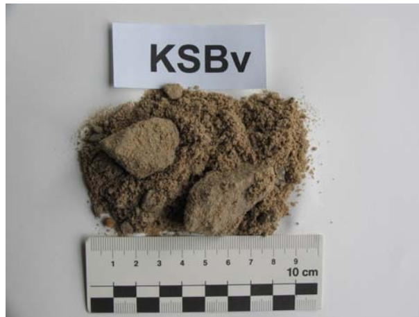
Bild 14: Kalksandstein-Recycling-Material - mit Verunreinigungen (KSBv)
