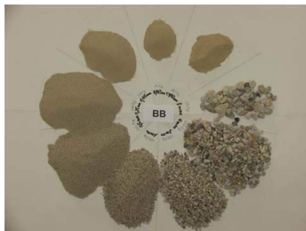
Bild 25: Fraktionen des Beton-Recycling-Materials (BB)
