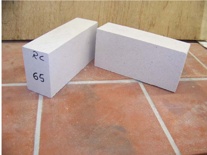
Bild 48: Prüfkörper der Serie 65 - Zugabe von 50 M.-% Naturstein-Recycling-Material der feinen Fraktion 0/2 mm
