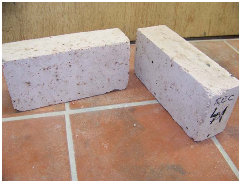
Bild 42: Prüfkörper der Serie 41 - Zugabe von 50 M.-% Ziegel-Recycling-Material der groben Fraktion 2/4 mm - Pressdruck \sigma_p = 15 \text{ N/mm}^2 - starke lokale Verfärbungen
