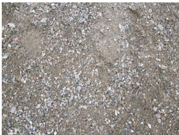
Bild N8: Beton-Bruchmaterial 0/5 mm, Brockmann Recycling GmbH, Nützen, Foto: TerraTextura GmbH, Soest
