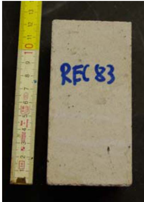
Bild 2: Probekörper l \times b \times h = 120 \times 55 \times 5 \text{ mm}^3
