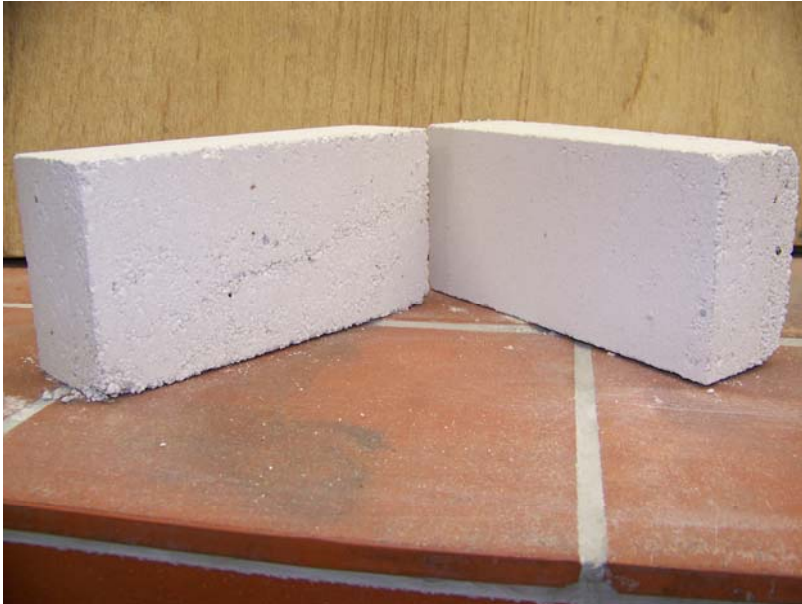
Bild 38: Prüfkörper der Serie 30: - Zugabe von 50 M.-% verunreinigtem Kalksandstein-Recycling-Material der groben Fraktion 2/4 mm - Aufraueffekt
