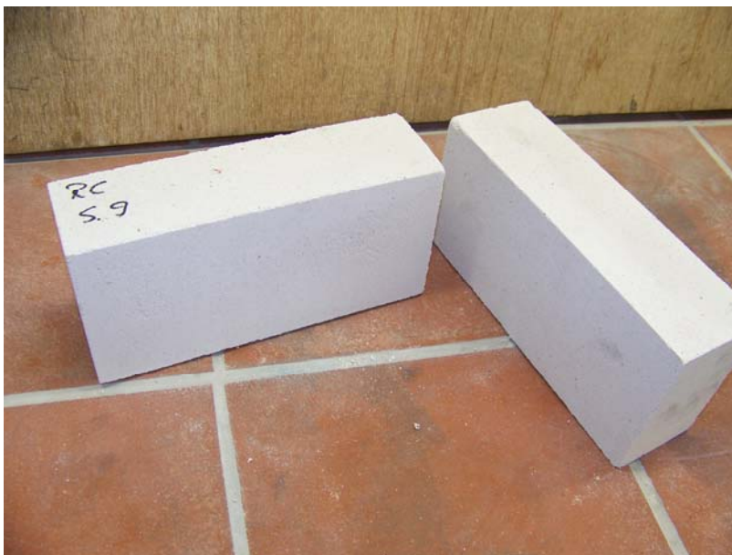
Bild 32: Prüfkörper der Serie 9 - Zugabe von 50 M.-% Kalksandstein-Recycling-Material der feinen Fraktion 0/2 mm
