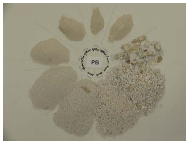
Bild 19: Fraktionen des Porenbeton-Recycling-Materials (PB)
