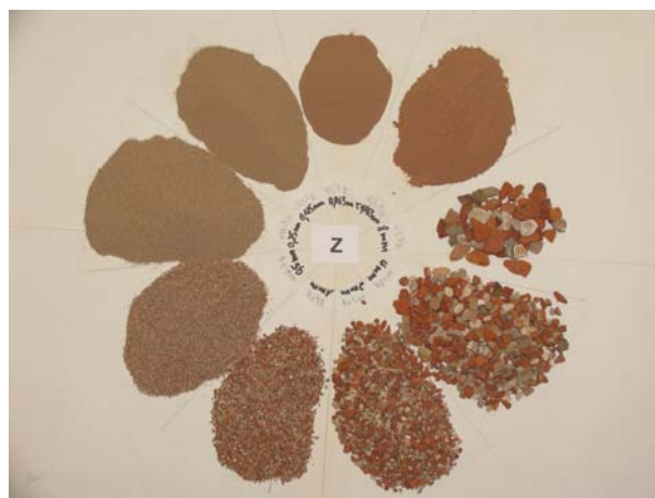
Bild 22: Fraktionen des Ziegel-Recycling-Materials (Z)
