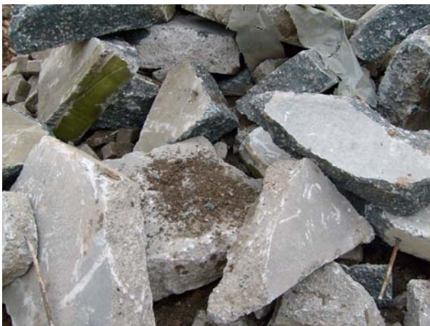
Bild N3: Beton-Ausgangsmaterial, Brockmann Recycling GmbH, Nützen, Foto: TerraTextura GmbH, Soest
