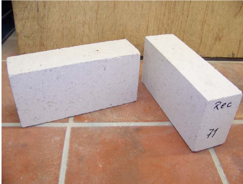
Bild 49: Prüfkörper der Serie 71 - Zugabe von 50 M.-% Naturstein-Recycling-Material der groben Fraktion 2/4 mm
