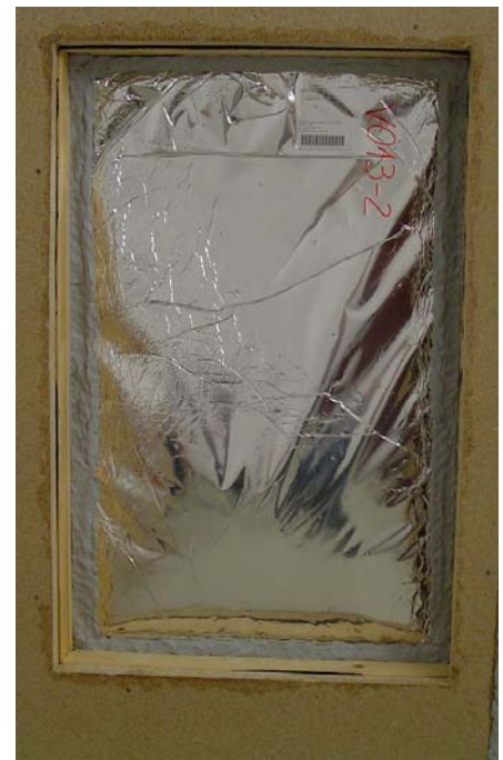
Bild 26: Paneel V011-2 (links) und V013-2 (rechts) in der Prüfmaske des Türenprüfstands: beide belüftet
