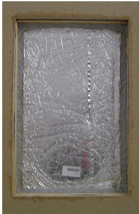
Bild 25: Paneel V011-1 in der Prüfmaske des Türenprüfstands: links: original; rechts: belüftet
