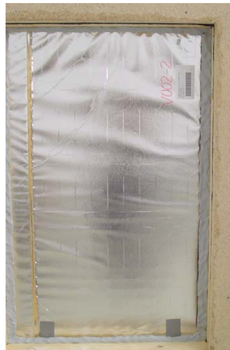
Bild 16: Panel V002-2 in der Prüfmaske des Türenprüfstands: links: original; rechts: belüftet
