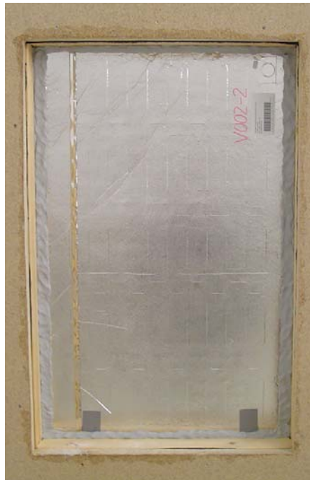
Bild 16: Panel V002-2 in der Prüfmaske des Türenprüfstands: links: original; rechts: belüftet
