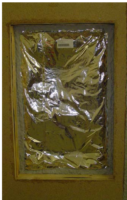
Bild 26: Paneel V011-2 (links) und V013-2 (rechts) in der Prüfmaske des Türenprüfstands: beide belüftet
