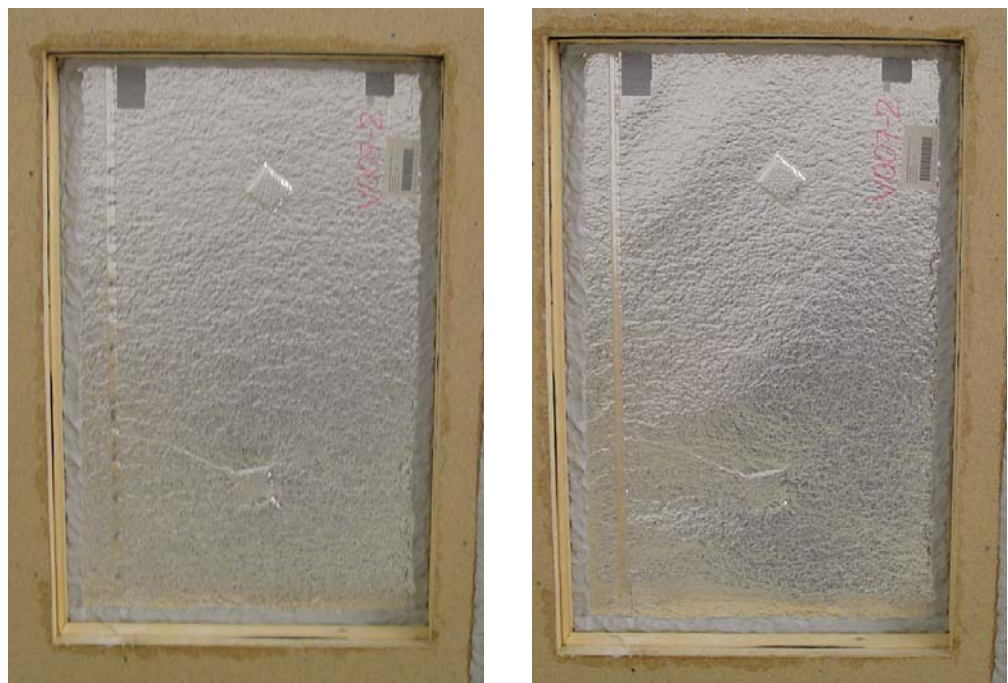
Bild 22: Paneel V007-2 in der Prüfmaske des Türenprüfstands: links: original; rechts: belüftet
