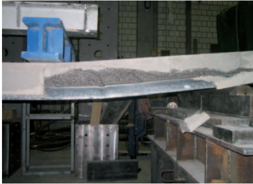
Abbildung 2: Kombiniertes Längsschub-Querkraft Versagen der Leichtbeton-Versuchskörper
