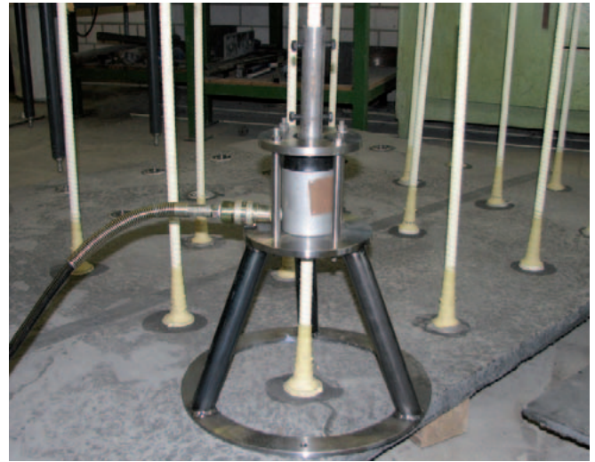
Abbildung 4: Reihenversuche an geklebten GFK-Verbindungsankern [Foto: TU Kaiserslautern]
