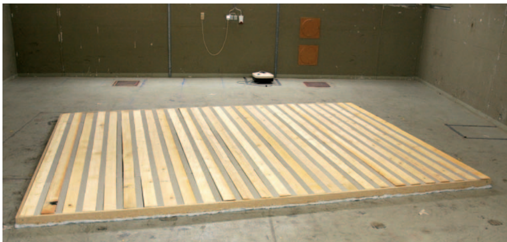
Abbildung 1: Messung eines periodischen Schallabsorbers im Hallraum
