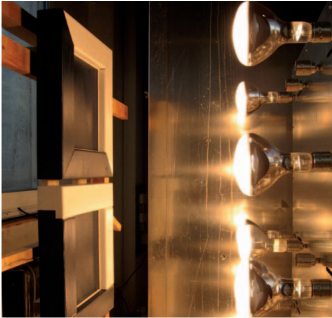
Abbildung 3: Künstliche Bewitterung von Rahmenverbindungsvarianten
