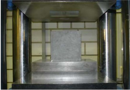
Abbildung 1.12: Prüfung der Druckfestigkeit vom hochfesten Beton
