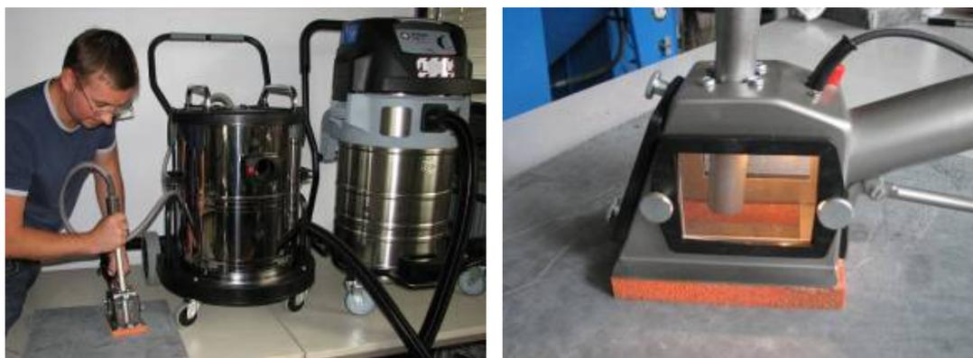
Abbildung 4.31: Mobile Vakuum-Saugstrahlanlage
