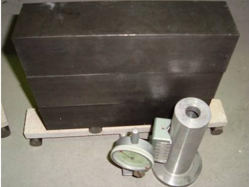
Abbildung 5.32: Dauernder Biegeversuchstand für Glasfaserbeton
