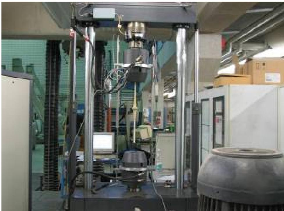
Abbildung 4.15: Zugprüfvorrichtung (250 kN)
