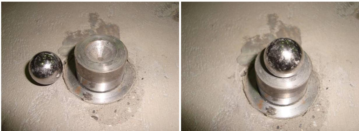
Abbildung 5.75: Kugelgelenk mit einem Durchmesser von 20 mm
