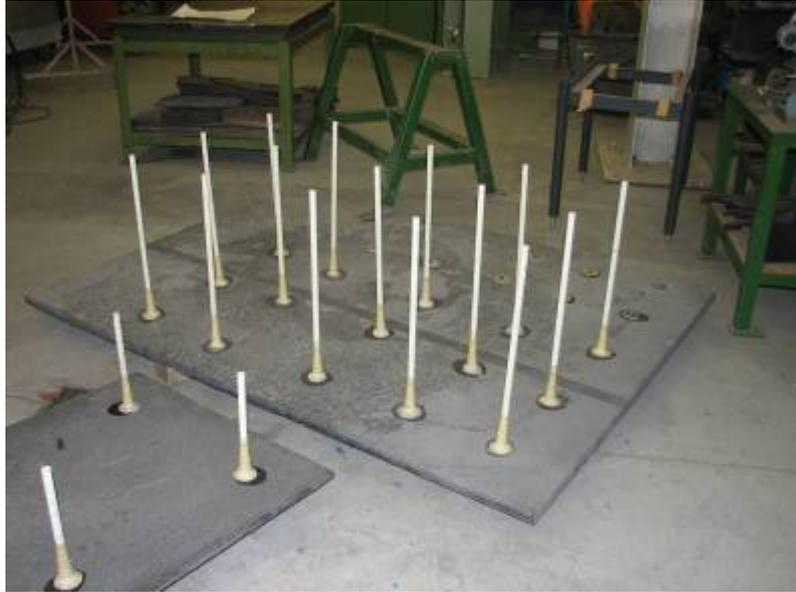
Abbildung 4.17: Geklebte GfK-Anker auf der Betonplatte
