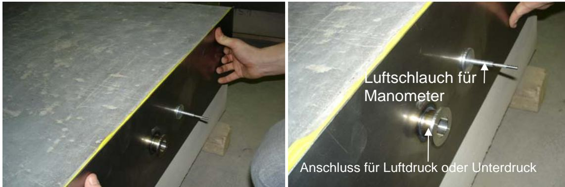
Abbildung 5.6: Stahlbleche am Fassadensystem befestigen
