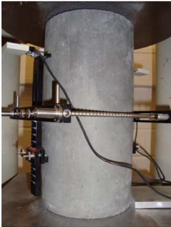
Abbildung 1.15: Prüfung des E-Moduls vom hochfesten Beton
