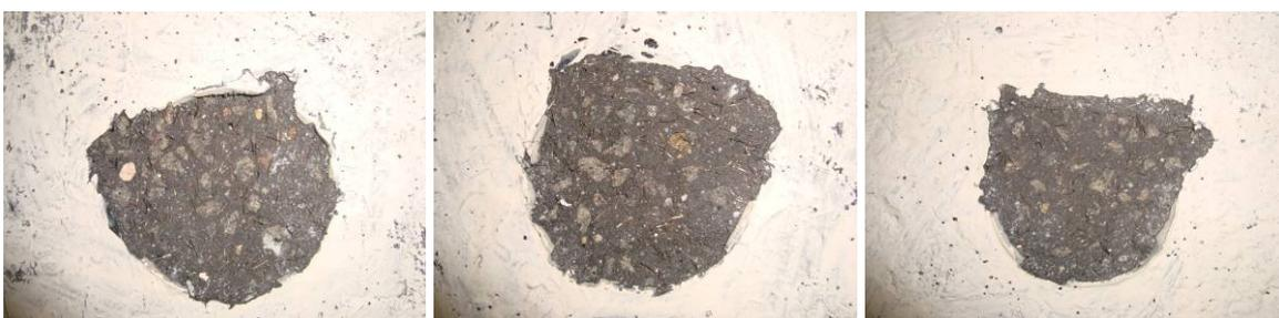
Abbildung 5.44: Versagen des Versuchs mit der 3 mm dicken Klebstoffschicht nach 3 Tagen und unter einer Belastung von 1,1 kN
