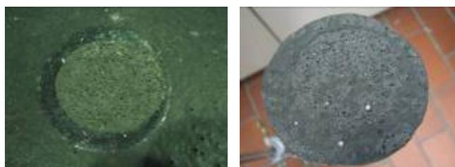
Abbildung 4.29: Repräsentative Bruchbilder nach den Haftzugversuchen der GfK-Anker auf der Seite der frei erstarrten Betonoberfläche
