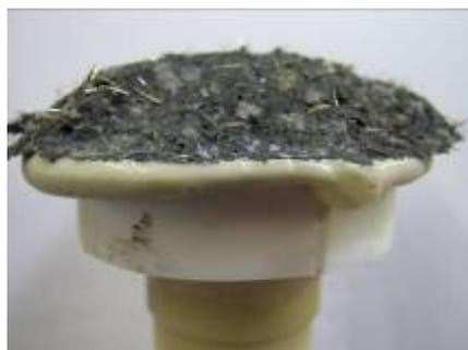
Abbildung 4.43: Kohäsives Versagen des Betons
