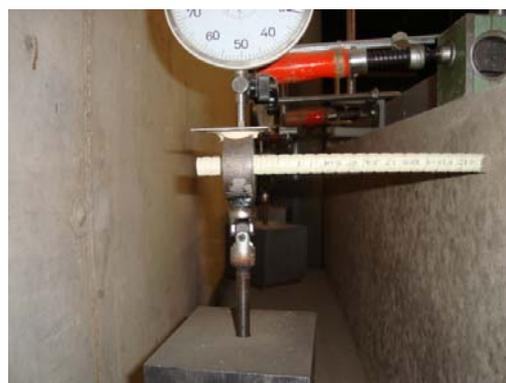
Abbildung 5.12: Versuchsstand des Langfristigen Biegeversuchs der GfK Anker
