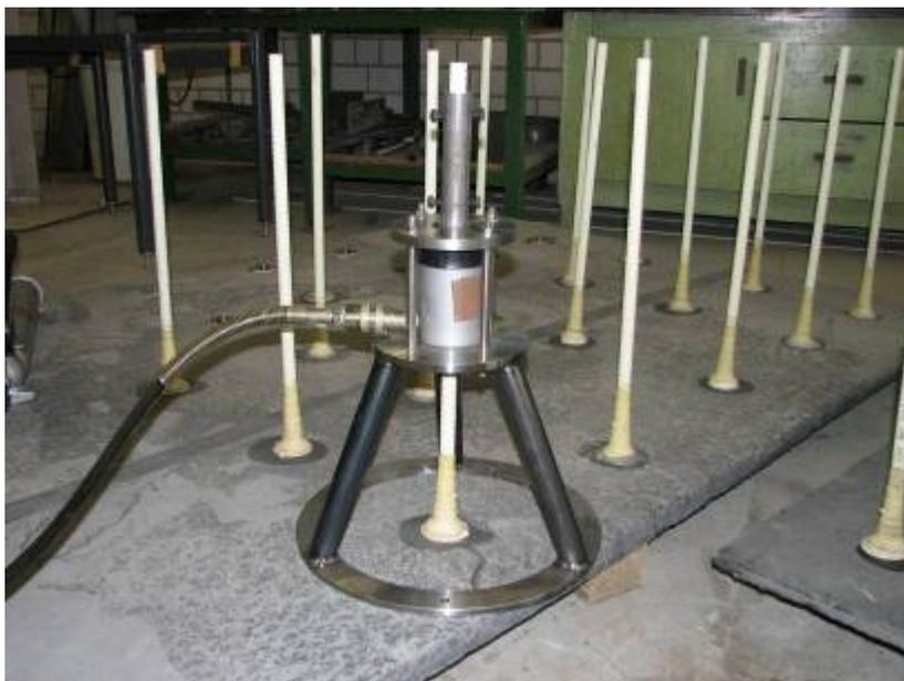
Abbildung 4.18: Hydraulische Zugprüfvorrichtung
