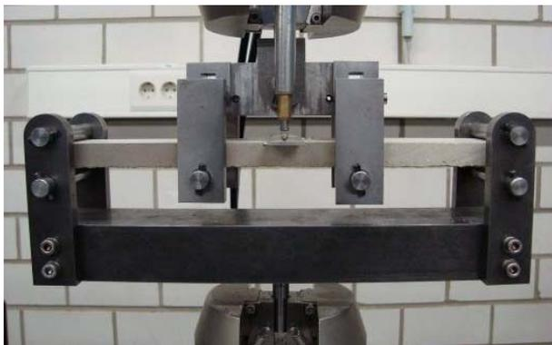
Abbildung 1.17: Prüfung der Biegezugfestigkeit vom Glasfaserbeton [38]
