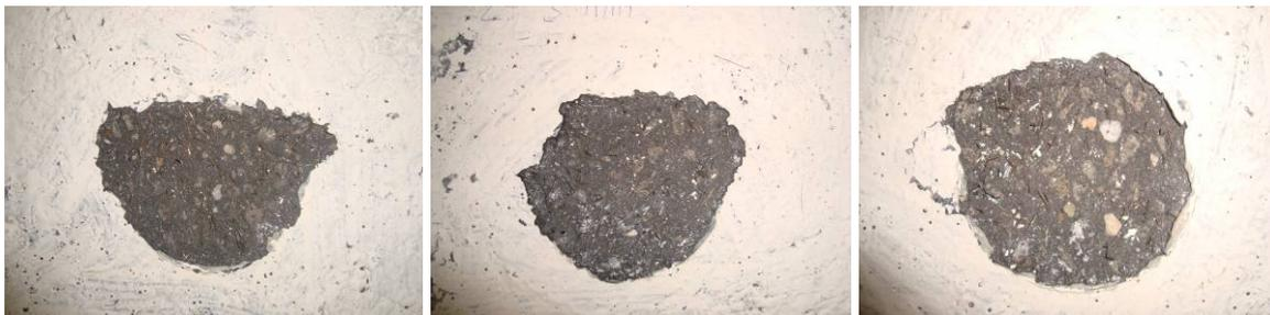
Abbildung 5.42: Versagen des Versuchs mit der 3 mm dicken Klebstoffschicht
