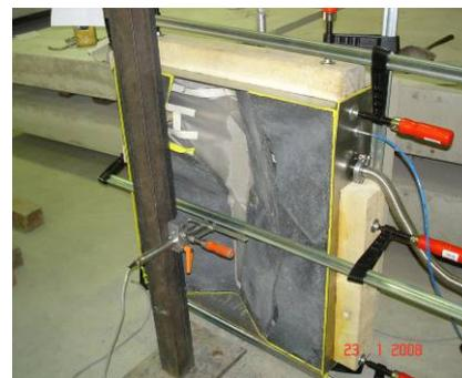
Abbildung 5.10: Ergebnisse des Winddruckversuchs an der 0.80 x 0.80 m großen Fassadenplatte (Unterdruck im Versuchstand)
