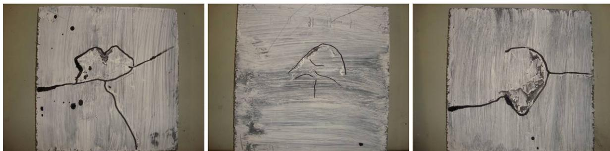
Abbildung 5.49: Durchstanzversagen nach dem Versuch mit dem 91 mm Ringauflager
