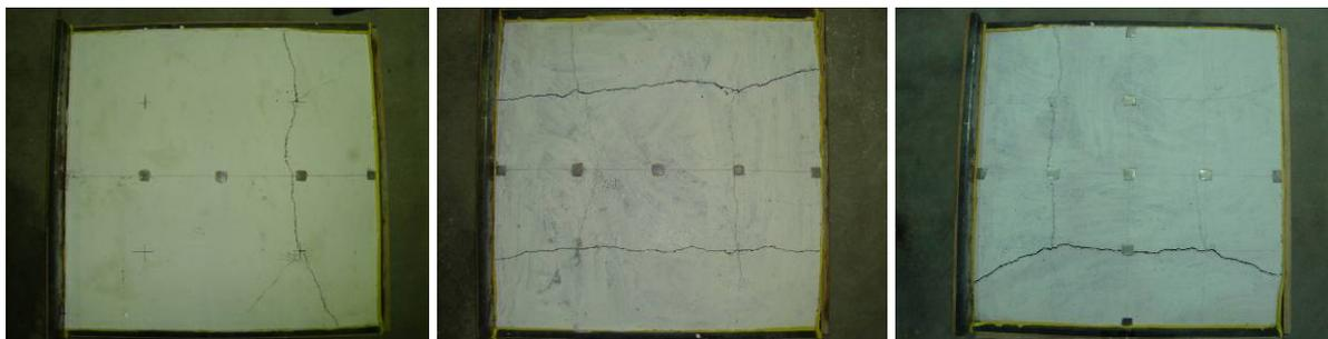
Abbildung 5.79: Versagen nach dem kurzzeitigen Unterdruckversuch
