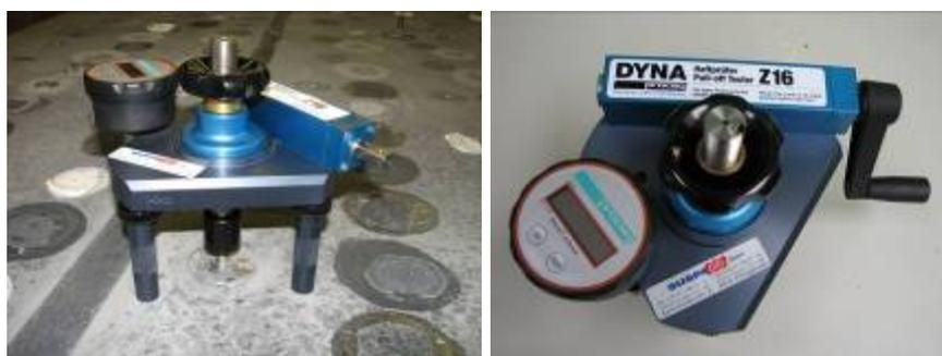
Abbildung 4.5: Haftprüfgerät Dyna Z 16
