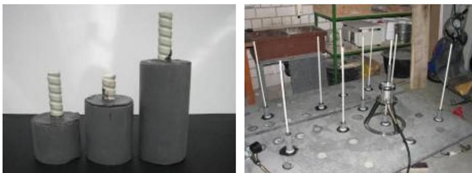
Abbildung 4.9: Klebversuche von GfK-Ankern mit aus Hochleistungsbeton hergestellten Köpfen
