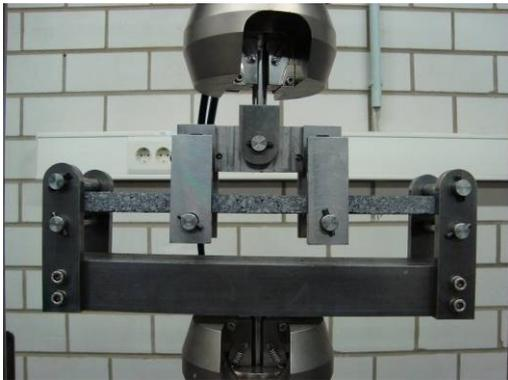
Abbildung 1.13: Prüfung der Biegezugfestigkeit vom hochfesten Beton
