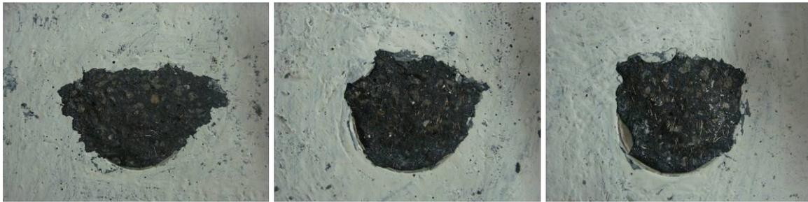
Abbildung 5.41: Versagen des Versuchs mit der 1 mm dicken Klebstoffschicht
