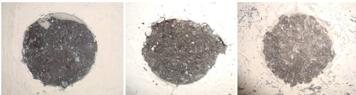
Abbildung 5.55: Versagen des Zugversuchs nach dem Lastwechsel
