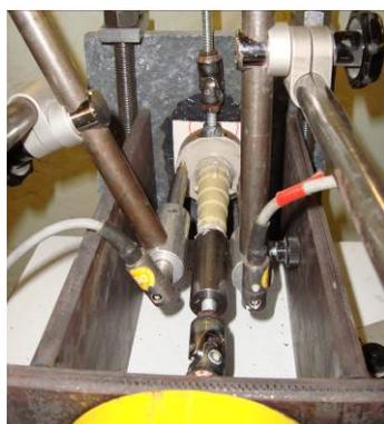
Abbildung 5.56: Versuchsstand des Zug-Scher Interaktionsversuches
