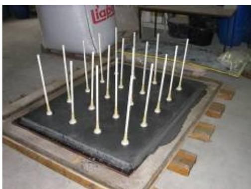
Abbildung 4.28: Geklebte GfK-Anker auf der frei erstarrten Betonoberfläche
