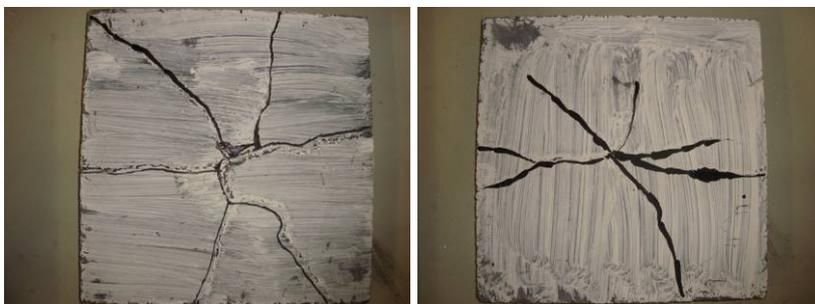
Abbildung 5.48: Biegeversagen nach dem Versuch mit den 160 mm und den 130 mm Ringauflagern
