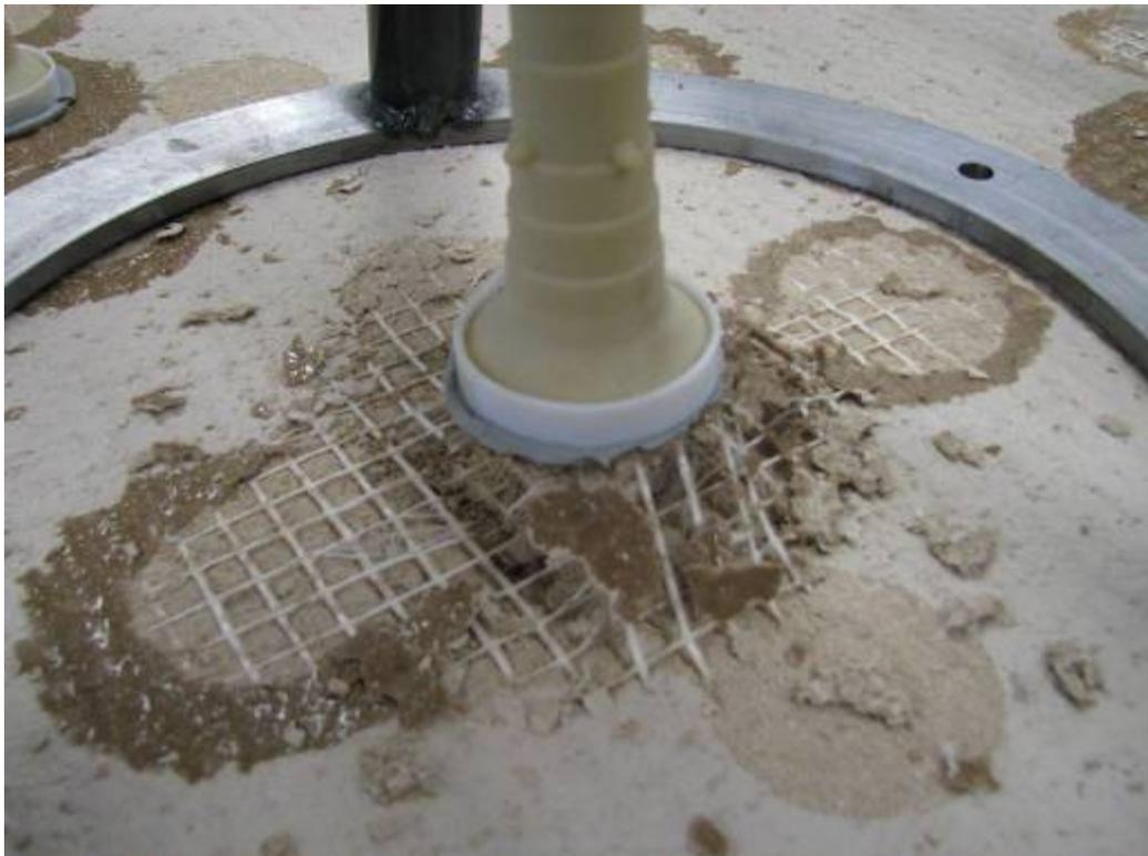
Abbildung 4.25: Bruch des Betons während des Haftzugversuches
