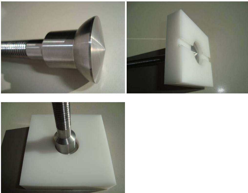
Abbildung 5.69: Muster des Klebetellers und des Stahlgelenkes
