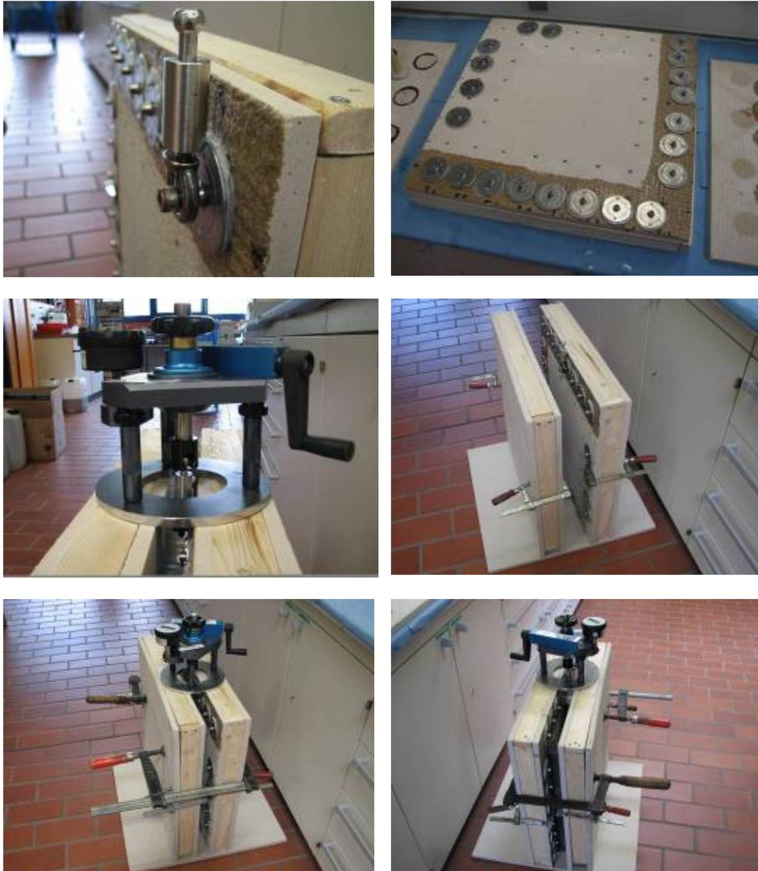
Abbildung 4.22: Versuchsaufbau zur Bestimmung der Scherfestigkeiten
