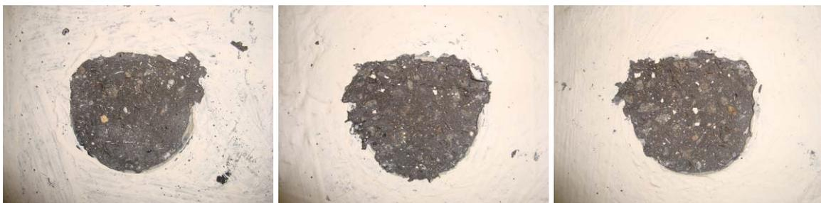
Abbildung 5.43: Versagen des Versuchs mit der 5 mm dicken Klebstoffschicht
