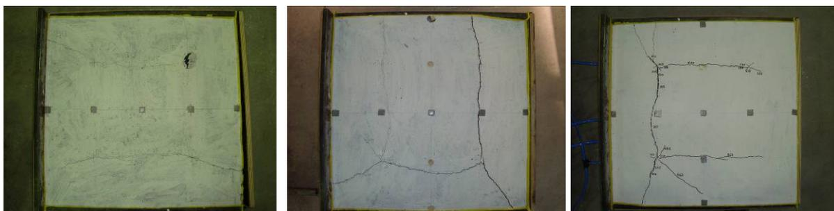
Abbildung 5.81: Versagen nach dem Unterdruckversuch mit dem dauernden Unterdruck
