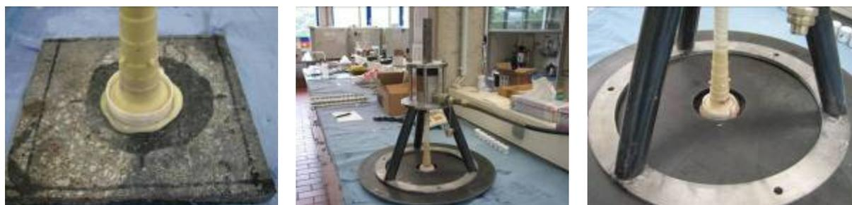
Abbildung 4.42: Haftzugversuche nach Klimawechseltest
