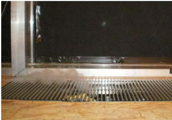
**Abbildung 132** Rauchversuch: Abluftansaugung am Unterflurgerät – Einbauvariante 1 (links)
