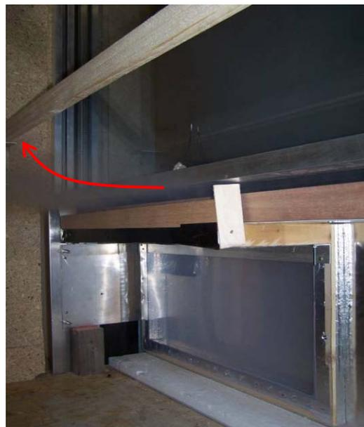
**Abbildung 48** Nebelversuch: Fortluftausblasung an der Fassade (rechts)
