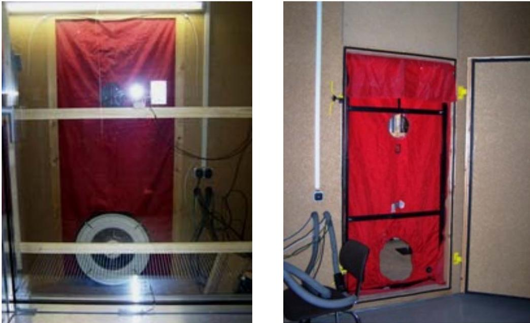
**Abbildung 46 Anordnung der Blower – Door in der Klimakammer**
