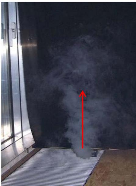
**Abbildung 47** Nebelversuch: Zuluftverteilung im Raum (links)
