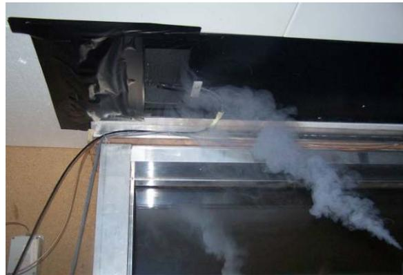
**Abbildung 133** Rauchversuch: Abluftansaugung am Deckengerät – Einbauvariante 2 (rechts)
