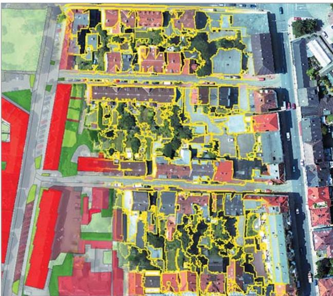
*Automatisierte Fernerkundung: Die in einem Luftbild (rechts) ähnlichen Bildpixel werden automatisch zu Segmenten (Mitte) zusammengefasst, aus denen mittels Klassifikation ein Datensatz über die Nutzungsarten (links) erstellt wird.*
