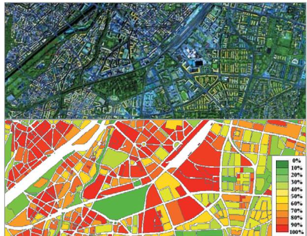
Eine Aufnahme der Fernerkundung mit dem Flugzeug (Hyperspektralsensor HyMap) (oben) und die daraus entstandene Kartierung des Versiegelungsgrads (unten)
