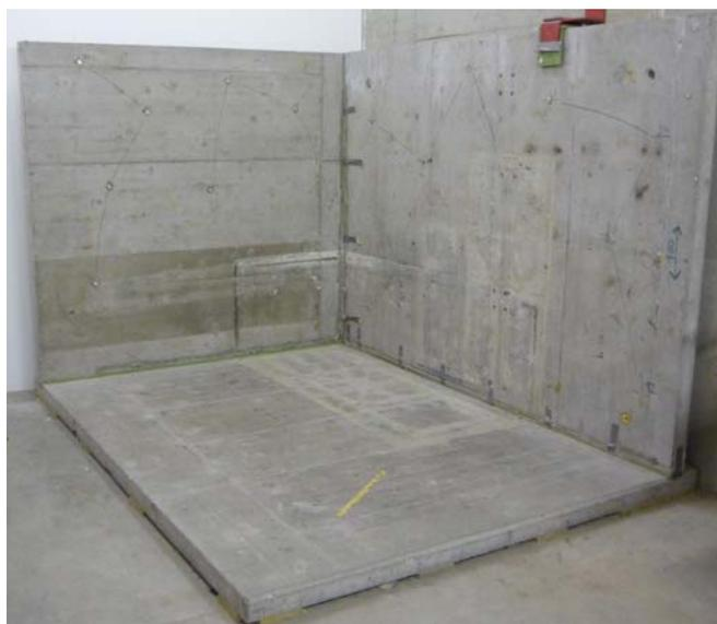
Bild 15: 3-D Empfangsplattenprüfstand im IBP
