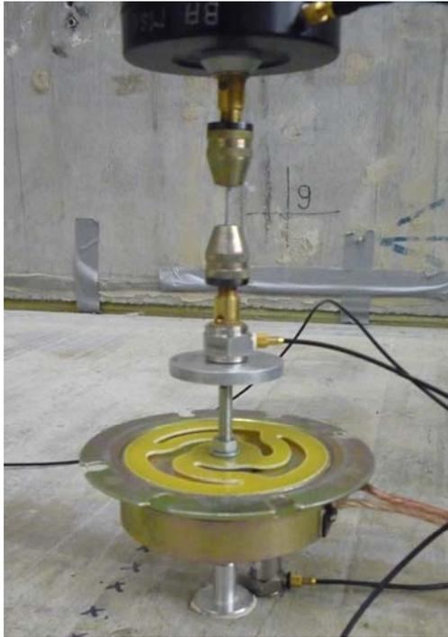
Bild 17: Fotografie des Modellaufbaus mit starrer Verbindung zur Bodenplatte.
