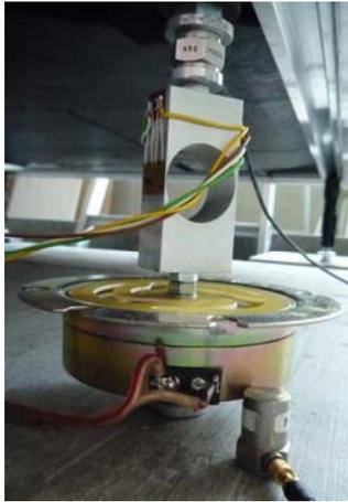
Bild 88: Messaufbau an einem der vier Duschwannenfüße bei der Kraftvorspeisung mit dem DMS-Sensor
