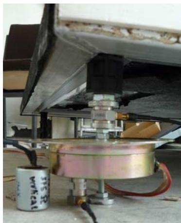
Bild 84: Messaufbau an einem der vier Duschwannenfüße bei der Schnellerückspeisung mit dem Geophon
