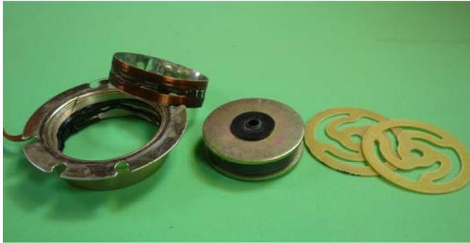
Bild 18: Fotografie des zerlegten Aktors. Links: Metallring mit Wicklung, Mitte: Dauermagnet, Rechts: Feder-Elemente zur Verbindung der einzelnen Teile.
