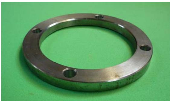
Bild 19: Fotografie des zusätzlichen Masserings für den Aktor.
