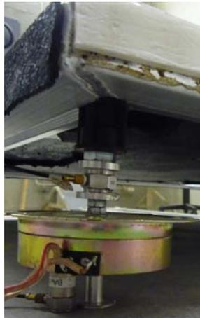
Bild 73: Duschwannenfuß mit integriertem Aktor beim Aufbau auf der Empfangsplatte.
