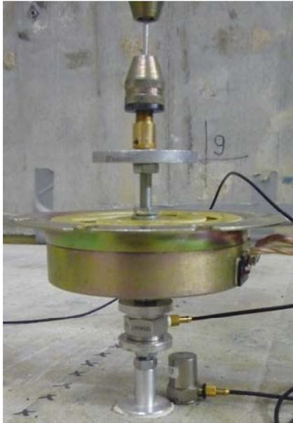
Bild 46: Modellaufbau zur Anwendung von Kraft-Rückspesung.
