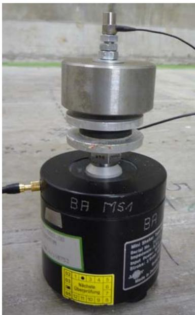
Bild 24: Messaufbau zur Ermittlung der elastischen Kenngrößen der elastischen Zwischenschicht (Darstellung mit einer oben aufgebrauchten Zusatzmasse).
