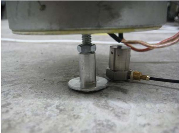
Bild 93: Detailaufnahme der starren Verbindung des Modellaufbaus mit der Bodenplatte
