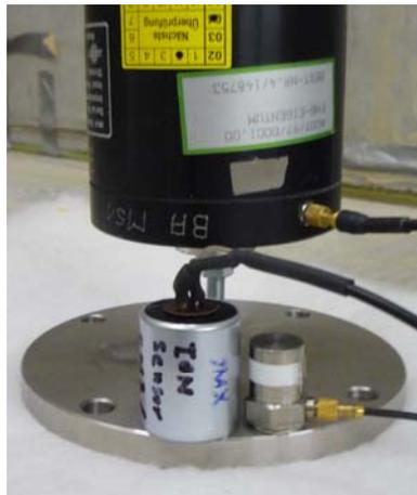
Bild 82: Messaufbau zum Abgleich der Geophon-Messung mit der Messung mittels Piezo-Beschleunigungsaufnehmer
