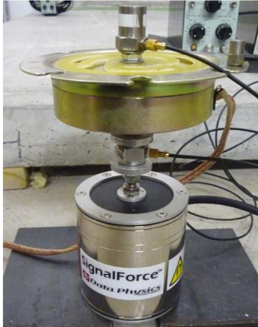
Bild 20: Messaufbau zur Untersuchung der dynamischen Eigenschaften des Aktors.
