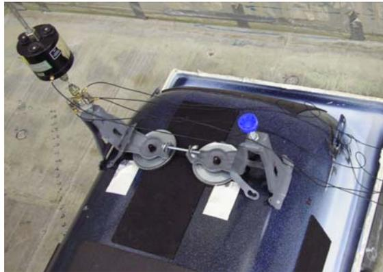
Bild 134: Aufnahme der Fußkonstruktion an der Badewanne aus Stahl-Email. Die Konstruktion der Füße an der Whirlwanne aus Stahl-Email war vergleichbar.
