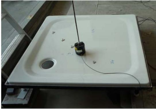
Bild 85: Draufsicht auf die Duschwanne mit Anregung durch einen Schwingerreger (Shaker)
