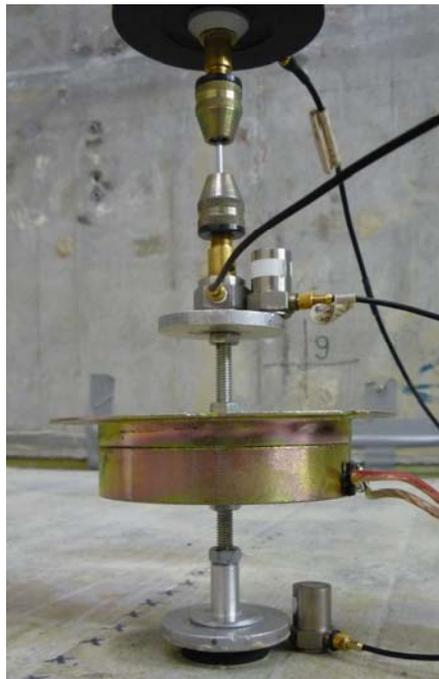
Bild 22: Modellaufbau mit elastischer Zwischenschicht zwischen Aufbau und Bodenplatte (Kombination von passiver und aktiver Körperschall-Isolierung)
