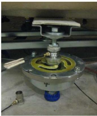
Bild 117: Aufbau des Fußes an der Acryl-Whirlwanne. Wannenfuß mit passiver und aktiver Körperschall-Isolierung
