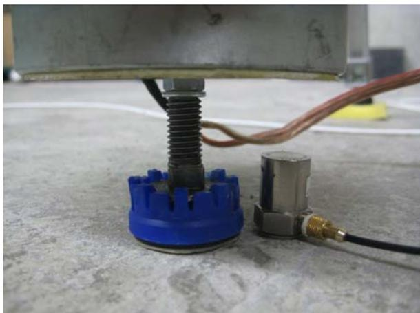
Bild 99: Bauteile des Wannenfußes: Elastische Zwischenlage, Kunststoffkörper und Gewindestange mit Kopf zum anklipsen des Kunststoffkörpers.
