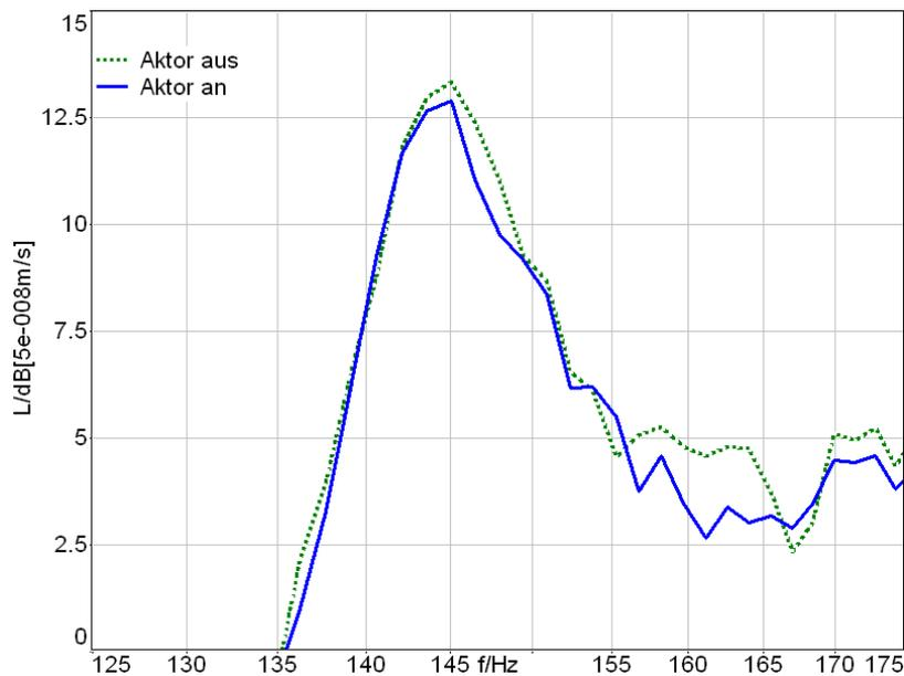
Bild 54: Detail aus Bild 53 für den Frequenzbereich von 125 Hz bis 175 Hz.
