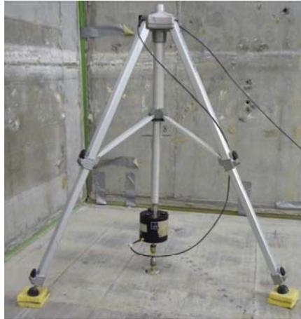
Bild 64: Anregung der Empfangsplatte durch einen entkoppelten Shaker bei der Bestimmung der Körperschall-Nachhallzeiten mittels MLS- Messtechnik.
