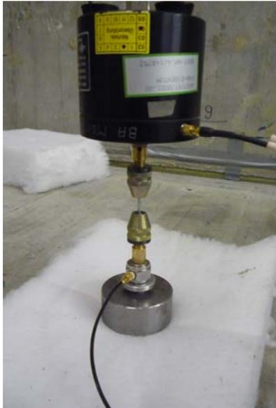
Bild 34: Aufbau zur Untersuchung der Resonanz des Aluminiumdrahts
