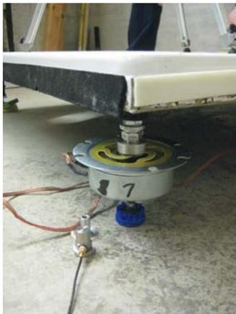
Bild 105: Ansicht des Aufbaus der Duschwanne mit einem Fuß. Alle anderen Füße waren durch weiche elastische Zwischenlagen von der Bodenplatte entkoppelt (hinten links)
