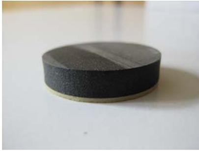
Bild 23: Elastische Zwischenschicht Aus Sylomer mit einer Dicke von 6 mm und einem Durchmesser von 30 mm. Unten zu sehen ist die Gleitschicht aus härterem Kunststoff.
