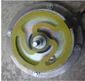
Bild 104: Draufsicht auf den Aktor des Fuß 2, mit etwas verrutschter Feder. Diese wurde nach diesem Versuch wieder eingerichtet und mit Klebstoff fixiert.
