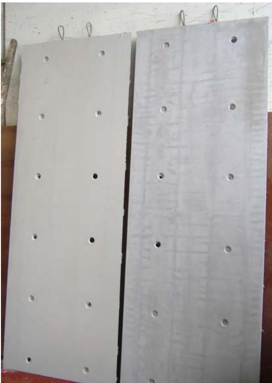
Bild 23: Vergleich zwischen gespritzter (links) und gegossener (rechts) Platte
