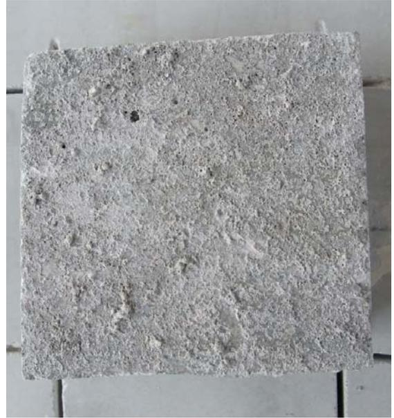
**Bild 55:** Versagensmechanismus eines Prüfkörpers von Wand 2 nach der Haftzugprüfung
