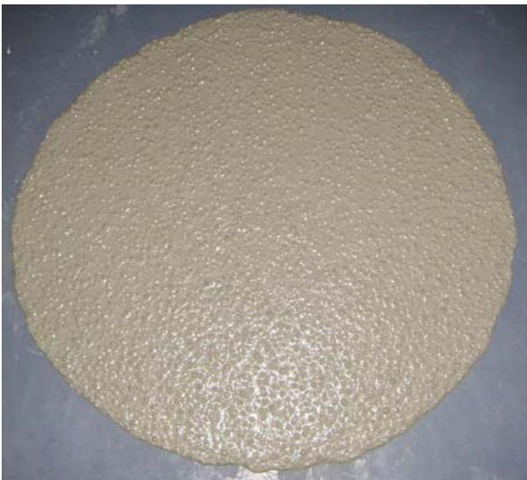
Bild 35: Setzfließmaß (670 mm) des im Werk hergestellten SVPLB
