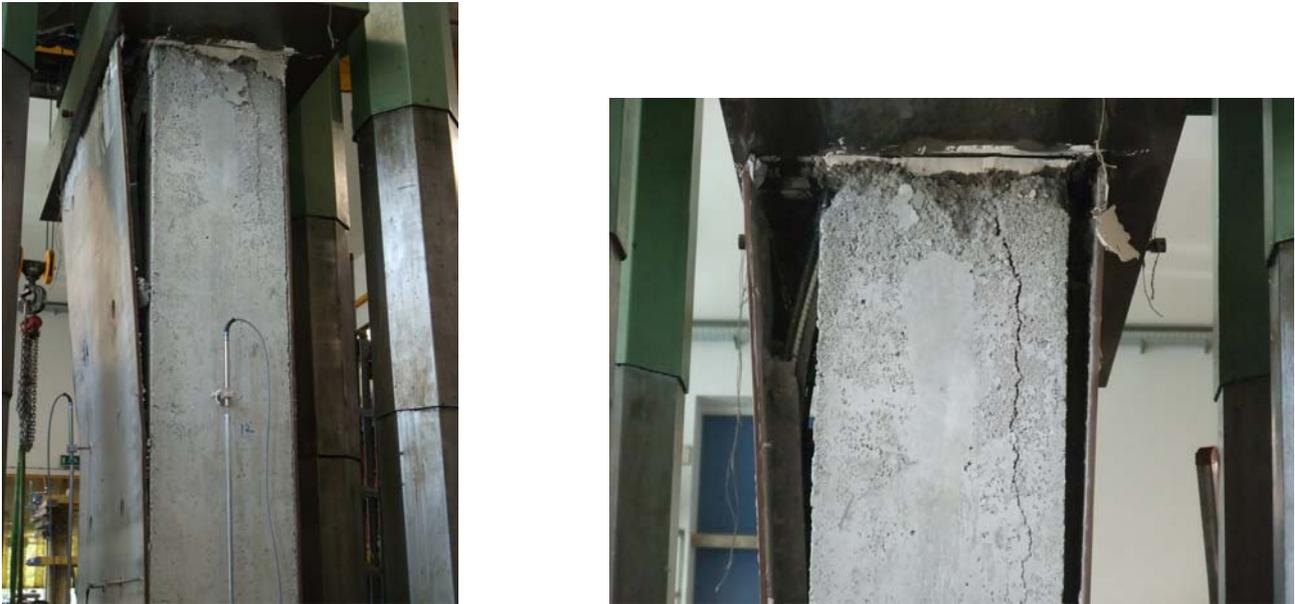
Bild 53: a) Seitliches Ablösen der BIS, b) Freilegen des GFK-Stabs
