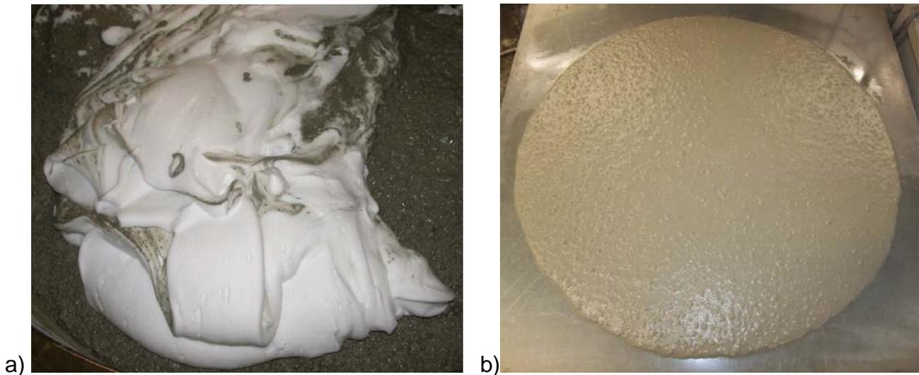
**Bild 25:** a) Schaumzugabe, b) Setzfließmaß der optimierten Betonmischung (680 mm)
