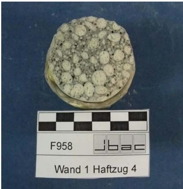
Bild 49: Versagensbild eines Prüfkörpers von Wand 1 nach der Haftzugprüfung
