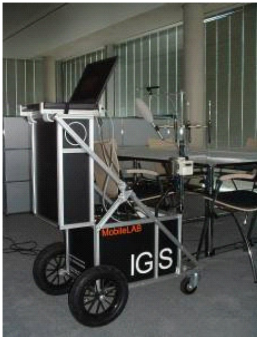
Abbildung 30 Messtechnikaufbau des MobileLAB
