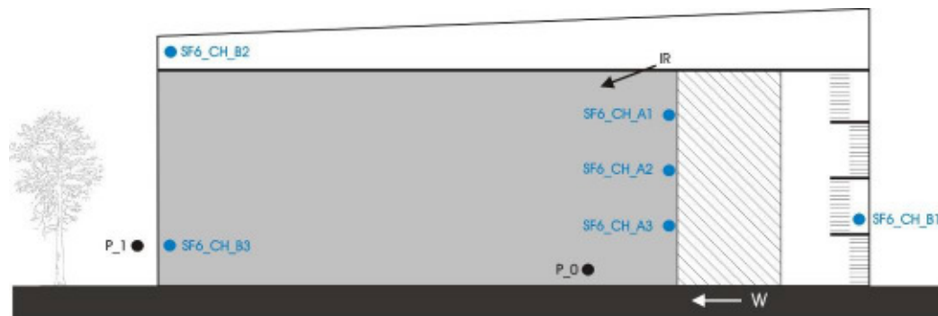
Abbildung 83 Lage der Messpunkte im Kurzzeitmonitoring
