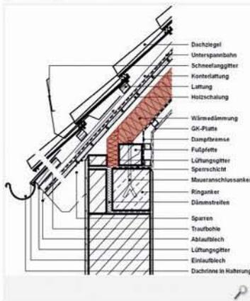
Der Traufanschluss einer Zwischensparrendämmung muss dicht ausgeführt werden; dies kann mittels Anschlusschürzen geschehen.
