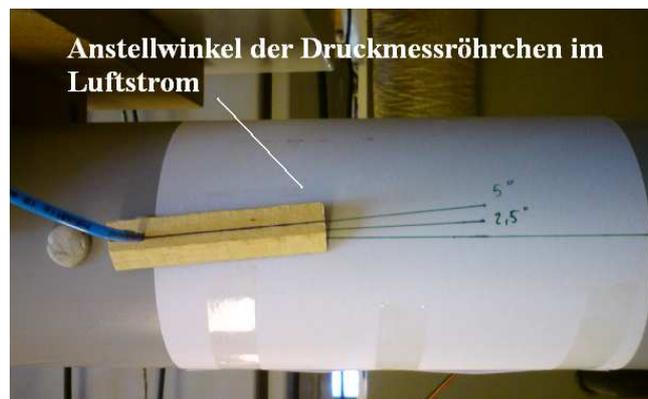
**Abb.14: winkelabhängig Volumenstrommessung**
