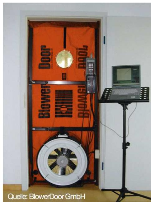
**Abb.1 Aufbau BlowerDoor Test**
