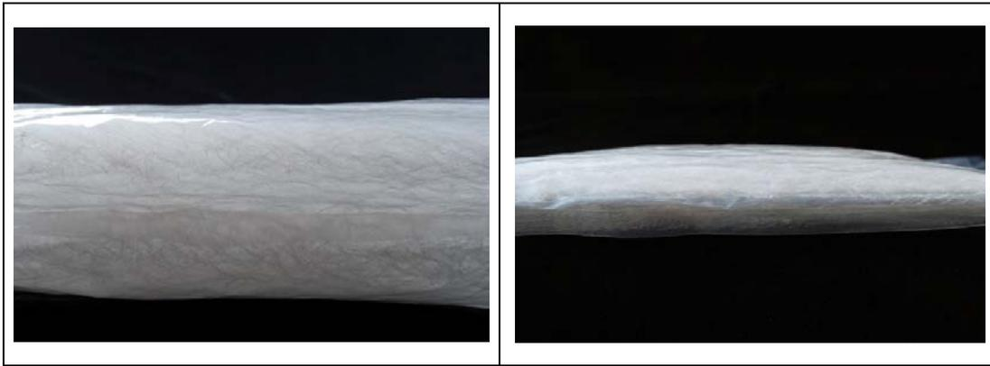
Abbildung 38: Komprimierbarkeit eines Glasfasergespinnsts unter Vakuum. Links: vor der Komprimierung, rechts: während der Komprimierung
