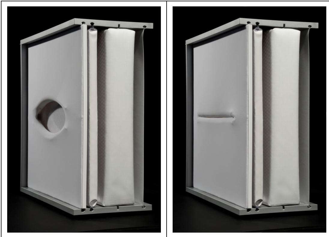
Abbildung 43: Lagenaufbau – Atmende Gebäudehülle. Geöffnet (links), geschlossen (rechts)
