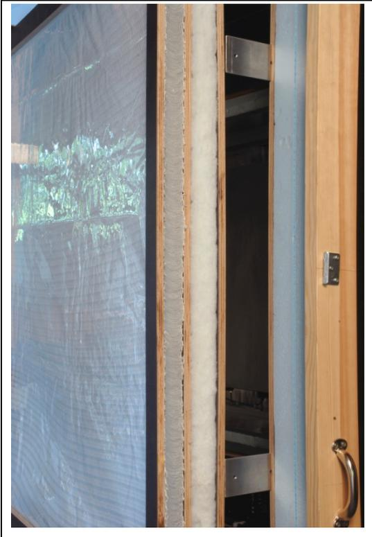
Abbildung 16: Beispiel für einen Lagenaufbau im Heizkasten
