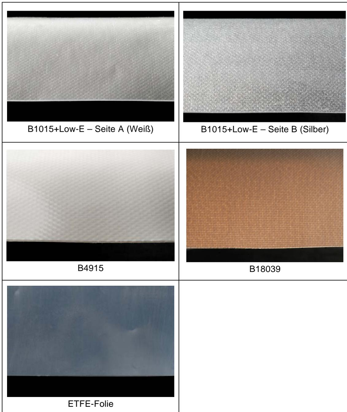
Abbildung 32: Auf strahlungstechnische Kennwerte untersuchte Membran- und Folienmaterialien (Bezeichnungen und Messergebnisse siehe Tabelle 15)
