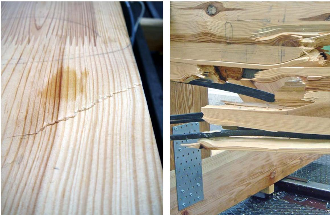
*Abbildung 8-20: Versuch *trv\_0,35\_1*: plastische Verformung der obersten Brettlamelle (links); Biegezugversagen an lokaler Fehlstelle in der untersten Brettlamelle (rechts)*
