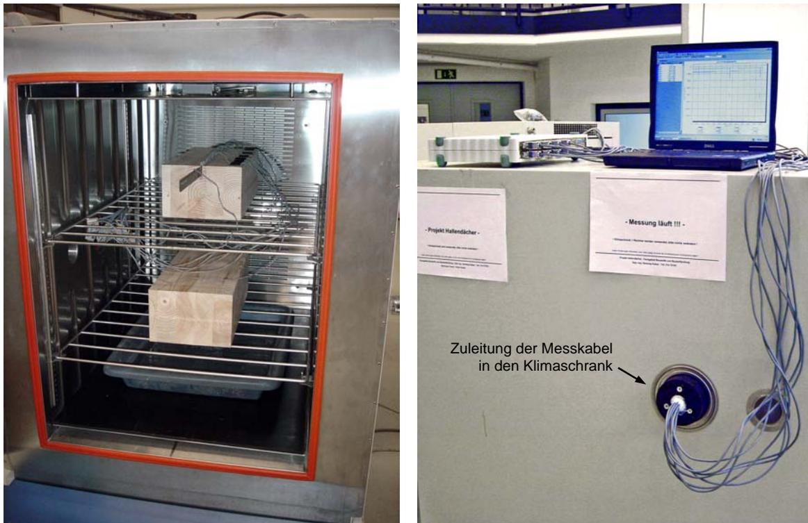
Abbildung 6-35: Lagerung der Verbundprobekörper im Klima 20°C / ≈95% r.F. (links); Messeinrichtung zur Erfassung der Lamellendehnung entlang der Klebefuge (rechts)
