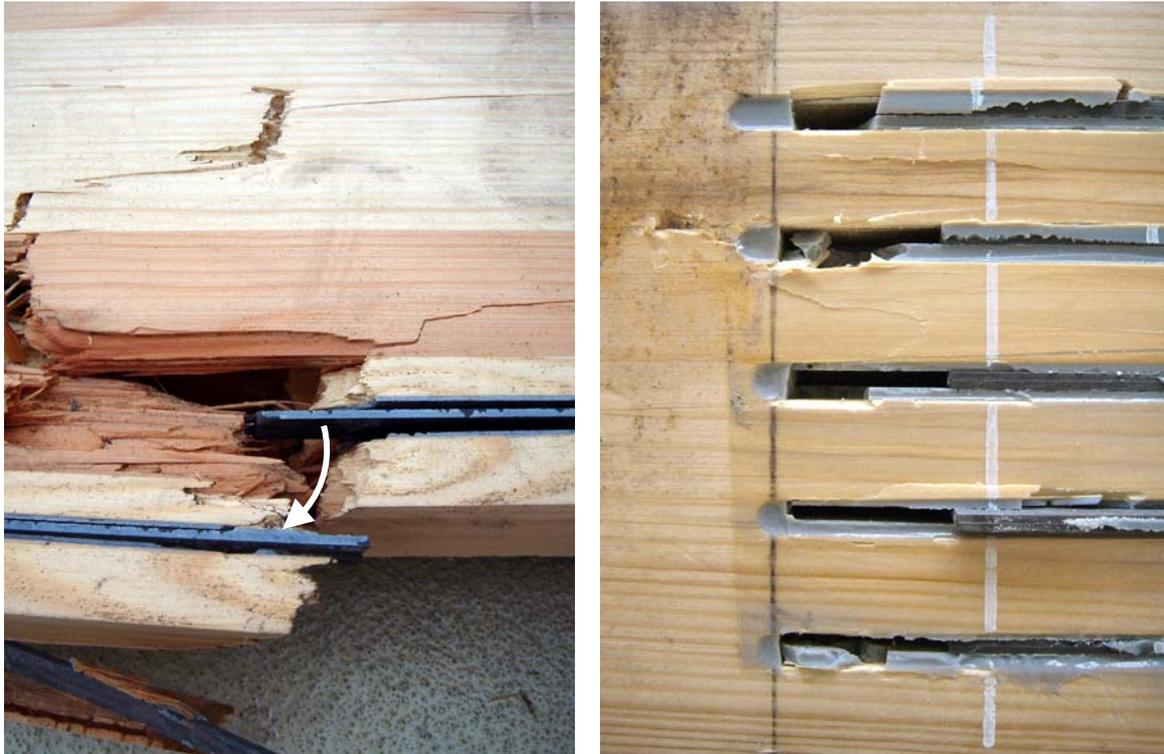
Abbildung 8-10: Abscherversagen der CFK-Lamelle im Bereich des Biegebruchs (links);
