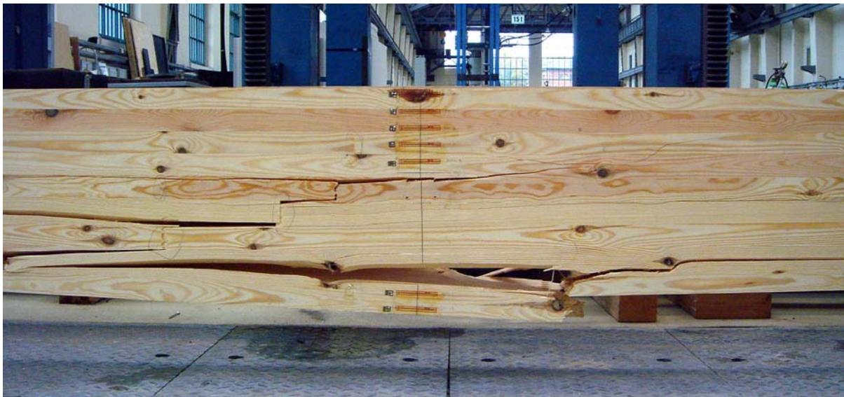
*Abbildung 8-7: Typisches Bruchbild eines unverstärkten Referenzträgers*
