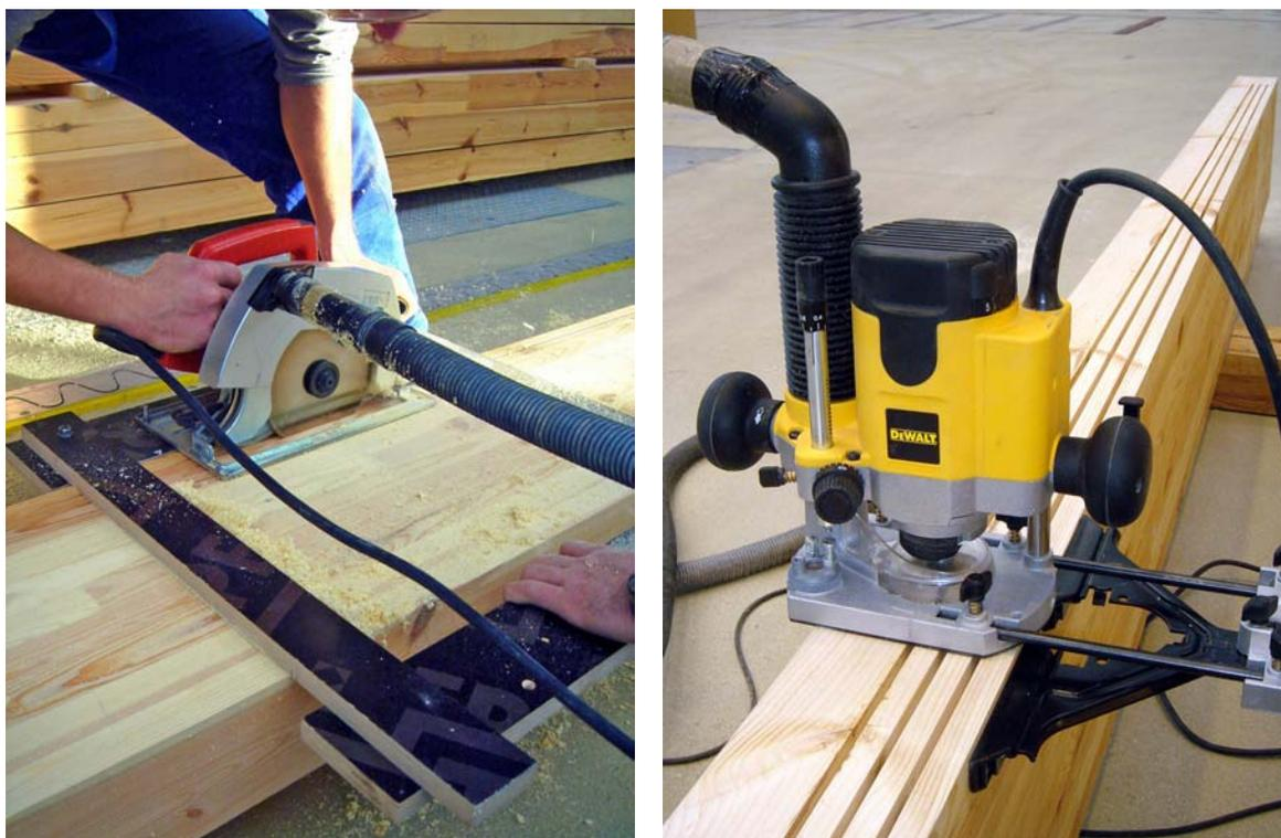
Abbildung 8-5: Maschinen zur seitlichen (links) bzw. unterseitigen (rechts) Einschlitzung
