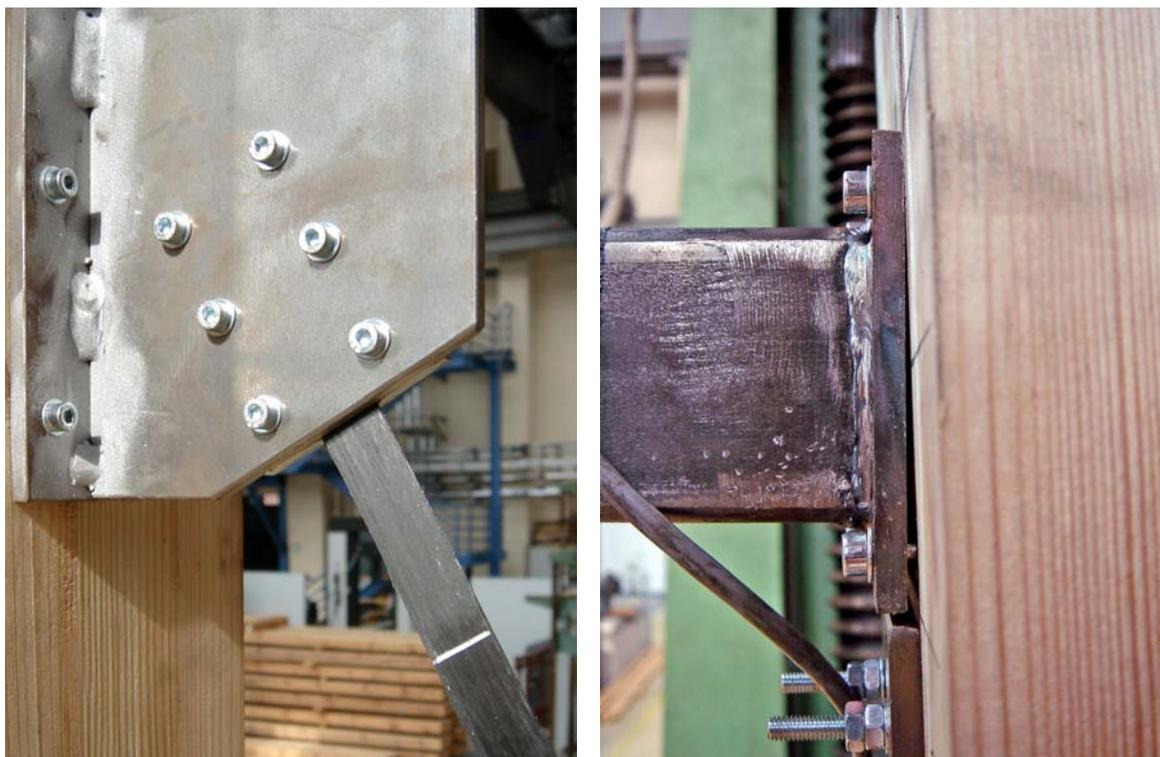
*Abbildung 10-10: Versuch asv\_1: Herausrutschen der geklemmten CFK-Zugbänder (links);
