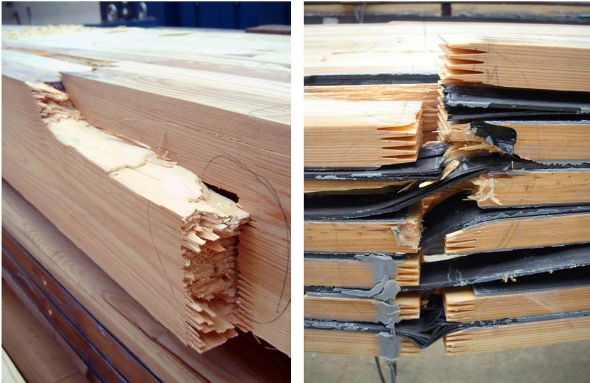
Abbildung 8-8: Zugversagen der KZV: unverstärkter (links) bzw. verstärkter Träger (rechts)
