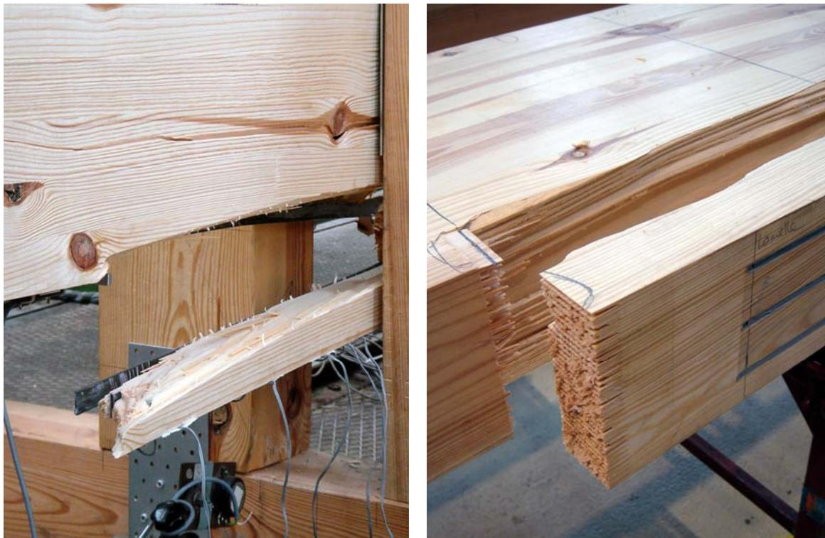
Abbildung 8-23: Bruchversagen unmittelbar hinter dem Lamellenende: Versagen im Holz, *trv\_0,35\_K\_3* (links); Versagen an der KZV, *trv\_0,35\_K\_1* (rechts)
