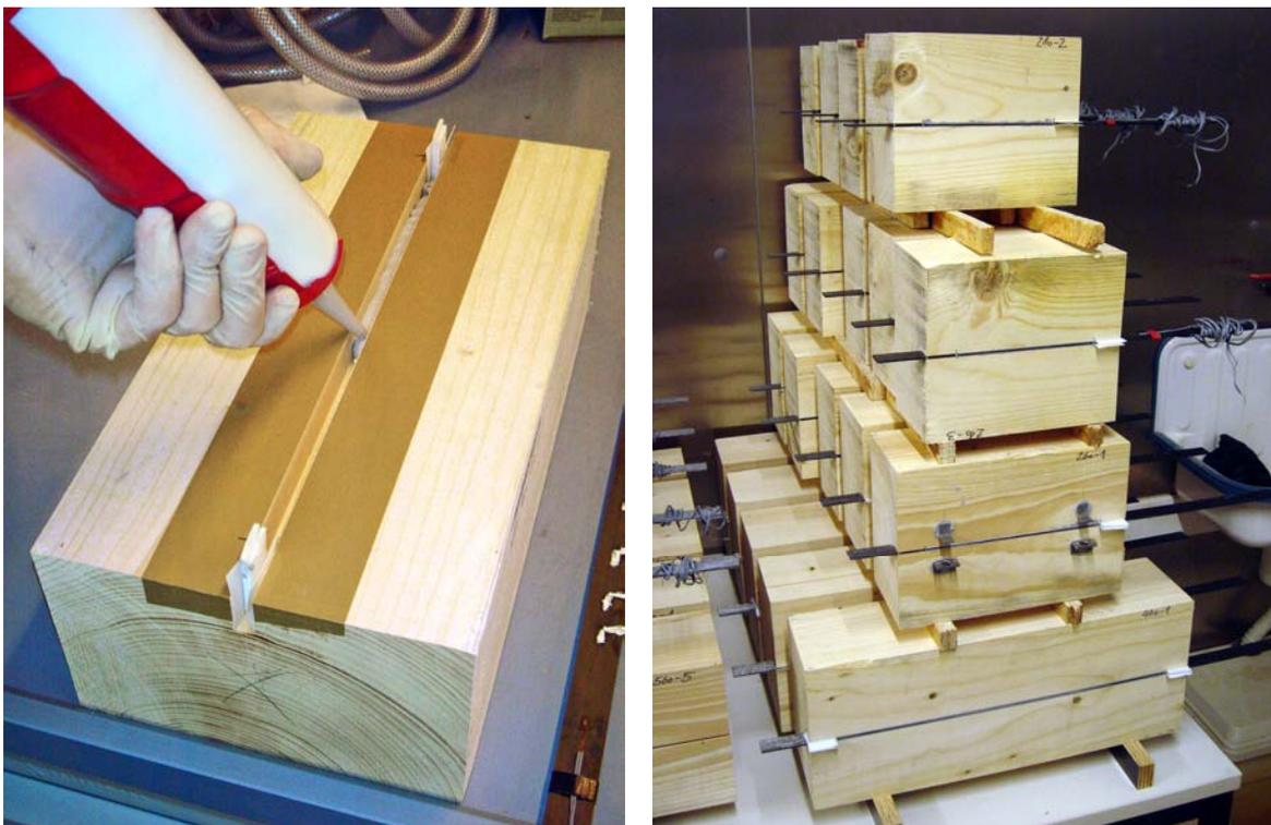
Abbildung 6-7: Einbringung des Klebers (links) und Lagerung der Verbundprobekörper im Normklima 20/65 (rechts)
