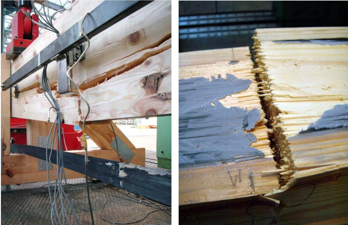
Abbildung 8-19: Versagensbilder von Trägern mit aufgeklebter CFK-Lamelle (S812)
