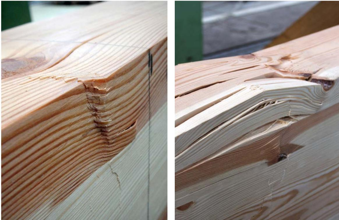
Abbildung 8-9: Plastisches Versagen der Holzdruckzone:  $p = 0,81$  (links);  $p = 0,91$  (rechts)
