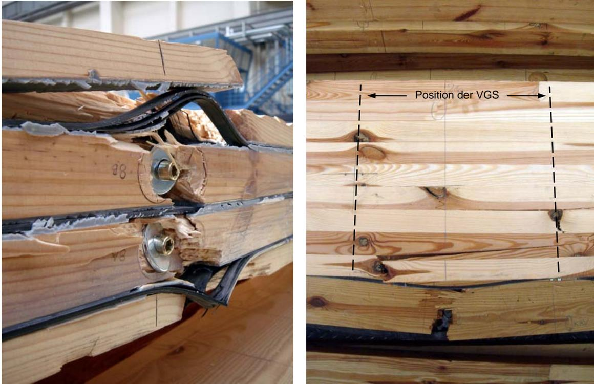
Abbildung 8-22: Biegeriss an VGS (links); Behinderung der Rissausbreitung durch VGS (rechts)
