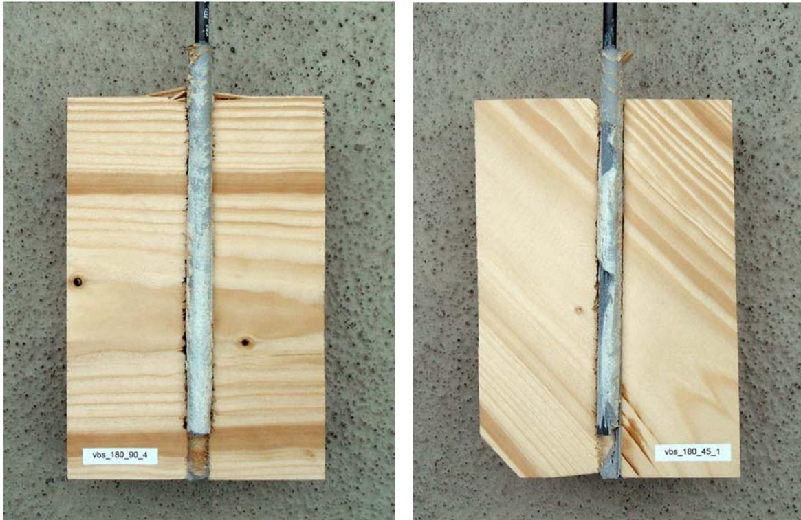
Abbildung E-2: Geprüfte Verbundproben mit 90° (links) und 45° (rechts) Faserrichtung
