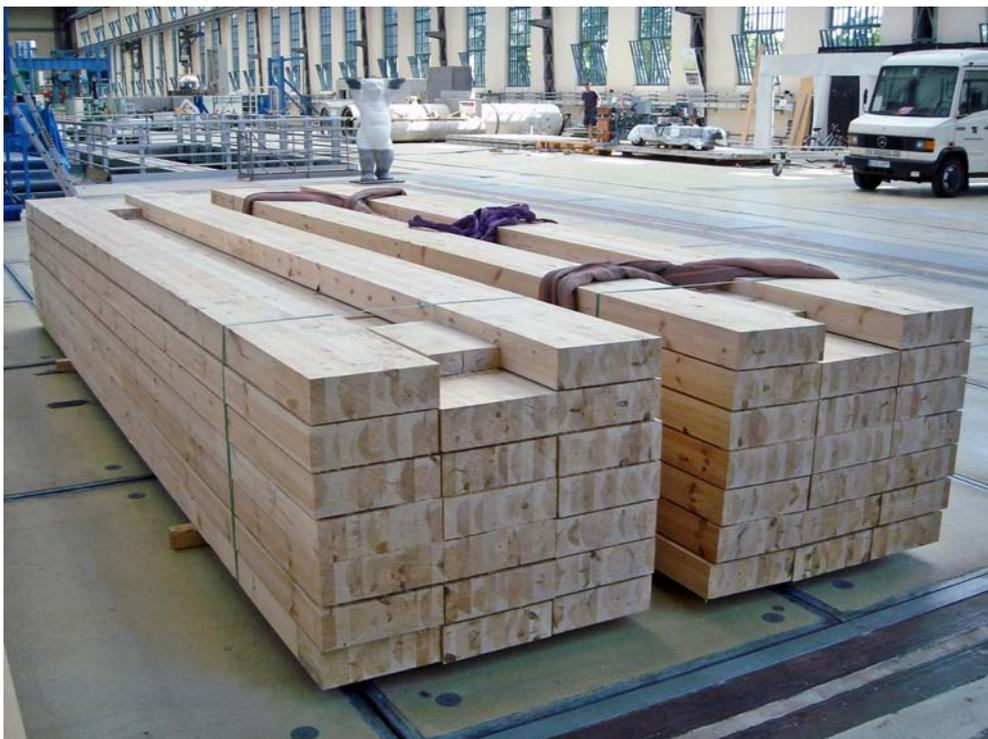
Abbildung 8-1: BSH-Träger aus Kiefernholz (Festigkeitsklasse GL24h)
