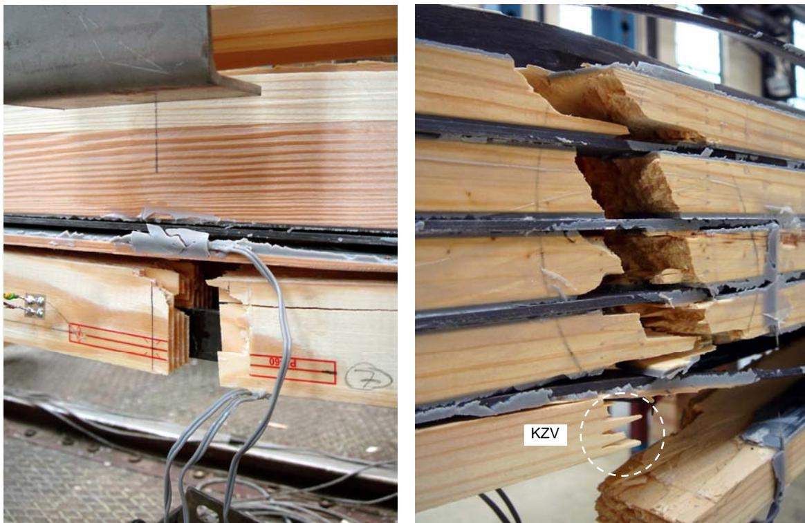
Abbildung 8-24: Zugversagen an der KZV im maximalen Momentenbereich (*trv\_0,81*)
