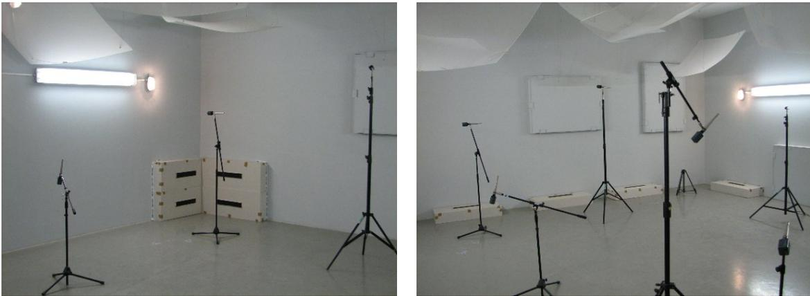
Abbildung 33: Anordnung der Resonatoren in den Raumkanten (3,3,3,1) und in den Raumecken (4,4,2,2)
