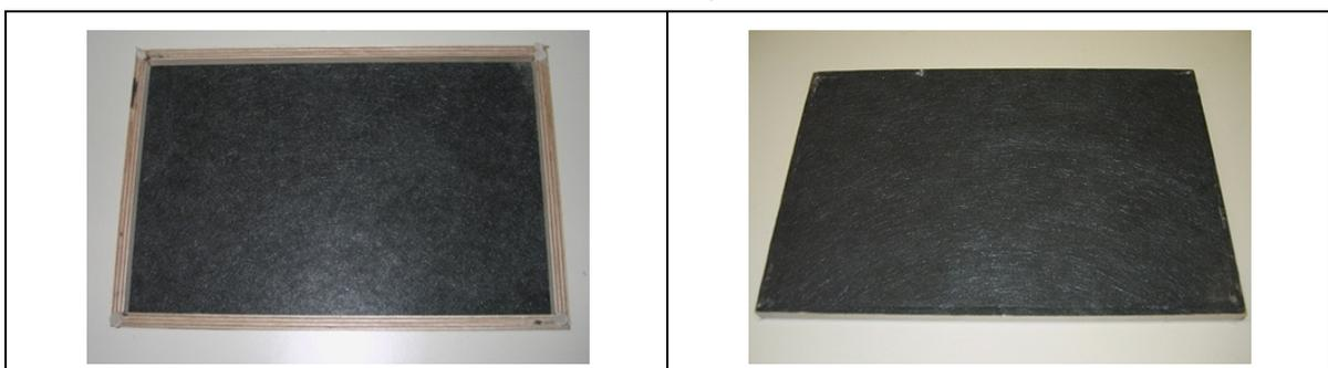
Abbildung 22: Rahmen für Mündungs-Bedämpfung
