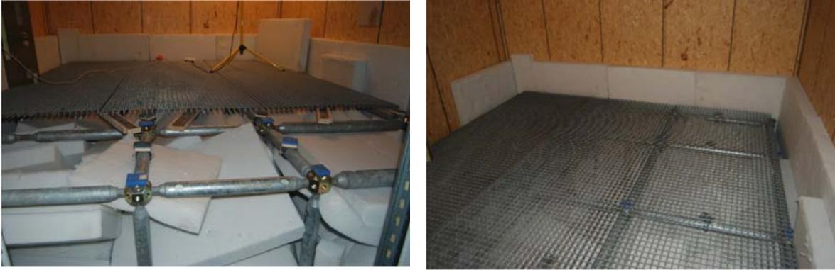
Abbildung 10: Modifizierung des Empfangsraums zur Messung der Schallintensität
