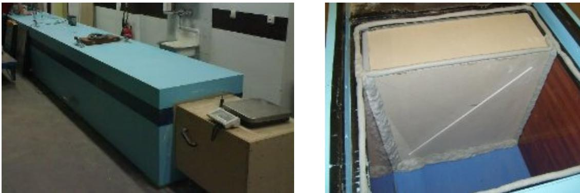
Abbildung 27: Links Impedanzrohr MBBM; rechts Resonatorprüfling in das Rohr eingesetzt
