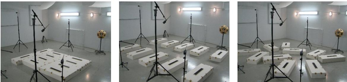
Abbildung 34: Verschiedene Anordnung der Resonatoren innerhalb der Prüffläche
