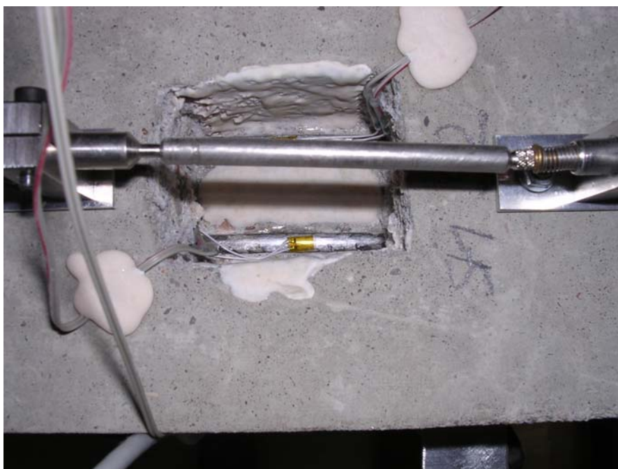
Abb. 9.4: Messung der Spannstahldehnung und der Relativverschiebung in Balkenmitte
