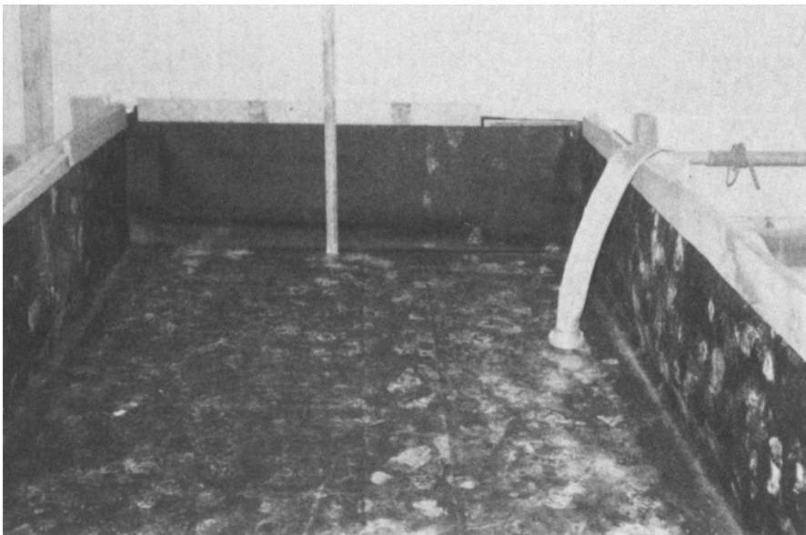
Abb. 3.6: Belastung von Decken mit Wasserlasten [8]
