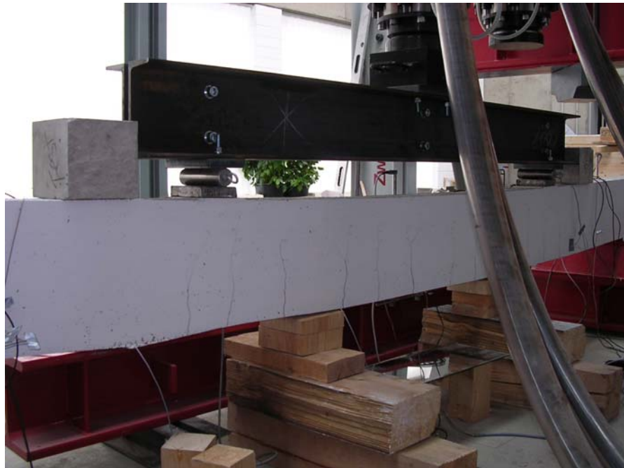
Abb. 9.7: Rissbild des Balkens 1 unter Maximalbelastung
