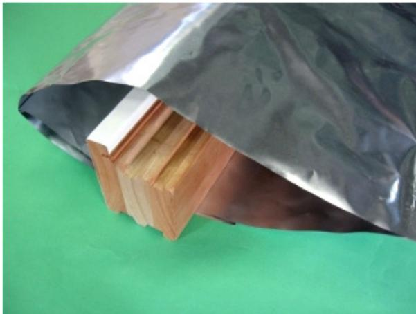
**Abbildung 13** Probenverpackung in Aluminiumbeutel
