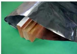
**Bild 1:** Probe wird in mitgelieferten Beutel gesteckt
