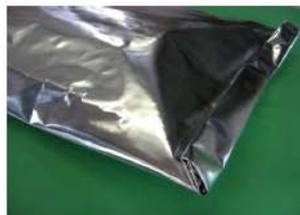
**Bild 2:** offene Beutelseite wird mehrfach eingeschlagen
