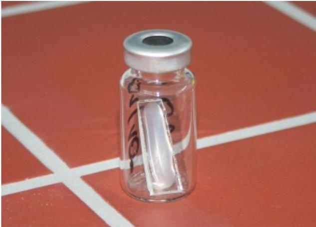
**Abbildung 22** lackierter Glasträger in Vial mit Septumkappe
