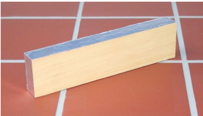
**Abbildung 30** Probekörper für Holz-Screening,
