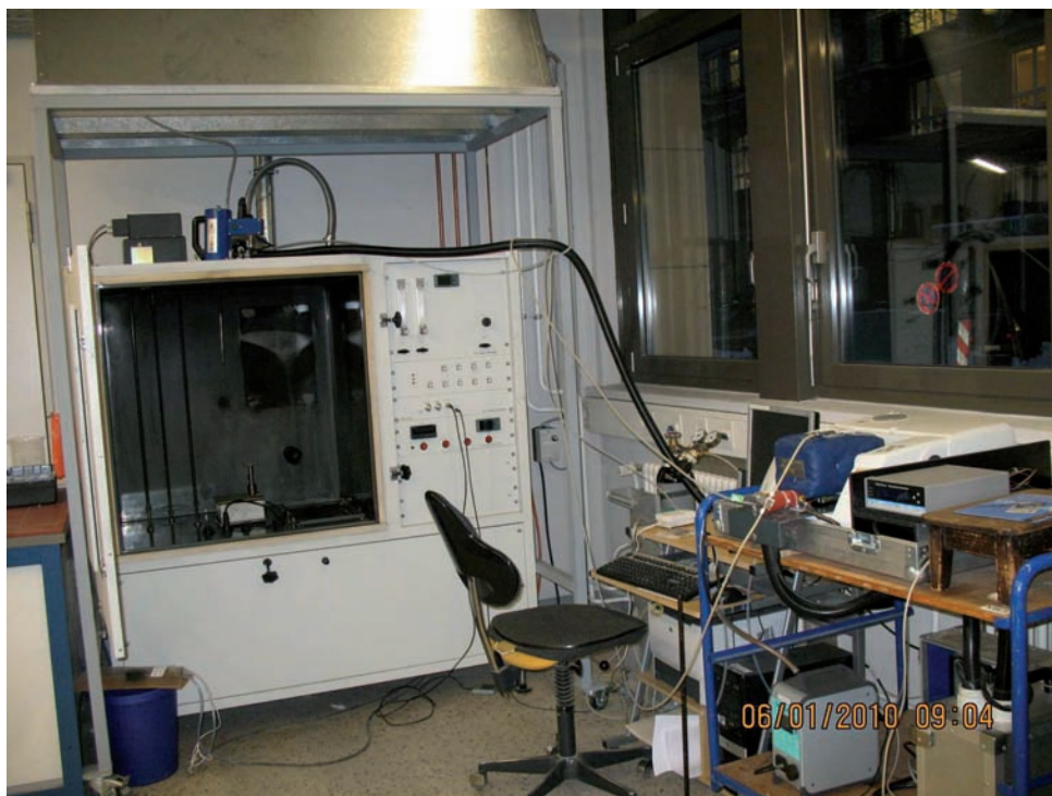
Abbildung 1: Rauchkammer mit angeschlossenem FTIR-Spektrometer
