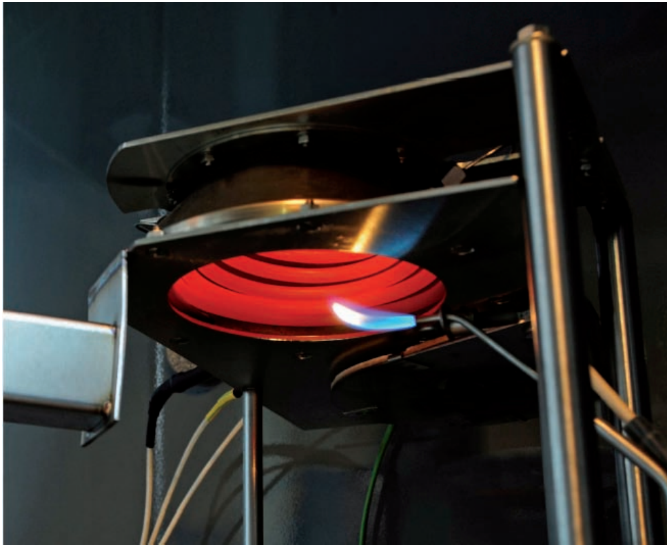
Abbildung 2: Cone-Heizelement mit regelbarer Wärmestromdichte
