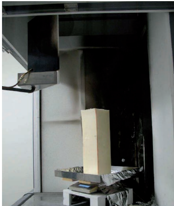
Abbildung 10: Kalorimeter (umgebaute Single Burning Item Test-Apparatur)
