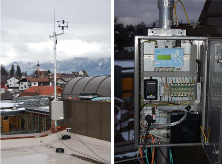
Abbildung 37: Wetterstation auf dem Dach der Turnhalle mit Mast, Blitzableiter, Sensoren an Ausleger und Schaltschrank (links), geöffneter Schaltschrank mit Datenlogger (rechts)
