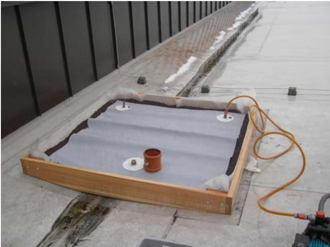
Abbildung 39: Schneekissen in Rahmenvariante „Graben“, während des Befüllvorgangs
