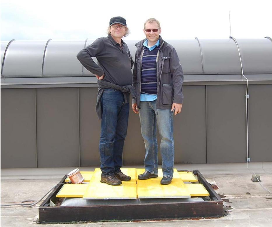
*Abbildung 50: Belastung des östlichen Schneekissens mit Mannlast*
