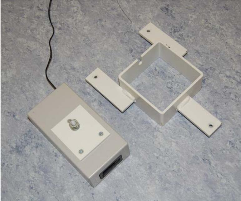
Abbildung 34: Laser-Distanz-Messgerät mit Halterung
