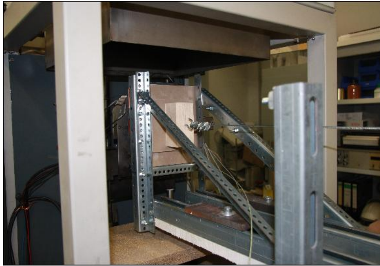
Abbildung 27: Für Zugkraftbeanspruchung umgebauter Versuchsstand
