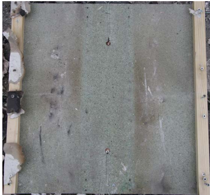
Abbildung 42: Indikatorplatte nach dem Brandversuch
