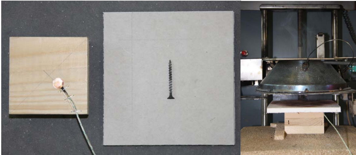
Abbildung 2: Einzelteile eines Prüfkörpers und Prüfkörper im Cone-Kalorimeter während des Versuchs Der Versuch wurde abgebrochen, wenn das Thermoelement in der Grenzschicht zwischen Gipsplatte und Holzquader eine Temperatur von 270 °C erreicht hat. Der Probekörper wurde aus dem Cone-Kalorimeter entnommen, sodass die Gipsplatte sofort abgebaut werden konnte. So wurde der Holzquader schnellst möglich gekühlt und die thermische Schädigung des Holzes konnte bestimmt werden.
