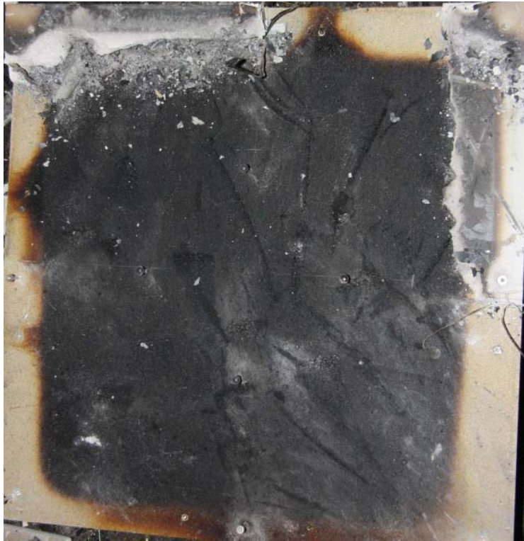
Abbildung 48: Verkohlung nach dem Brandversuch auf der B1- Indikatorplatte
