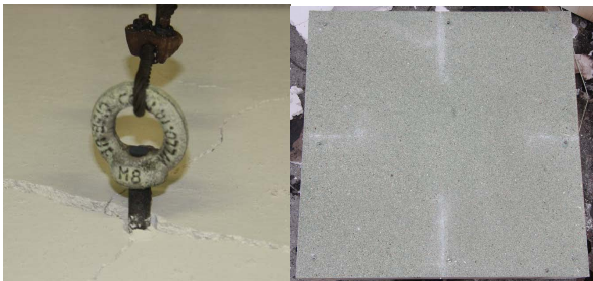
Abbildung 39: Schraube mit Stahlseil und Indikatorplatte nach dem Brandversuch
