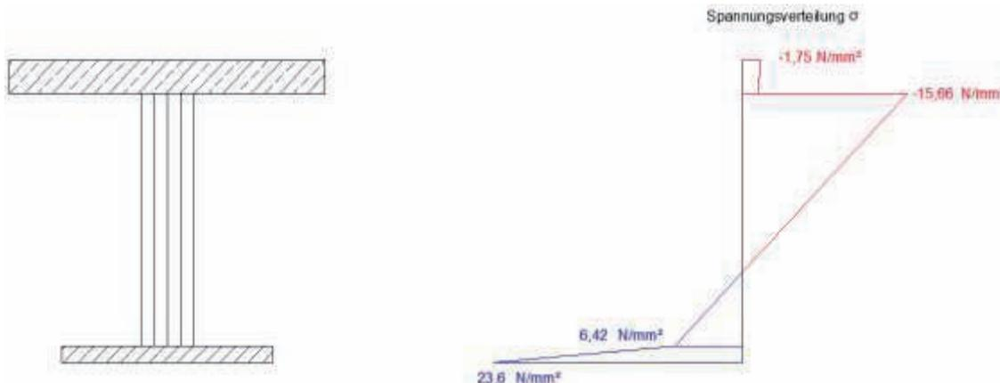
Abbildung 56: Spannungsverteilung nach Schwinden und Kriechen nach dem Teilquerschnittsverfahren  $\varphi=2,0$
