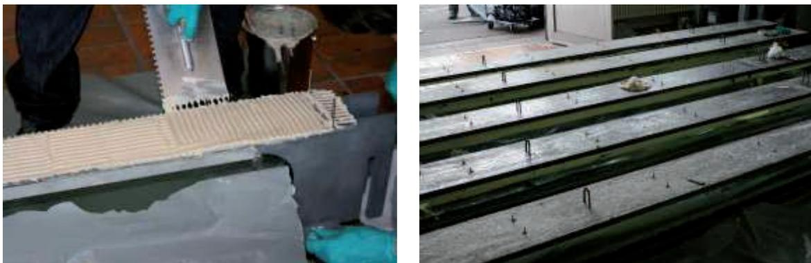
Abbildung 43: Auftragen des PU-Klebstoffes und fertige Verbundträger
