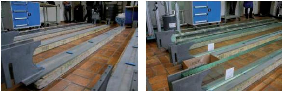
Abbildung 41 Ausrichten der Stahluntergurte und Einsetzen der Glassteige
