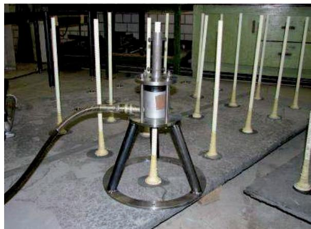
Abbildung 17: Haftzugprüfung der GfK-Beton-Verbindung [1]
