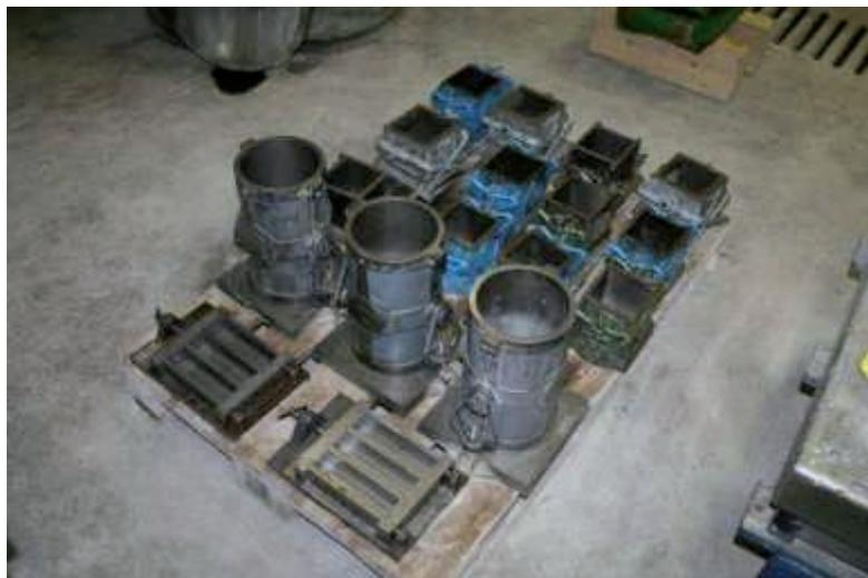
Abbildung 36: Übersicht der verwendeten Probekörperschalungen
