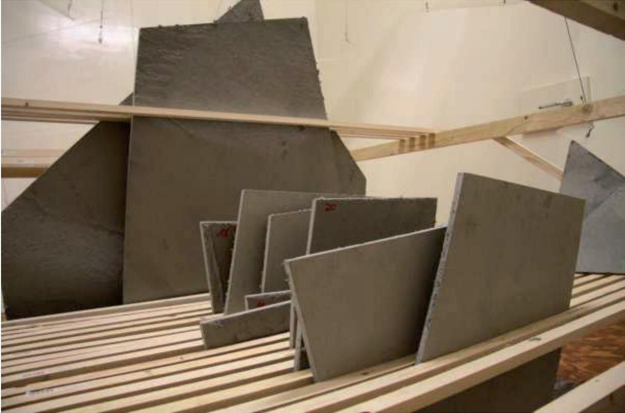
Abbildung 50: Lagerung der hergestellten Fassadenplatten, Ansicht der nummerierten Rückseiten
