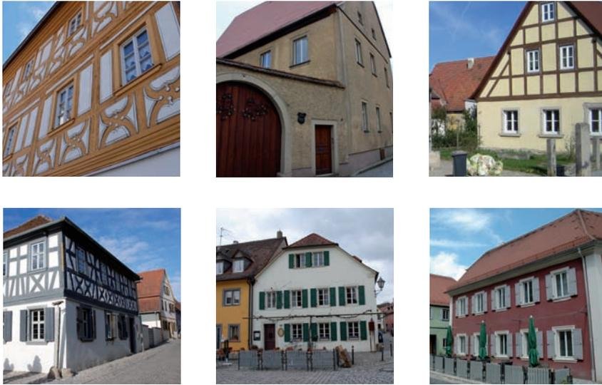
Abb. 31: Grundsätzliche Konstruktionstypen (v.l.n.r.: Zierfachwerk, Massiv, Konstruktives Fachwerk)
