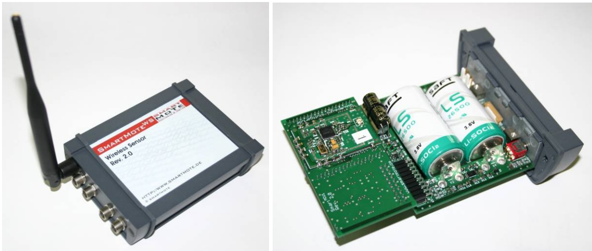
Abb. 7: Sensorknoten für den Betrieb in drahtlosen Sensornetzen (links) mit Stromversorgung und Miniatursensoren (rechts).
