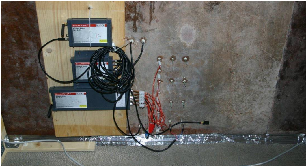
Abb. 32: Anordnung der Silber-/Silberchloridelektroden und der drahtlosen Messeinheit in der Schlosskapelle Schönbrunn.
