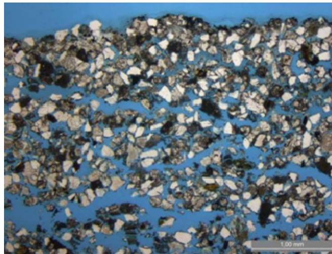
Abb. 31: Mikroskopische Untersuchung eines Dünnschliffes aus Varignana Sandstein vom Palazzo Malvezzi mit sehr starker Auflockerung des Korngefüges durch Lösung karbonatischer Bindemittel und Rissbildung, Porenraum blau eingefärbt, planpolisiertes Licht.
