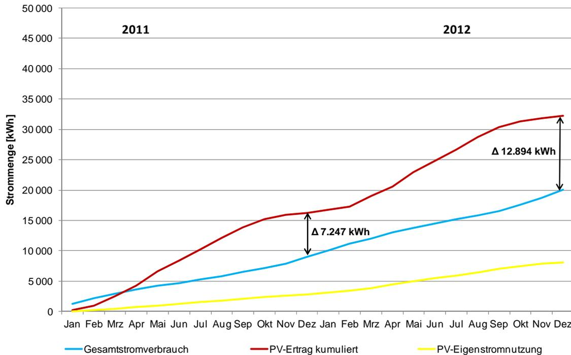
**Abbildung 14: Kumulierter Gesamt Stromverbrauch, PV- Stromertrag und Eigenstromnutzung für die ersten zwei Betriebsjahre (2011 und 2012)**
