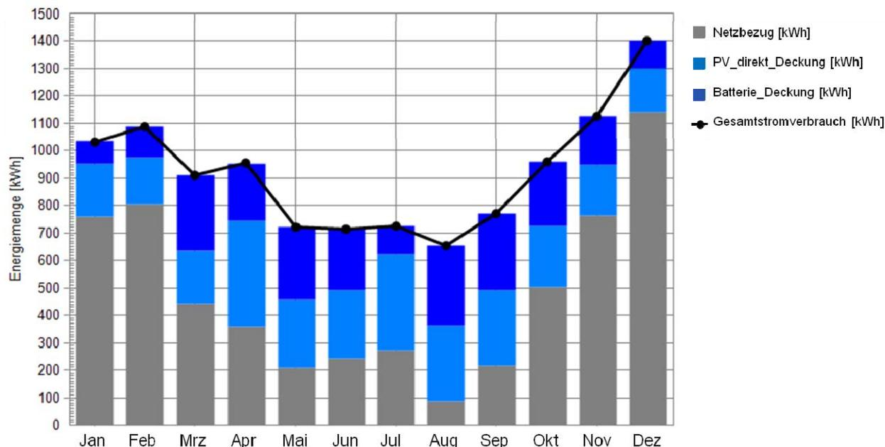
Abbildung 25: Deckungsanteile Stromverbrauch durch PV, Batterie und Netzbezug 2012
