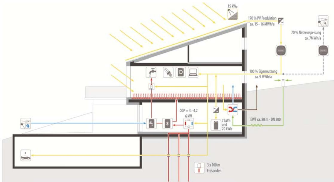
Abbildung 7: Energiekonzept (2012) ohne Solarthermie-Anlage, „Nur- Stromhaus“
