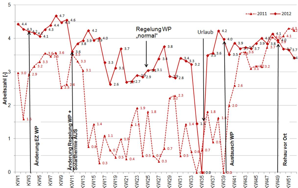
Abbildung 22: Wöchentliche Arbeitszahl der Wärmepumpe seit Januar 2011
