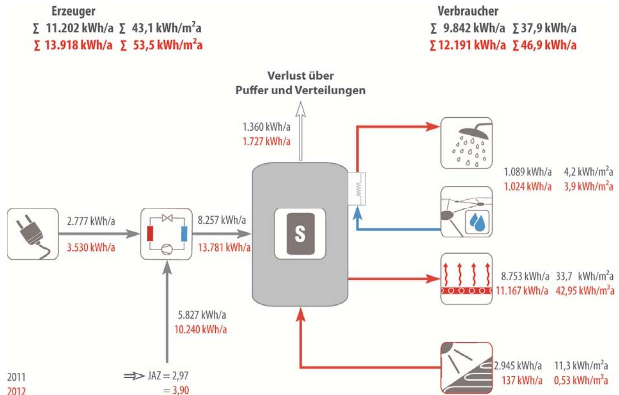
Abbildung 20: Jährliche Wärmemengen aufgeteilt in Erzeugung, Verteilung und Abgabe in 2011 und 2012
