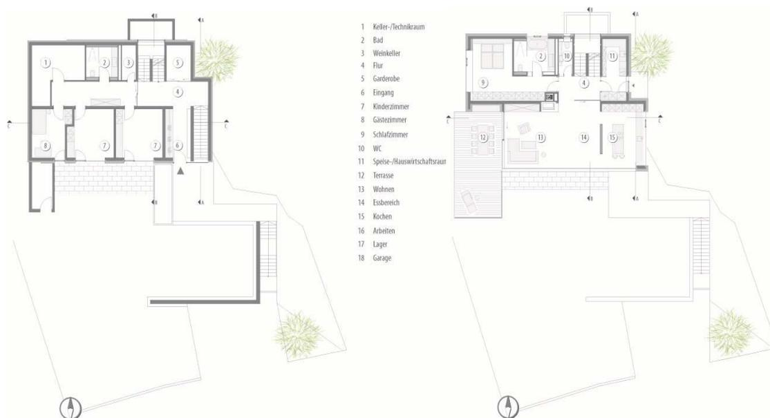
**Abbildung 3: Grundriss Erdgeschoss (links) und 1. Obergeschoss (rechts)
