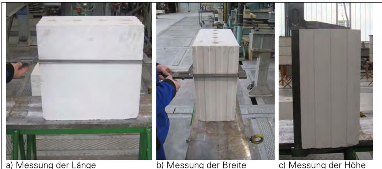
Bild 168 Abmaßprüfung an festgelegten Messstellen
