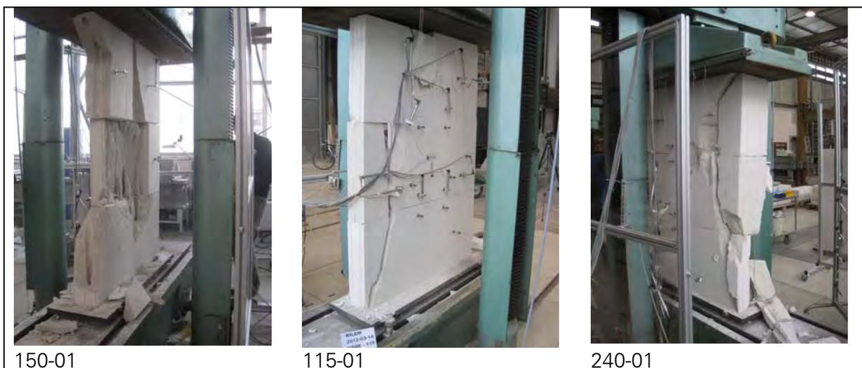
Bild 187 Allgemeines Bruchbild von Trockenmauerwerk unter Druckkraft
