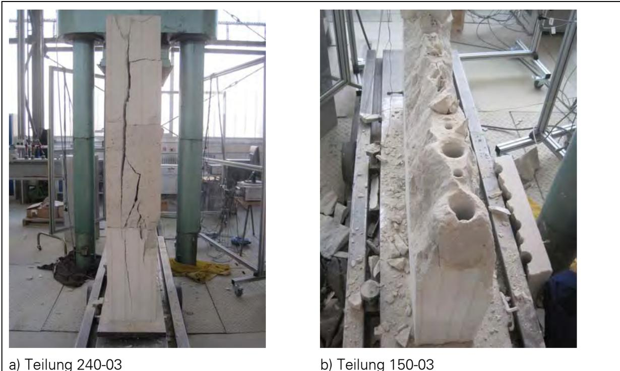
*Bild 190 Längsteilung infolge Inhomogenität im Querschnitt*
