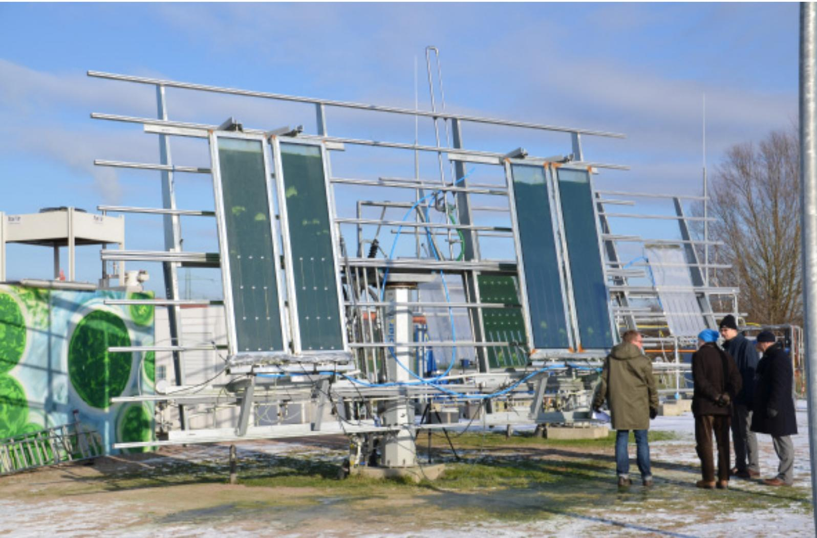
Testaufbau für die Prototypen des Photobioreaktors
