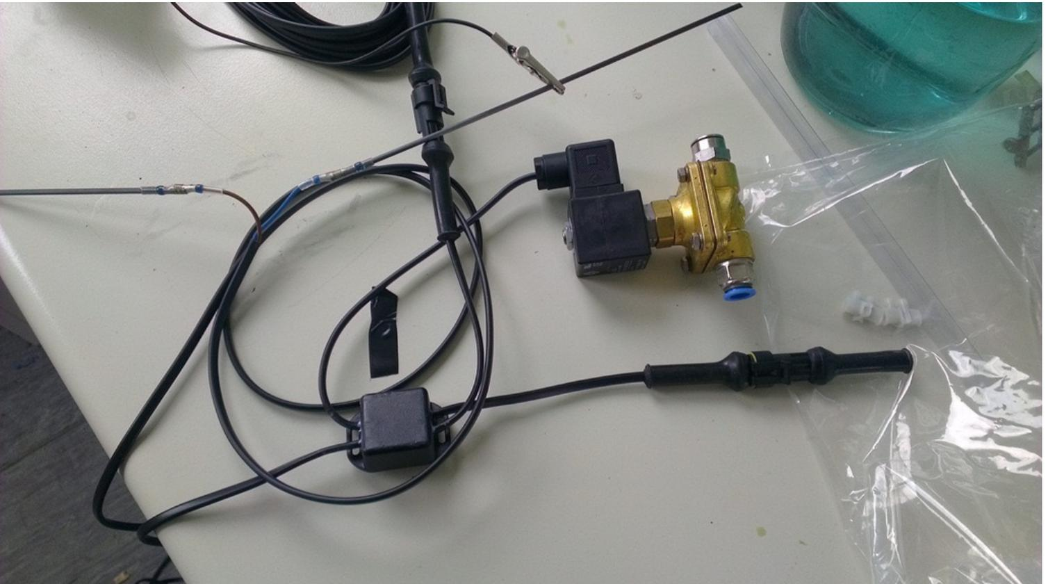
Abbildung 44 Foto eines neu entwickelten elektronischen Bauteils basierend auf einer Mosfet-Schaltung, mit dem über stabförmige Fühler ein Anstieg des Kulturmediums im PBR erfasst und dann der Zulauf über ein Magnetventil abgesperrt wird. © SSC GmbH
