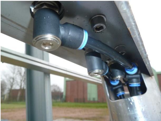
Abbildung 36 zeigt die Anschlussmimik und Durchführung durch den mittigen Hohlzapfen an der Unterseite des PBR im Auflager
