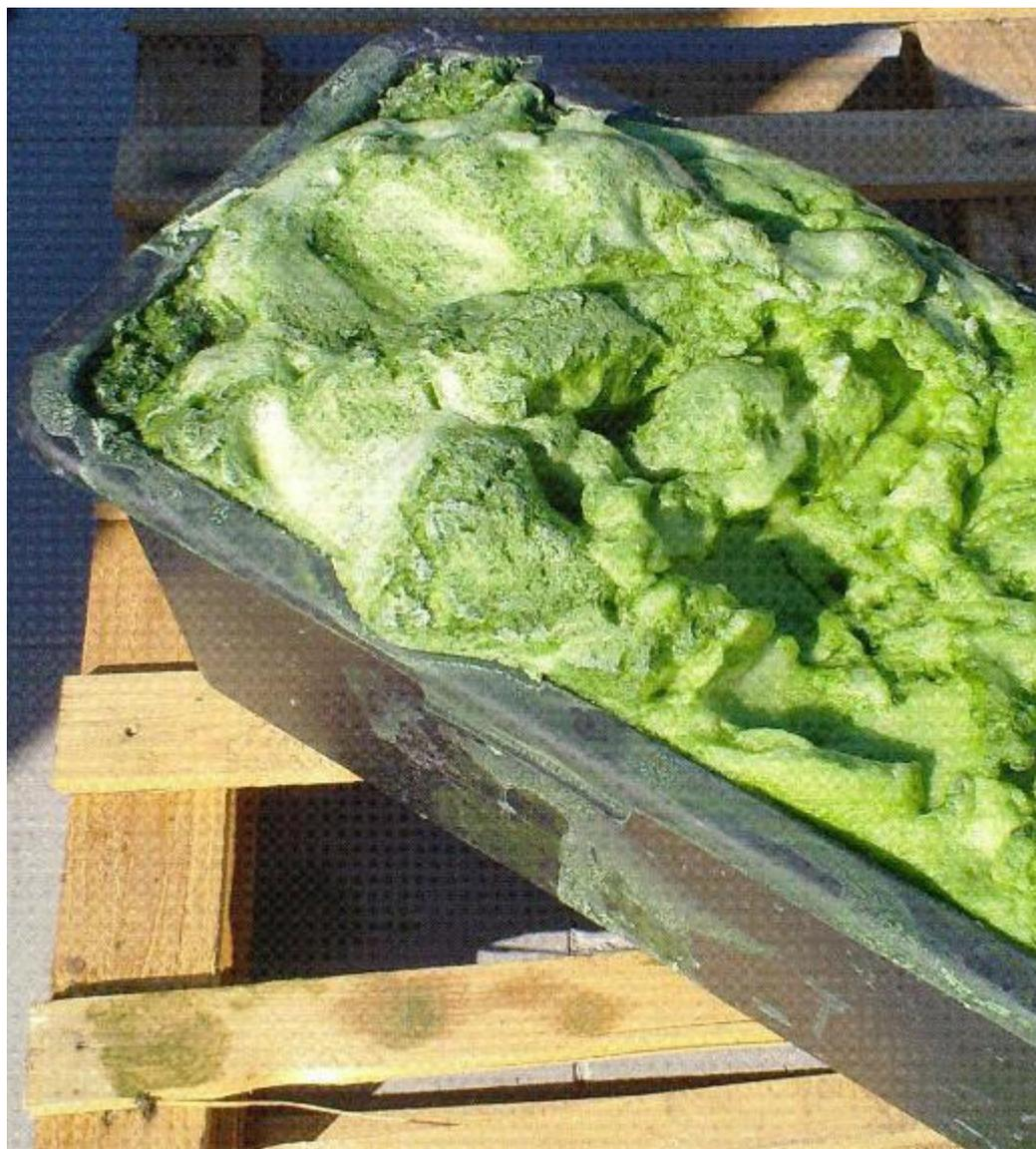
Abbildung 43 Abtrennung/Ernte der Mikroalgen Biomasse über Flotation als dicker Schaum.
