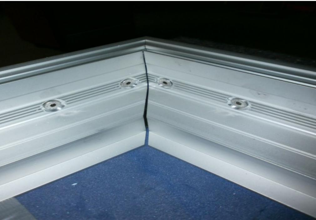
Abbildung 34 zeigt den vorderen Rahmenteil: Schubsteife Ecke mit Verschraubung zum Eckverbinder
