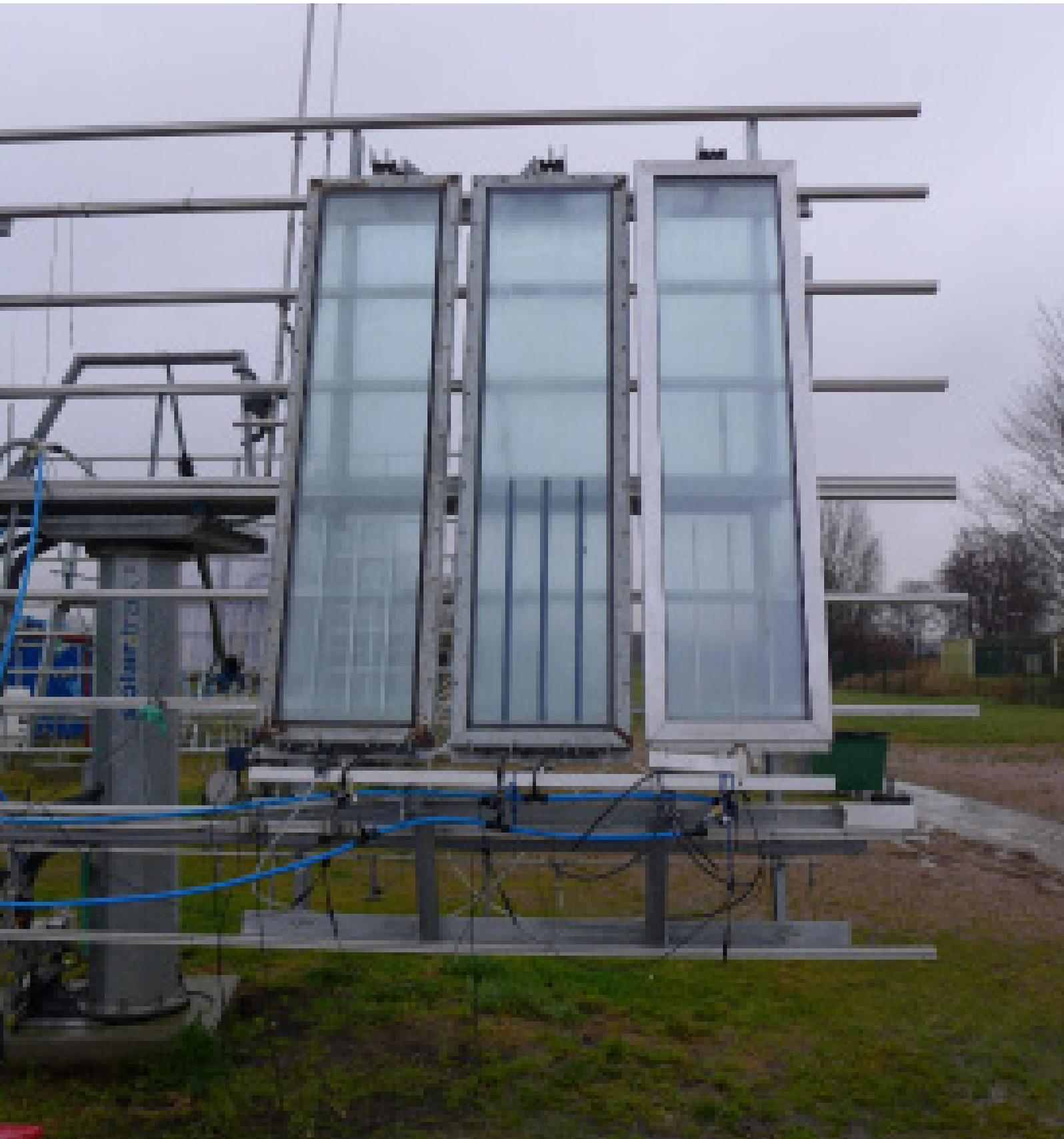
Testaufbau für den Prototypen des Photobioreaktors
