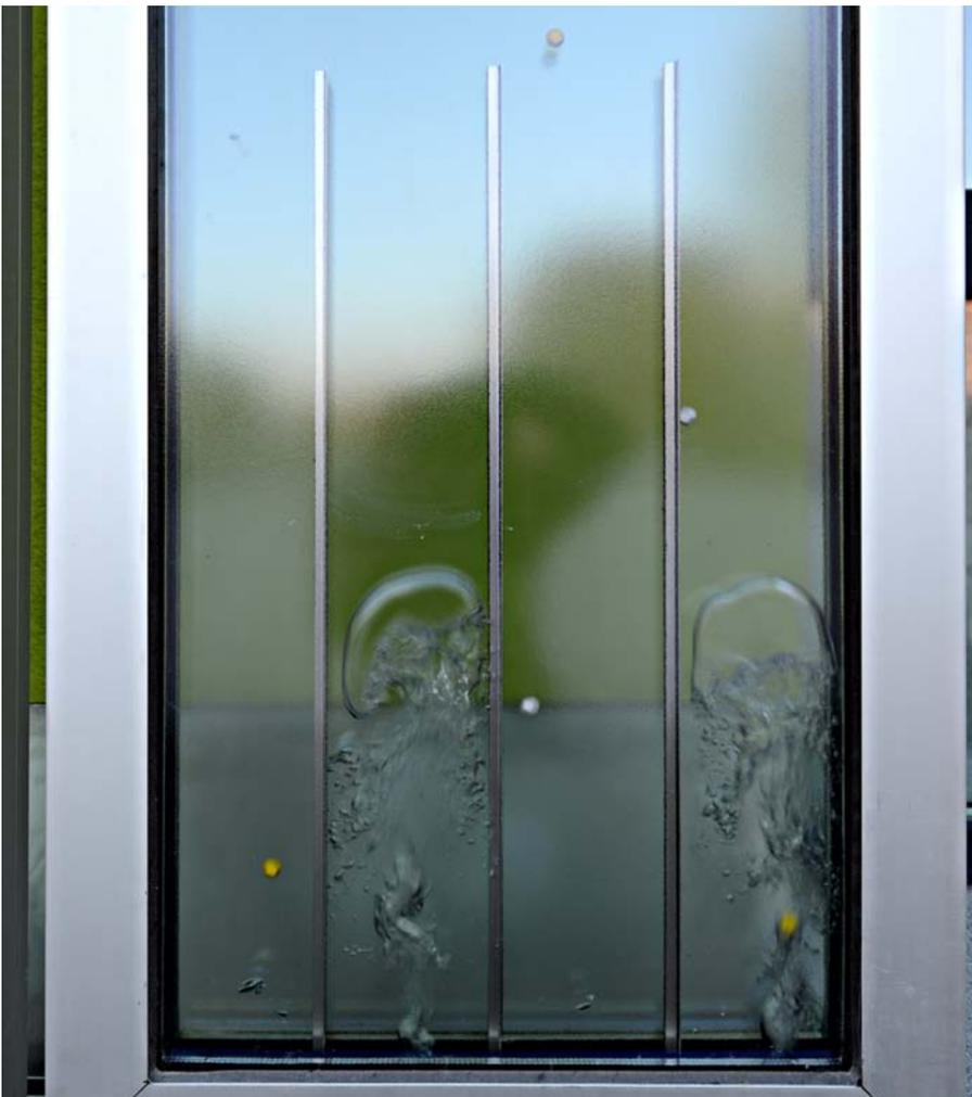
Abbildung 30 zeigt die AirLift Antriebseinheit am unteren Ende des PBR. Aluminium L-Profile als vertikale Stege zur Kanaltrennung auf der hinteren PBR-Wandung.
