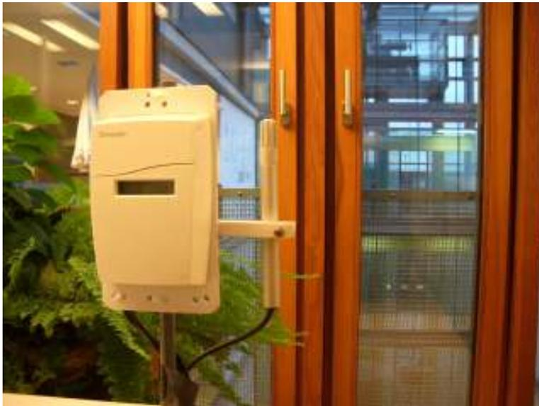
**Abbildung 24** Sensoren für CO<sub>2</sub> und Lufttemperatur und relative Luftfeuchte
