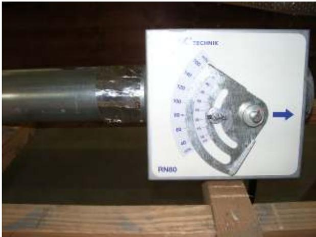
**Abbildung 33** Volumenstromregler im Laborversuch
