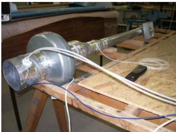
**Abbildung 32** Messeinrichtung der Volumenstromregler, im Vordergrund das Gebläse, durch den blauen Schlauch erfolgt die Tracergasinjektion
