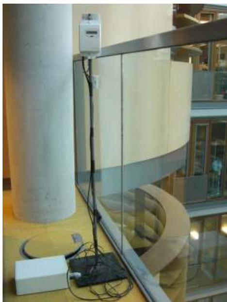
Abbildung 23 CO<sub>2</sub>-Sensor mit Aufzeichnungsgerät in der Kombizone/Atrium
