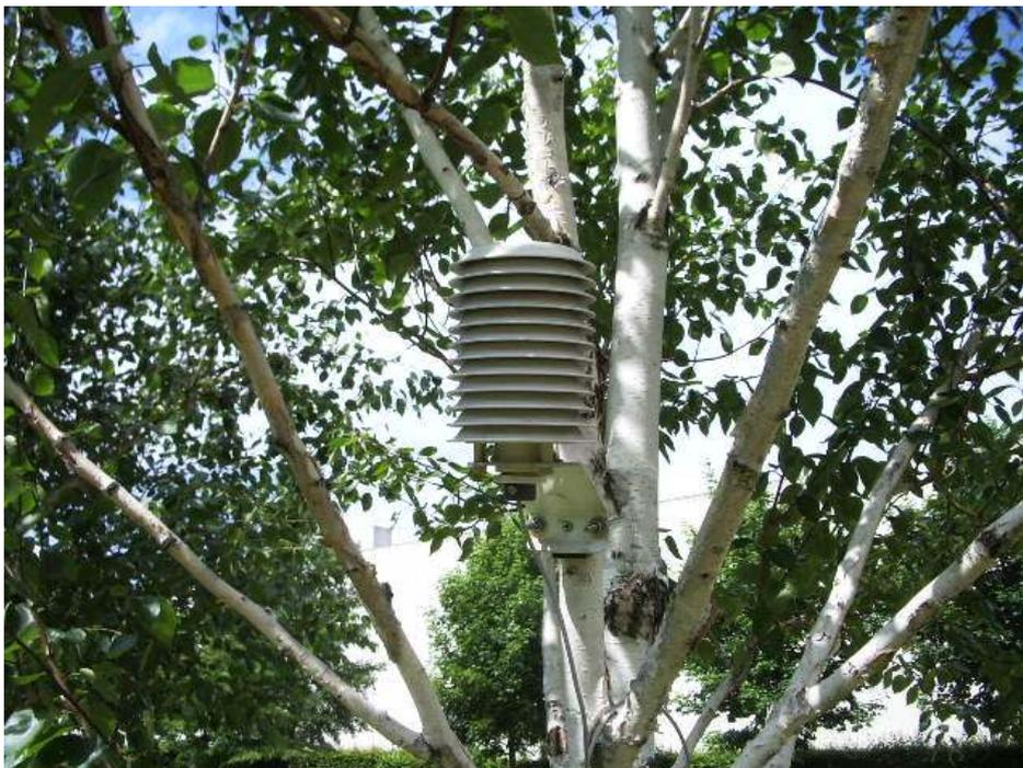
**Abbildung 35** Außentemperatursensor des IGS
