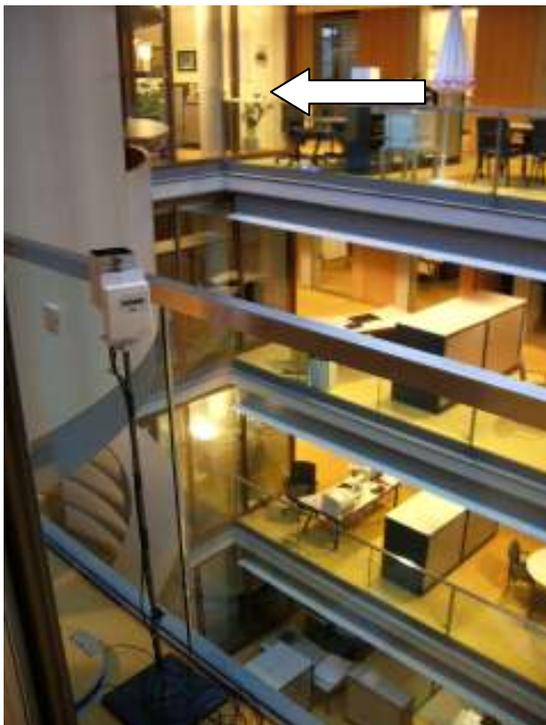
**Abbildung 25** Im Vordergrund Messsensor in der Kombizone und im Hintergrund der untersuchte Büroraum (Pfeil)
