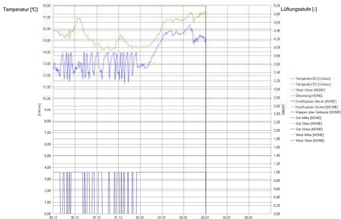
**Abbildung 49** Zu Pos.3: Statt West\_unten öffnet ab 12°C die Gruppe „Klappen über Gebäude“. Die Kaltluft fällt offensichtlich im Bereich des Temperatursensor ab, so dass die Regelung schwingt
