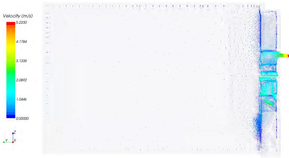
**Abbildung 5.13:** Strömungsverlauf und Luftgeschwindigkeit im dezentralen Lüftungsgerät und im Raum – mechanische Lüftung, Winter; 90 m<sup>3</sup>/h.
