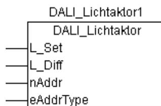
**Abbildung 3.12:** Funktionsblock für „Dali Lichtaktor“.
