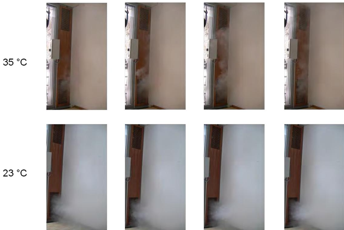
**Abbildung 5.10:** Einströmung der Zuluft bei mechanischer Lüftung und unterschiedlicher Zulufttemperatur im Rauchversuch.
