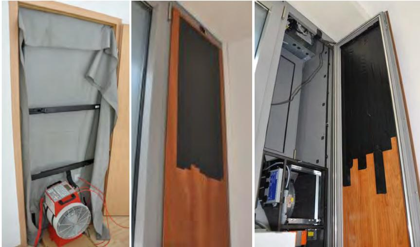
**Abbildung 5.8:** Testraum während der Luftdurchlässigkeitsmessungen: im Türrahmen eingebautes Prüfgerät (links), Holzpaneel des dezentralen Lüftungsgerätes geschlossen und abgeklebt (Mitte), Holzpaneel geöffnet (rechts).
