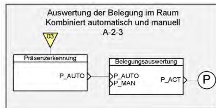
**Abbildung 4.30:** Funktionsmakro A-2-3 nach VDI 3813-3 (Entwurf) (9).
