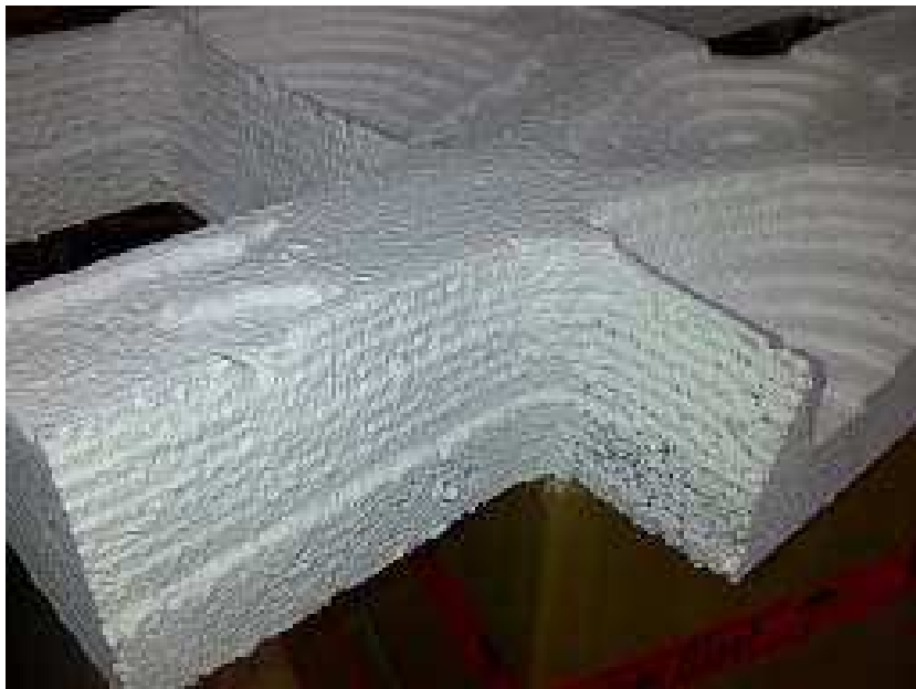
Abbildung 75: Verarbeitungsversuch Schichtmodell mit Spritzputz, Seitenansicht
