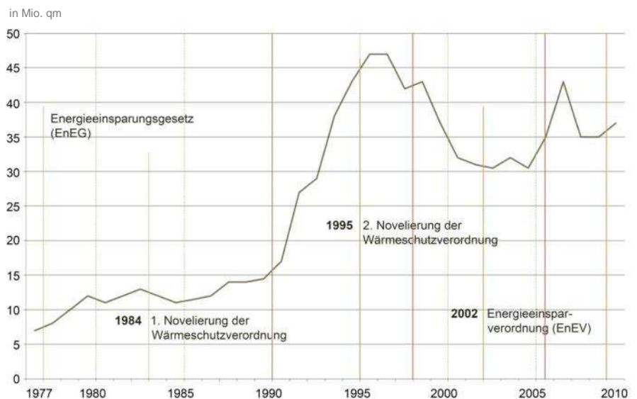
Abbildung 3: WDVS - Marktentwicklung unter technischem und politischen Einfluss, Quelle: Riedel, Oberhaus, Frössel, Haegele Wärmedämm-Verbundsystem 2010, Seite 396
