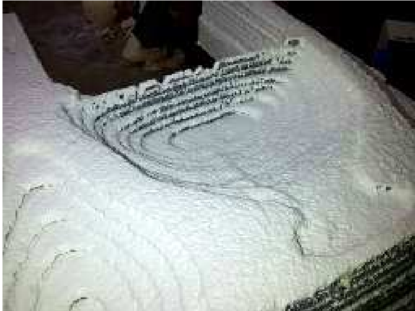
Abbildung 74: Verarbeitungsversuch Schichtmodell mit Spritzputz, schräge Draufsicht
