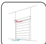
Tore weisen wie jedes mehrteilige Bauobjekt Fugen (Leckagen) auf, durch welche Luft ein- und ausdringen kann. Je nach Tortyp können diese Leckagen variieren. Aus diesem Grund wird die
