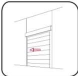
Für die Berechnung der Transmissionswärmeverluste ist der Wärmedurchgangskoeffizient (U-Wert) des Tores relevant. Dieser wird für Tore nach [DIN EN 12428] bestimmt und liegt derzeit in
