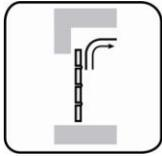
Der Tortyp, der im Industriebau am häufigsten eingesetzt wird, ist das Sektionaltor [B+L 2010, 61]. Es besteht aus einer Anzahl von horizontal miteinander verbundenen Sektionen, die den Torflügel ergeben. Das Tor wird in der Regel beim Öffnen vertikal angehoben, die Ablage des Flügels in der oberen Öffnungsposition kann waagrecht, senkrecht oder gefaltet erfolgen [ASR A1.7, 6].
