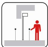
Die Totmannsteuerung ist eine Steuerung ohne Selbsthaltung, es erfordert eine kontinuierliche Betätigung für den Öffnungs- und Schließvorgang und erfolgt mittels Taster.
