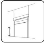
In diesem Kapitel wird die Verringerung des Lüftungswärmeverlusts durch eine objektgrößenangepasste Toröffnung untersucht. Mittels sensorischer Systeme wie Laser-Scanner kann das Objekt (z.B. Person, KFZ, Stapler) in dessen Höhe erfasst und das Tor entsprechend auf die erforderliche Höhe geöffnet werden, siehe Kapitel 3.3.
