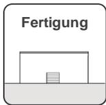
In Abbildung 15 ist das Gebäudemodell *Fertigung* dargestellt. Ersichtlich wird im Schnitt die gewählte Zonierung in horizontaler Ebene. Aufgrund der großen Anzahl an Simulationen wird zur Reduzierung der Rechenzeit ein 4-Zonen-Gebäudemodell erstellt. Für die Untersuchung des sich einstellenden Raumtemperaturabfalls bei einem offenstehenden Tor in Kapitel 6.4 wird eine feinere Zonierung vorgenommen, da hier der Simulationszeitraum lediglich eine Toröffnung beträgt.
