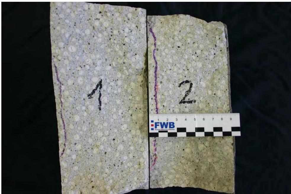
Abbildung 8: Wassereindringtiefe an repräsentativen Probekörpern aus Architekturleichtbeton bei einem Wasserdruck von 100 kPa
