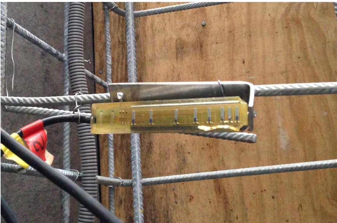
Abbildung 23: Temperatursensor befestigt an der verzinkten Bewehrung
