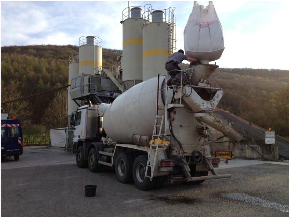
Abbildung 17: „Bigbag“-Befüllung eines Transportbetonfahrzeugs mit Blähglas
