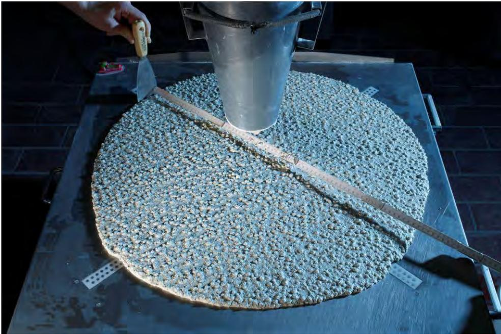
Abbildung 3: Setzfließmaß der optimierten Architekturleichtbetonrezeptur
