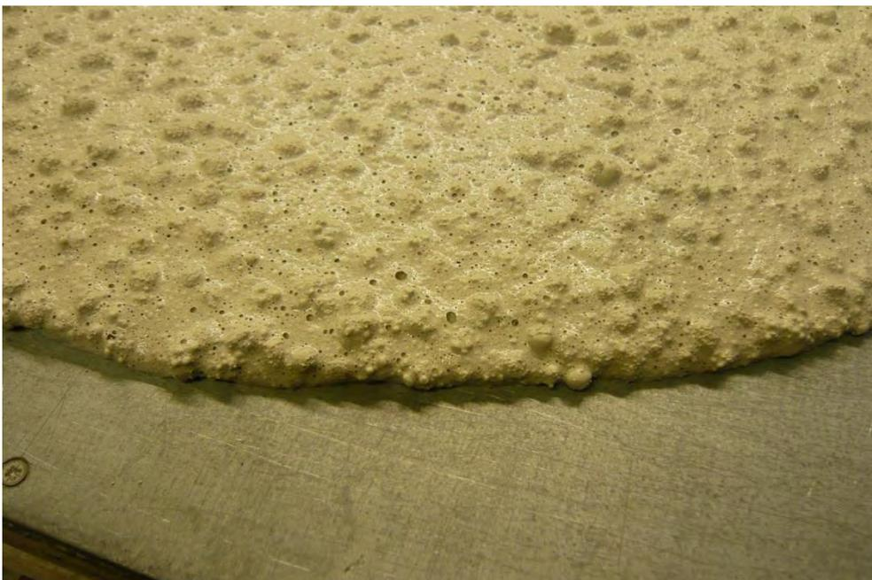
Abbildung 4: Randbereich des Architekturleichtbetons beim Ermitteln des Setzfließmaßes
