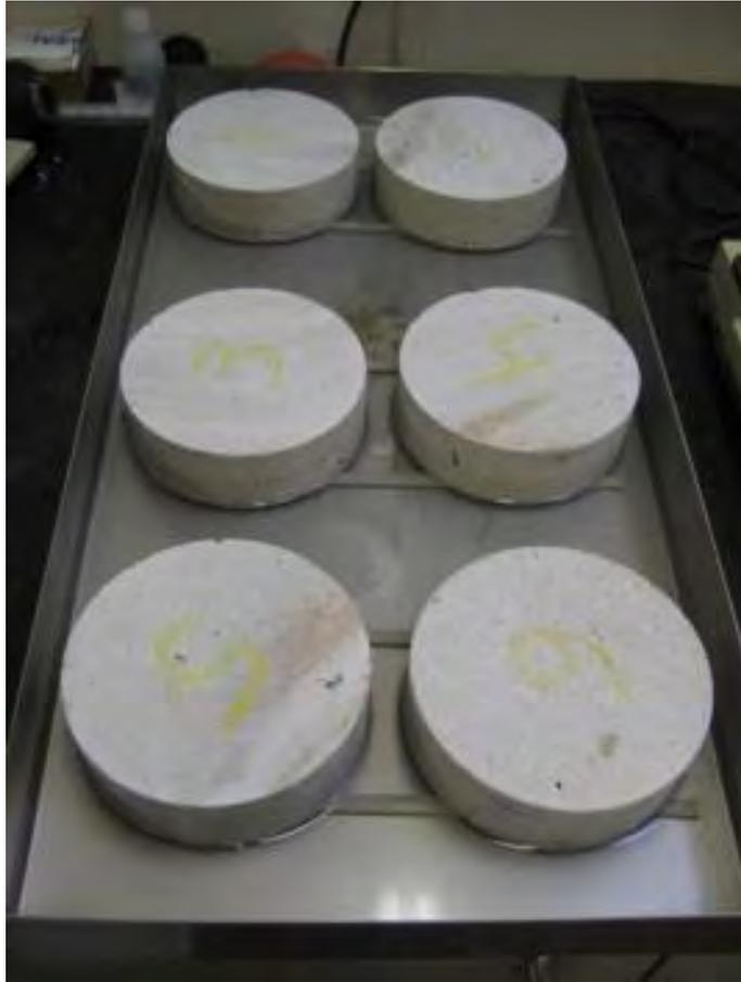
Abbildung 6: Testreihe zur kapillaren Wasseraufnahme des Architekturleichtbetons
