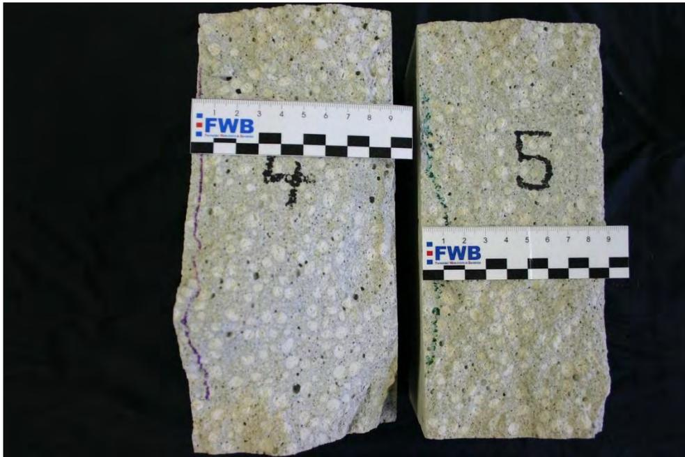
Abbildung 9: Wassereindringtiefe an repräsentativen Probekörpern aus Architekturleichtbeton bei einem Wasserdruck von 100 kPa
