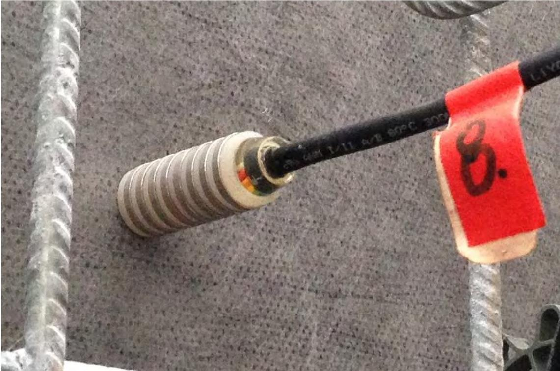
Abbildung 22: Multiringelektrode zur Feuchtebestimmung, befestigt an der Schalung
