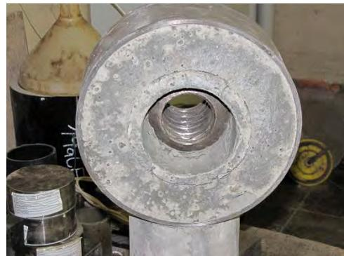
Abbildung 3.87: Versagen Unterseite Versuch 1.24
