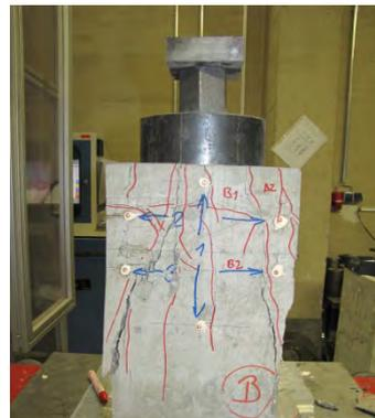
**Abbildung 3.96: Spaltzugversagen bei Versuch 2.2**
