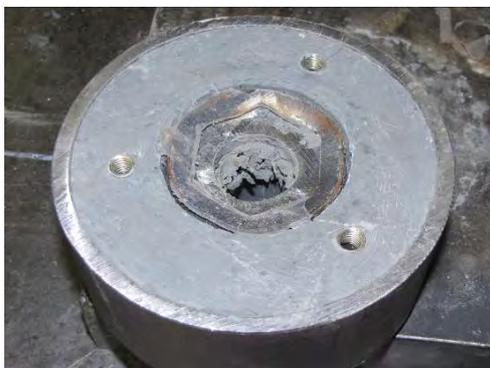
**Abbildung 3.88: Versagen Oberseite Versuch 1.17**
