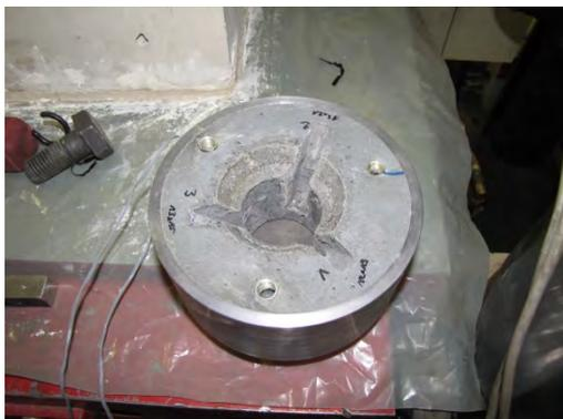
Abbildung A.146: Oberseite Versuchskörper 2.9 nach Versuchsende
