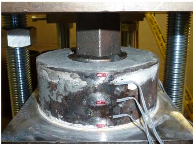
Abbildung A.167: Oberseite Versuchskörper 4.3 nach Versuchsende
