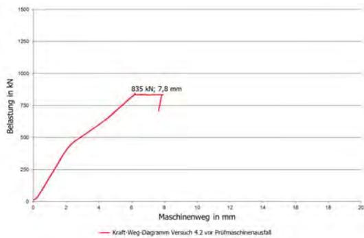
**Abbildung A.158: Kraft-Weg-Diagramm vor Prüfmaschinenausfall Versuch 4.2**
