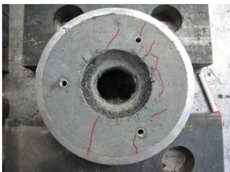
Abbildung A.58: Oberseite Versuchskörper 1.20 nach Versuchsende
