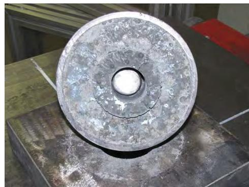
**Abbildung 3.89: Versagen Unterseite Versuch 1.17**
