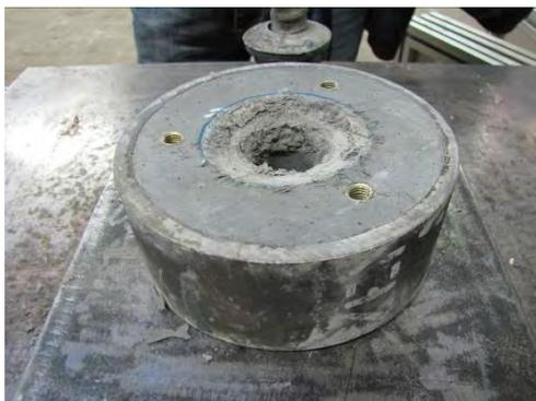
**Abbildung 3.90: Versagen Oberseite Versuch 1.15**
