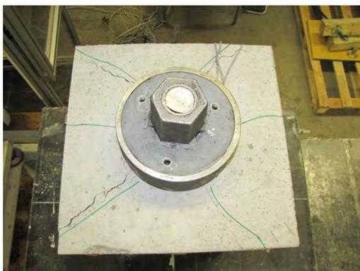
Abbildung 3.43: Oberseite Betonkörper 2.1 nach Versuchsende
