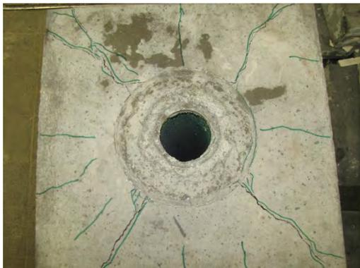
Abbildung A.120: Oberseite Betonkörper 2.5 nach Versuchsende
