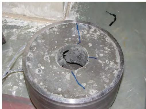
Abbildung A.147: Unterseite Versuchskörper 2.9 nach 10. Oberlast
