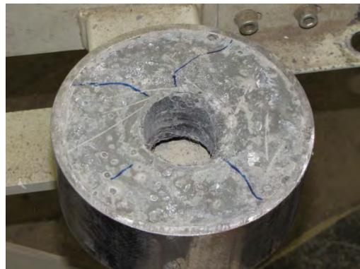
Abbildung A.40: Unterseite Versuchskörper 1.14 nach Versuchsende
