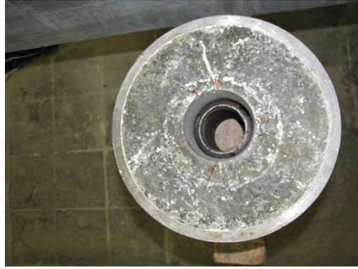
**Abbildung 3.98: Unterseite Hybridanker nach Versuch 2.8**
