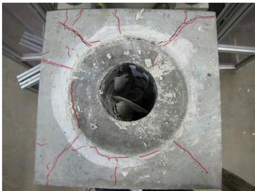
Abbildung A.142: Oberseite Betonkörper 2.8 nach Versuchsende
