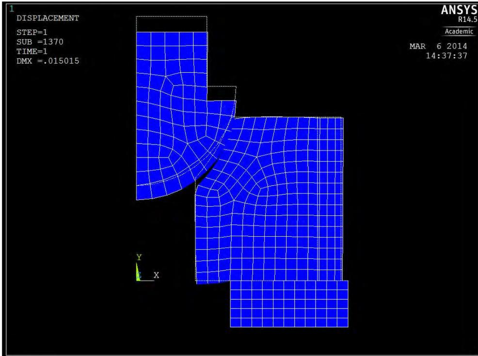
Abbildung B.14: Verschiebungsfigur des Hybridankers mit  $h = 70$  mm und Ringdicke = 10 mm
