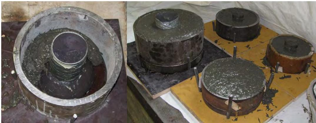
Abbildung 3.5: Hybridankerplatten für Stabzugglieder mit Kugelbundmutter während und nach dem Betoniervorgang
