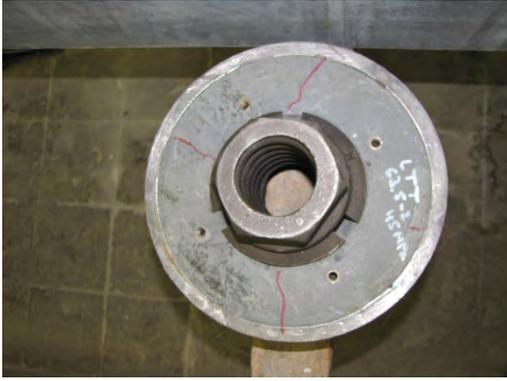
**Abbildung 3.97: Oberseite Hybridanker nach Versuch 2.8**
