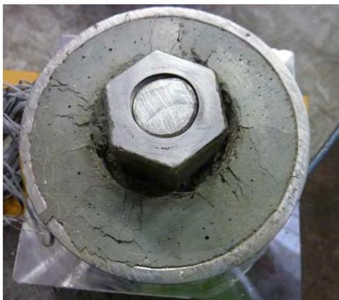
Abbildung A.2: Oberseite Versuchskörper 1.2 nach Versuchsende
