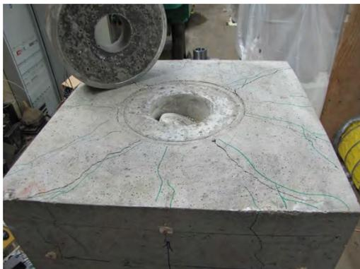
Abbildung A.135: Oberseite Betonkörper 2.7 nach Versuchsende
