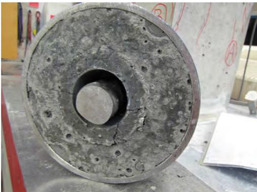
**Abbildung 3.95: Unterseite Hybridanker nach Ende Versuch 2.3**
