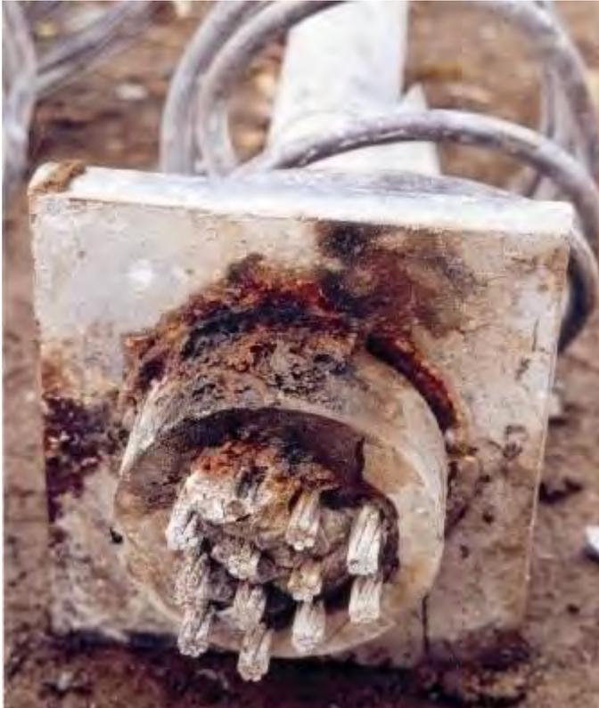
**Abbildung 1.2: Korrosion des Spannankerkopfs, [106]**
