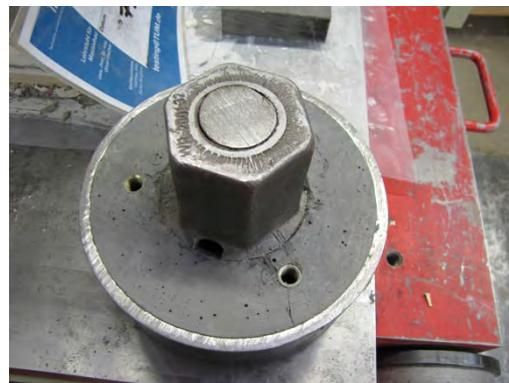
**Abbildung 3.94: Oberseite Hybridanker nach Ende Versuch 2.3**
