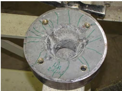
Abbildung A.36: Oberseite Versuchskörper 1.13 nach Versuchsende
