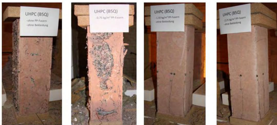
**Abbildung C.33: Brandversuche zur Abplatzungsproblematik der B5Q Mischung unter der Einheitstemperaturkurve an Prismen 20/20/60 cm mit unterschiedlichem PP-Fasergehalt aus [46]**
