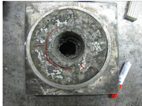
Abbildung 3.83: Versagen Unterseite Versuch 1.8
