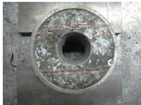
Abbildung A.22: Unterseite Versuchskörper 1.8 nach Versuchsende
