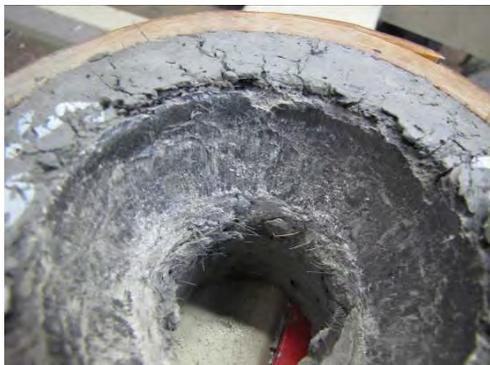
Abbildung 3.86: Versagen Oberseite Versuch 1.18
