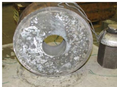
Abbildung A.117: Unterseite Versuchskörper 2.5 nach Versuchsende
