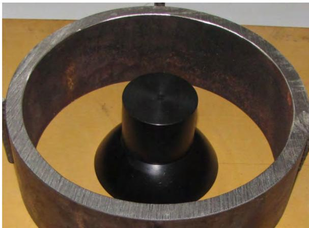
Abbildung 6.1: Formteil und Stahlring als Schalungselemente
