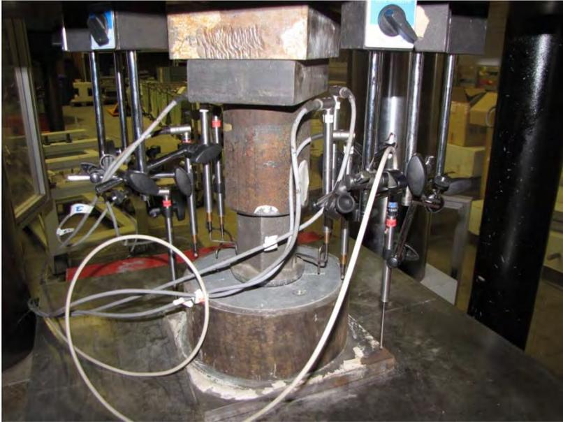
Abbildung 3.16: Anordnung der Wegaufnehmer für die Verformungsmessung am Beispiel von Versuch 1.19
