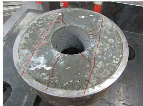
Abbildung 3.85: Versagen Unterseite Versuch 1.20
