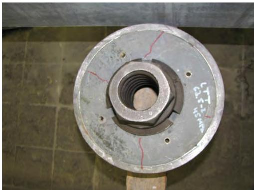
Abbildung A.138: Oberseite Versuchskörper 2.8 nach Versuchsende
