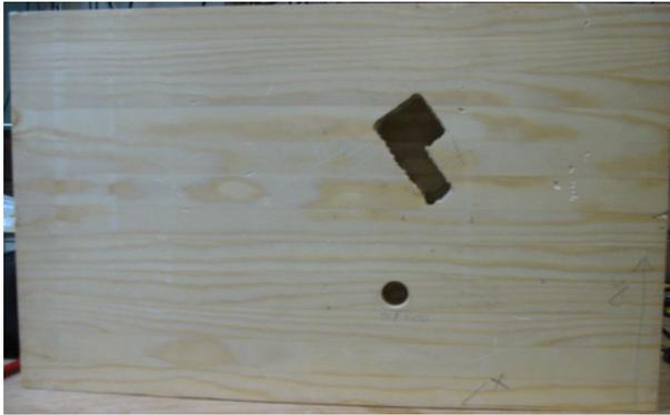
**Bild 40** Kieferholzprobekörper x1124 mit eingefügten Fehlstellen auf der Rückseite
