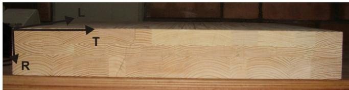
**Bild 32** Kiefernholz-Probekörper (Kiefer\_Pk1)
