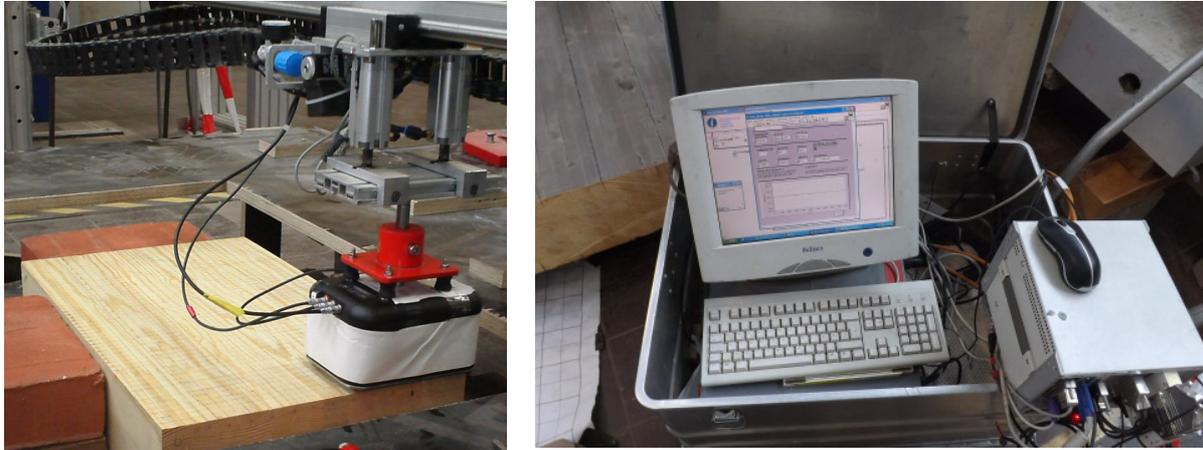
**Bild 5** Das scannende System mit einem Transversalwellen-Prüfkopf. Rechts: PXI-System zur Steuerung der Scaneinheit
