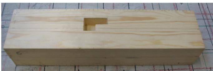
**Bild 50** Kiefernholz -Probekörper mit L-förmiger Fehlstelle (K219.7)
