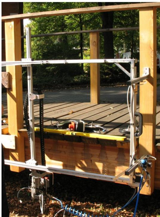
**Bild 98** Montage des Baustellenscanners an der Fußgängerbrücke
