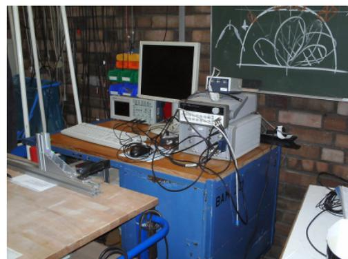
**Bild 4** Laufzeitapparatur 2 für die Messung mit Einzelprüfköpfen
