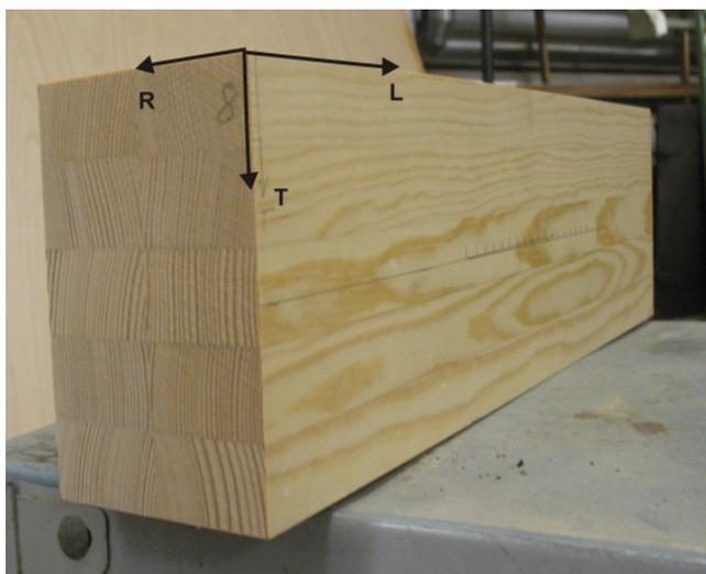
**Bild 33** Kiefernholz-Probekörper (Kiefer Serie 2, K219.1-.8)
