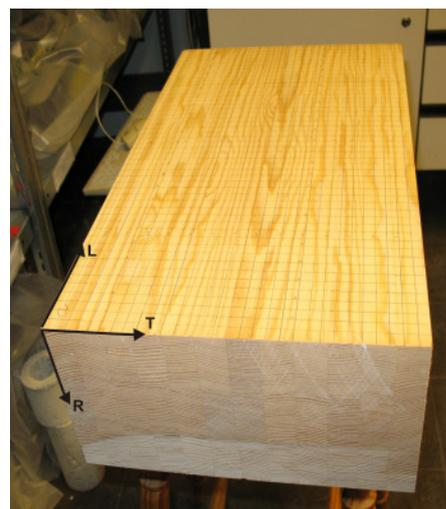
**Bild 34** Großer Kiefernholz-Probekörper (x1124)
