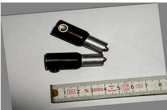
**Bild 3** Einzelne Prüfköpfe für Longitudinalwellen bzw. Transversalwellen
