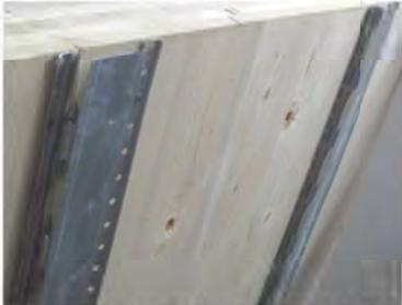
**Bild A.3:** Massivholzschale des Prüfkörpers IWT 2 bzw. TW 2, Montagezustand vor dem Anbringen der Gipskartonbeplankungen
