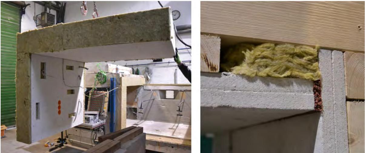
Abbildung 3-8 Versuchskörper Brandversuch V1 Gesamtansicht und Fugendetail
