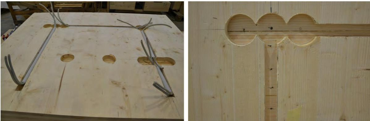
Abbildung 3-20 Wandelement des Versuchskörpers V3 mit Elektroinstallationen
