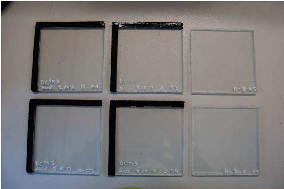
Bild 19 Probekörper A vor Einlagerung
