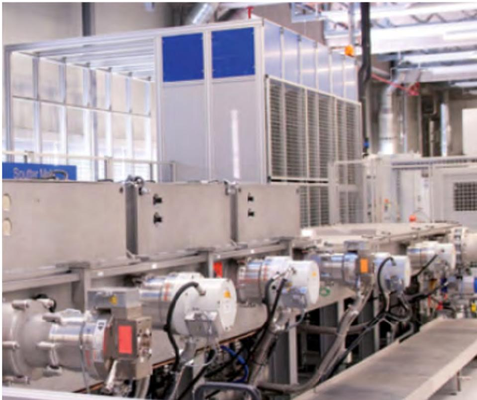
Bild 5 Rückkontaktkontaktierung, Sputtern von Molybdän (Mo), © Manz CIGS Technology GmbH
