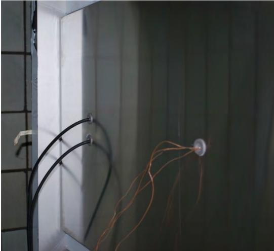
Bild 41 Kabeltülle für Thermoelemente an Paneelrückseite
