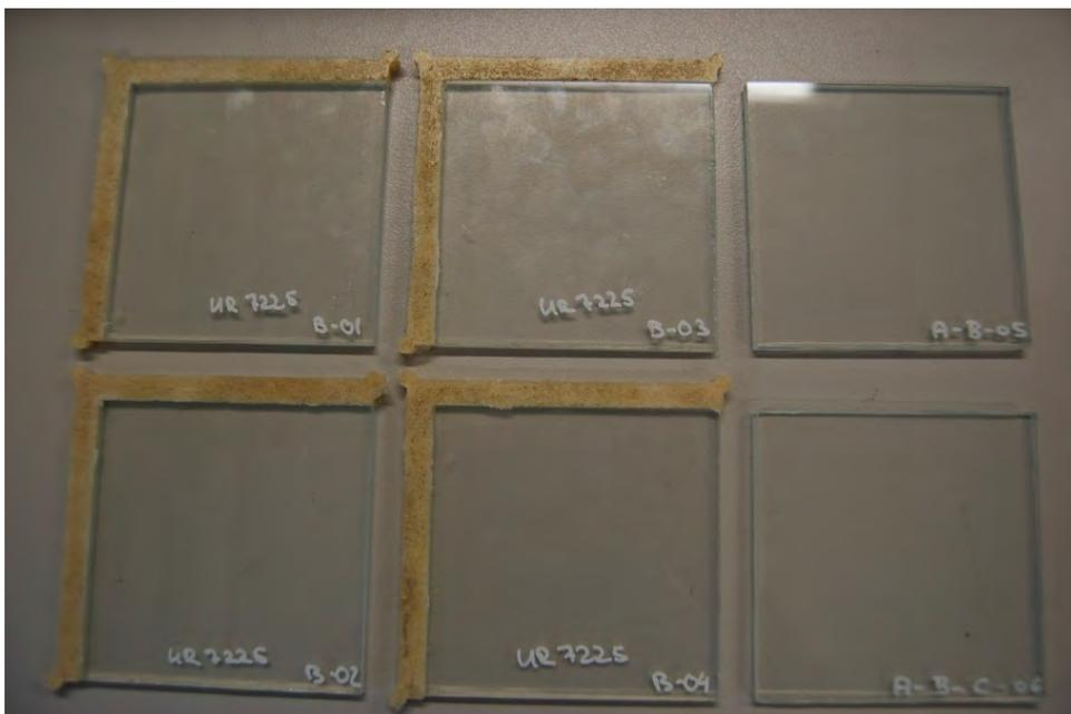
Bild 20 Probekörper B vor Einlagerung
