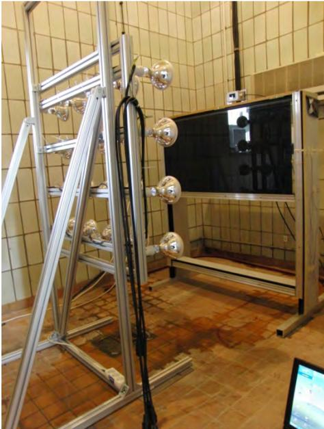
Bild 32 Bestrahlungseinheit und Prüfstand mit PV-Modul PV-S-1
